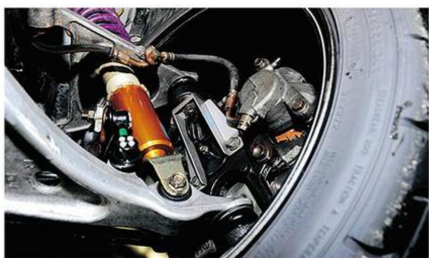
ナックルサポート(右)やピロパーツは、スポーツ走行していくなかで強度不足や、気になる動きを抑制したいときにプラスしていくようにする。一度にセットすると、何がどの動きに影響していたか見極めにくいからだ。
