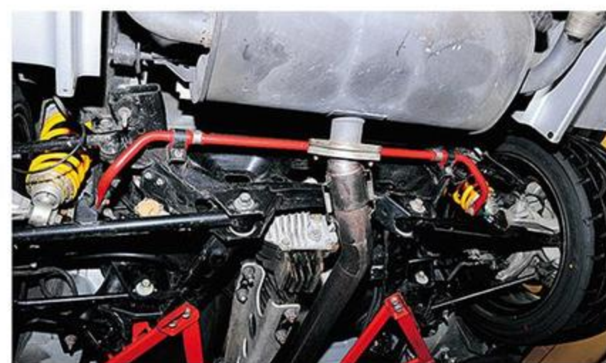
これはアフター製スタビライザーをセットアップしたもの。サーキットを走るならこれくらい強度アップしたほうがいいかも。
