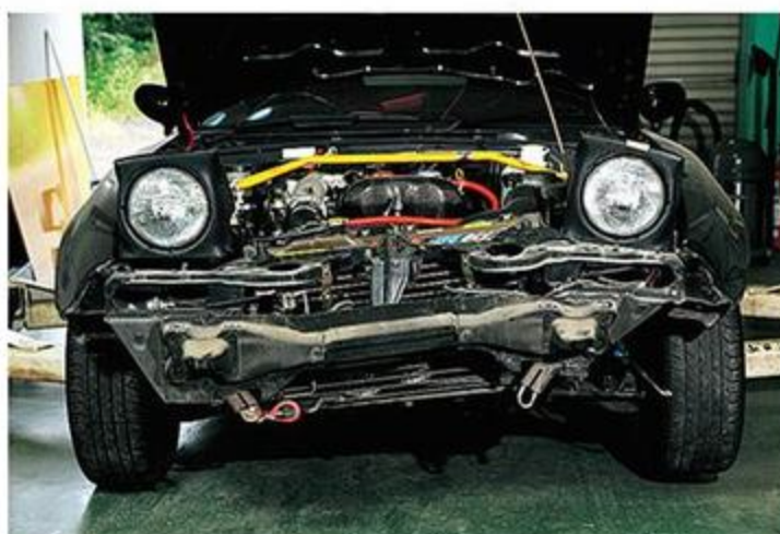
ここまでひどい状態になると、フレーム修正が必要になってくる。廃車にするか乗り続けるか……悩むユーザーは多い。
