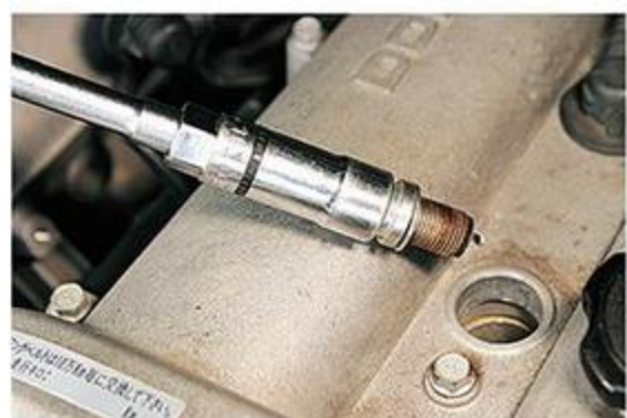
コンプレッションテスターを備えているショップは多い。愛車チェックメニューに取り入れているところもある。定期的に計測してデータを蓄積しておけば、エンジンコンディションが管理できる。
