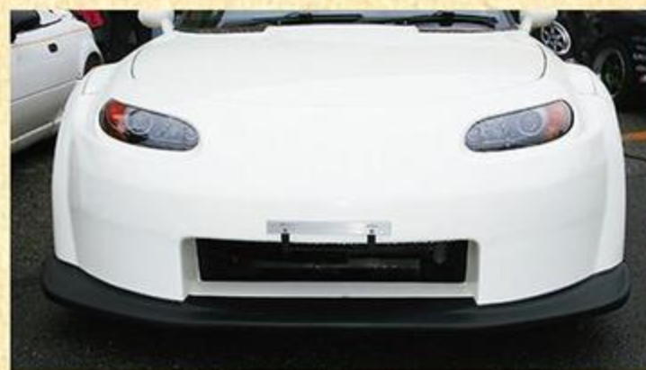
余計なダクトを一切排除し、冷却に必要な最低限の開口部だけにすることで、空気抵抗の軽減をねらったデザインを採用した。
