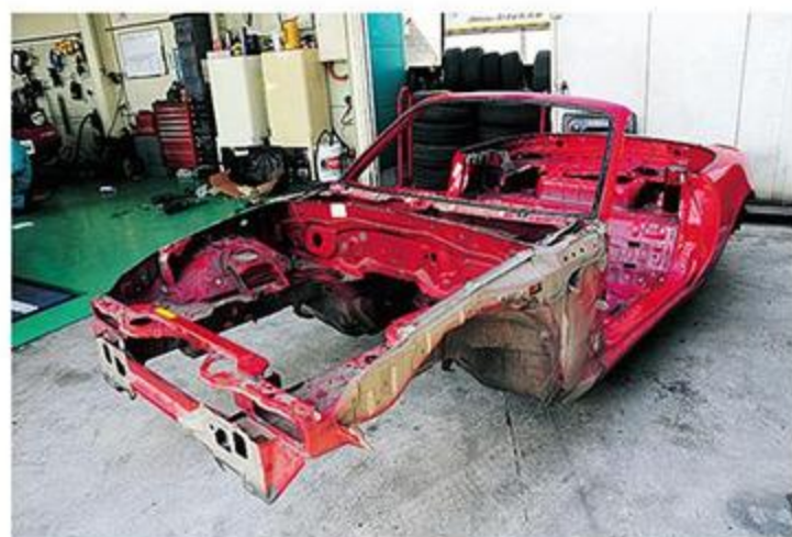
ボディの状態によっては「ニコイチ」にすることも。ロードスターの大きがりなフレッシュでは、じつはよく用いられる方法なのだ。
