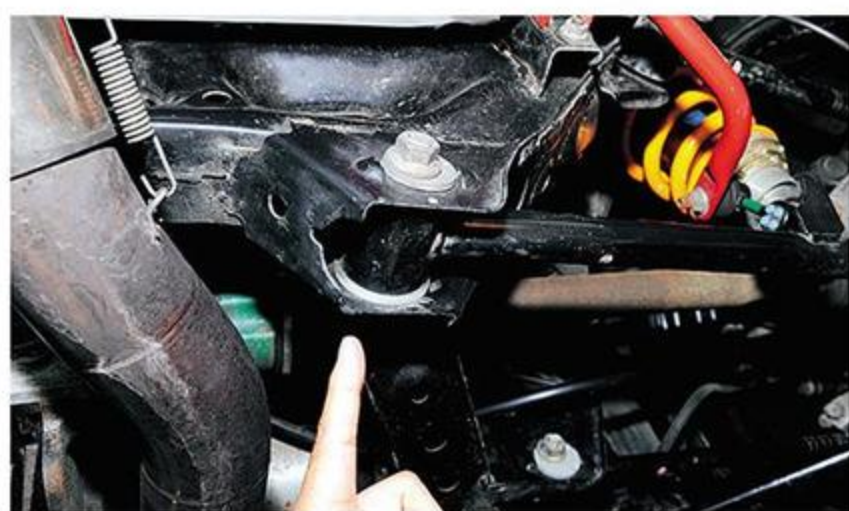
ナックルサポート(右)やピロパーツは、スポーツ走行していくなかで強度不足や、気になる動きを抑制したいときにプラスしていくようにする。一度にセットすると、何がどの動きに影響していたか見極めにくいからだ。
