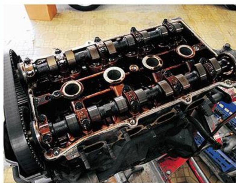
エンジン内に水が入り込んでオイルと混ざるといふ最悪のブロー状態。こうなるとピストンも使えないため、オーバーホールするにもコストがかかってしまう。こんなことになる前に異変に気づきたいところ。
