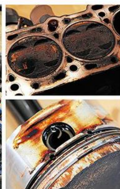
エンジン内に水が入り込んでオイルと混ざるといふ最悪のブロー状態。こうなるとピストンも使えないため、オーバーホールするにもコストがかかってしまう。こんなことになる前に異変に気づきたいところ。
