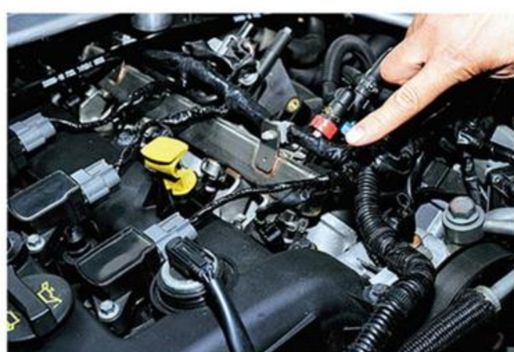
NC1初期型に見られたというプラグコード内の被覆内断線。構造上の問題のようだ。吹けが悪いと思ったら疑ってみてもいいかも。
