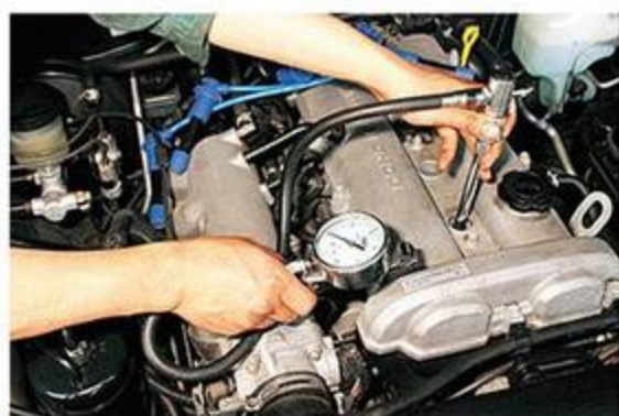
コンプレッションテスターを備えているショップは多い。愛車チェックメニューに取り入れているところもある。定期的に計測してデータを蓄積しておけば、エンジンコンディションが管理できる。
