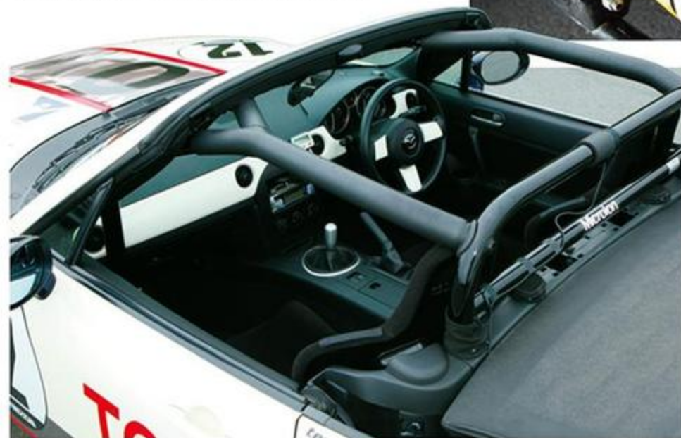
ロールケージの装着方法もTCR独自のやり方がある。単純に装着するのと違い、効果的に剛性を高めることができるようになるという。
