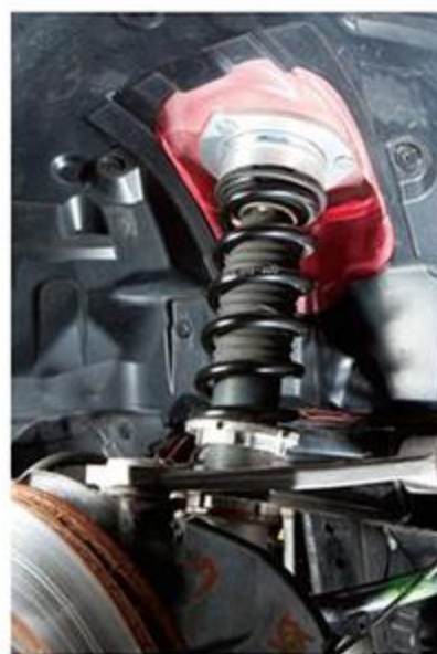
フロント7kg/mm、リア4kg/mmの比較的低レートで仕上げる「ヒルクライムダンパーRS」。スプリング作動音を軽減するスラストワッシャーの採用など、快適性にも考慮した。
