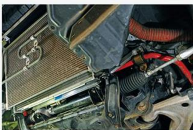
センターアンダークロスバーとリアクロスバーの組み合わせが、オススメ(写真上)。フロントステアリングリンク(右)とリアクロスメンバーエンドバー(左)と4点から構成されている。
