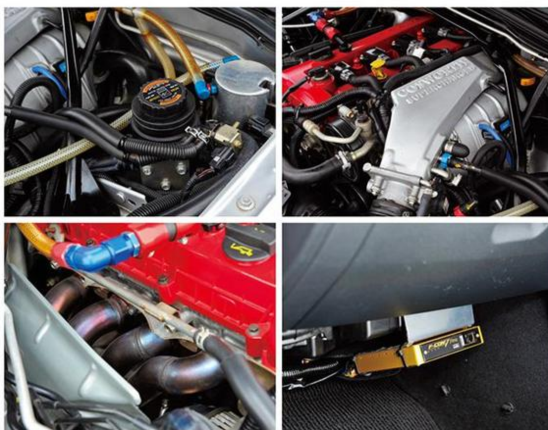
ノーマルエンジンにポン付けできるコスワースのスーパーチャージャーキット。ブーストは0.5kg/cm 2 と高めだが、街乗りなら0.2~0.3kg/cm 2 くらいで十分だ。
