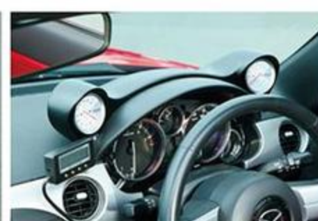
メーターパネルキットは視認性を向上させるメーターナセル上にセット。メーターはピボット製の油温と水温計を装着している。
