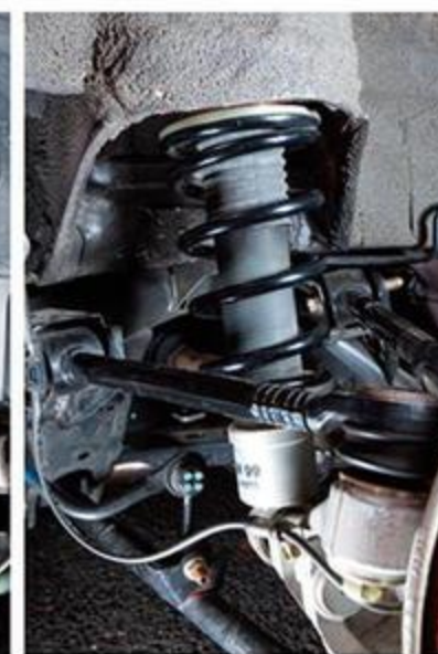
フロント7kg/mm、リア4kg/mmの比較的低レートで仕上げる「ヒルクライムダンパーRS」。スプリング作動音を軽減するスラストワッシャーの採用など、快適性にも考慮した。
