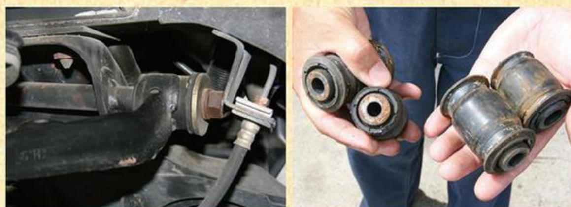
走行距離も進み、劣化も進んでいるブッシュ類は交換することでハンドリングがよみがり、乗り心地などにも変化を与える。リフレッシュしたいのなら相談しよう。
