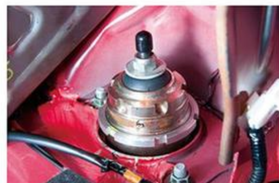
走行ステージに応じて減衰力を調整するだけで、乗り味は大きく変わる。初期からシッカリと立ち上げて粘りを持たせたセットだ。
