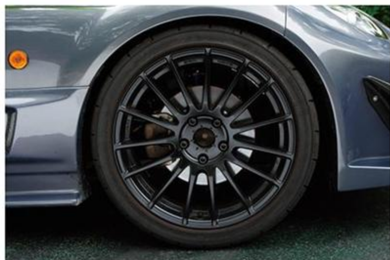
ストリートではルックス重視で18インチをマッチングさせるが、サーキットでは17インチの245もしくは255サイズに変更する。
