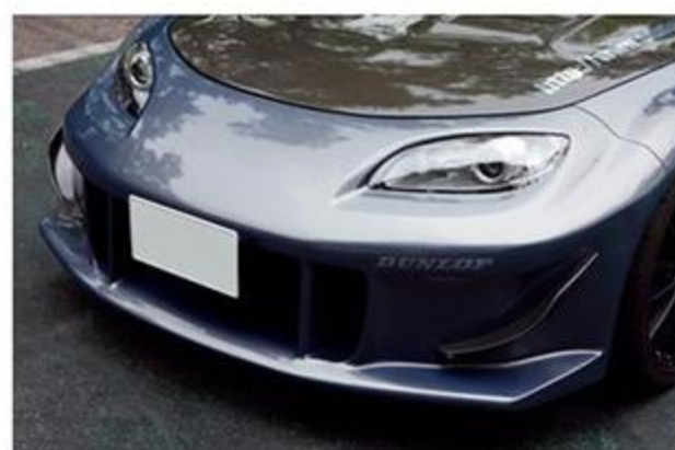
ダウンフォースはもちろん、クーリング効果も期待できるフロントバンパースポイラー。カナードをセットすればレーシーフェイス。
