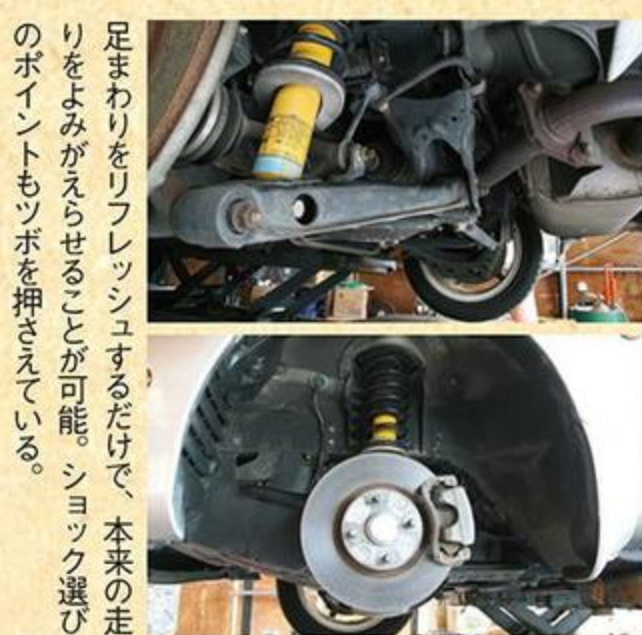
走行距離も進み、劣化も進んでいるブッシュ類は交換することでハンドリングがよみがり、乗り心地などにも変化を与える。リフレッシュしたいのなら相談しよう。
