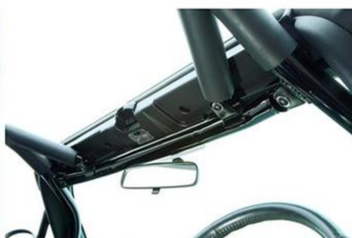
ロールケージの装着方法もTCR独自のやり方がある。単純に装着するのと違い、効果的に剛性を高めることができるようになるという。
