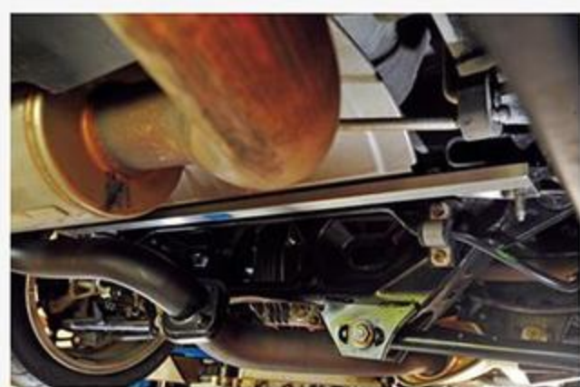
センターアンダークロスバーとリアクロスバーの組み合わせが、オススメ(写真上)。フロントステアリングリンク(右)とリアクロスメンバーエンドバー(左)と4点から構成されている。
