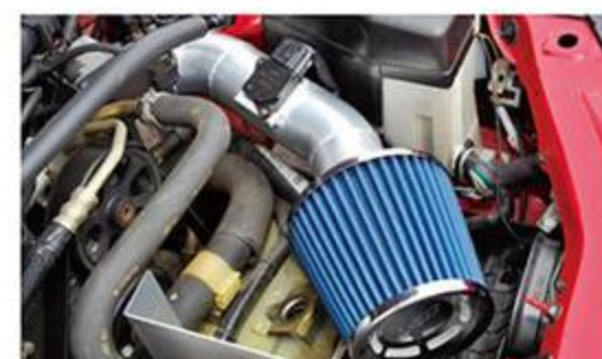
急いで取り付けたいというエアインクス。パイピングもワンオフ。熱対策をまったく講じていないので、遮熱板をラインアップしていく予定。
