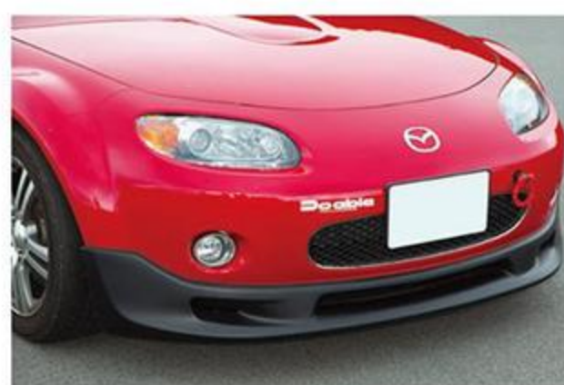
フロントリップ、リアスポイラーはオリジナル。フロントリップはフラットボトムとなっており、純正のアンダーパネルに連結する。
