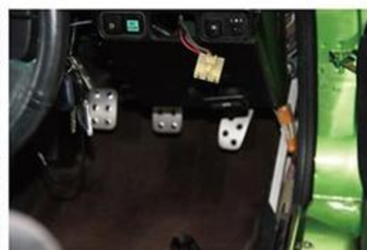
電動ファンは1000度近くならないと作動しないので、強制的に回転させるようにフォグランプのスイッチを利用した。
