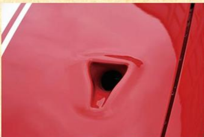
ノーマルのボンネットにNACAダクトを加工して装着。残念ながらオリジナルパーツとしての販売はないが、こんなアレンジもありといういい見本だ。
