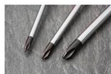
ドライバーは各サイズを用意して適正サイズを使い分けことが大事。サイズが小さいとナメやすい。
