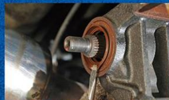
デフキャリアからオイルシールを取り外す。新品に交換するのだが、取り付けの際はデフオイルを塗布。
