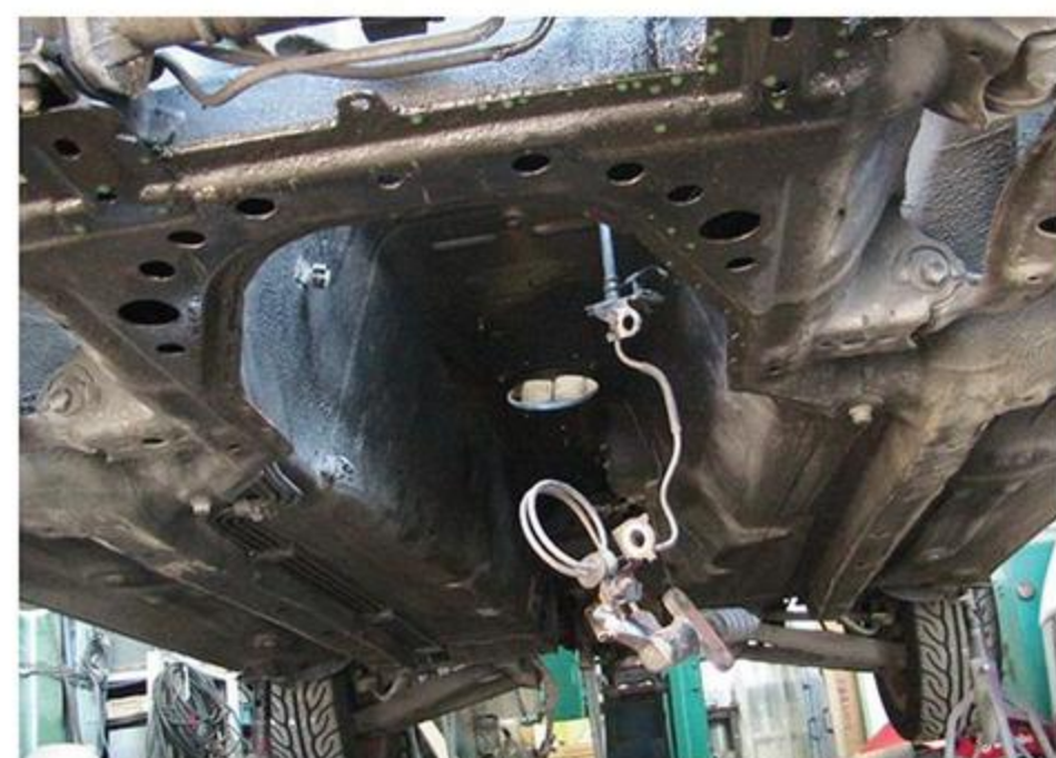
エンジンもミッションも降ろした状態にして、スポット増しや各部の補綴作業を行う。この車両はサビを落とす作業も多かった。
