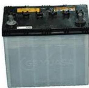
NCに装着されていたものと比較すると、こんなにサイズが異なる。サイズは10Pは縦82mm、横120mm、高さ180mmだ。
