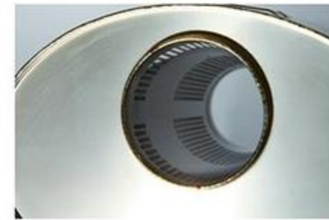
サイレンサー内部を見ると、パイプの内側に絞りなどは一切なく、キレイなストレート構造だ。パワーを引き出すには絞りはNG。
