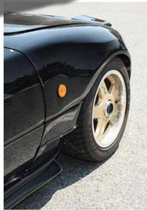
片側50mmワイドのフェンダーはFRPを使った自作。サイドステップやバンパーもこれに合わせて加工されているのでまとまりがいい。
