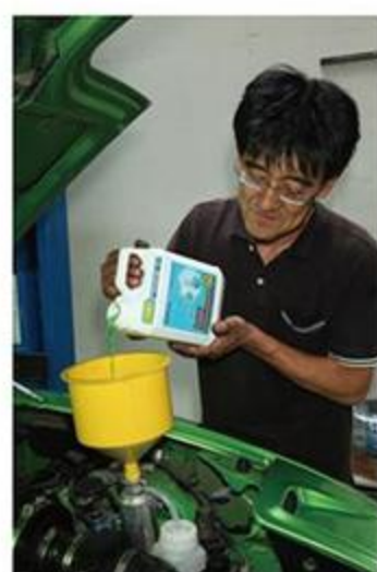
シリコンホースの取りまわしを見直したら、LLCを注入する。その後エア抜きも必要だ。
