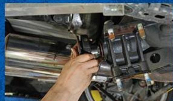
新品に交換してからは、デフオイルの飛び散りもないようだが、注意して見ておきたいポイントといえる。
