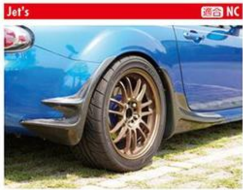
Jet's 適合 NC マスターズペックマッドフラップリアディフレクター 豊田インテグラル神戸 ☎078-935-2661 ●カーボン: 4万9350円/FRP: 3万3600円 ●カーボン/FRP 本来の機能はリアタイヤが巻き上げる泥を抑える、というもののだが、それと同時にリアタイヤが巻き起こした空気の乱れを整流することで、車両全体の空気抵抗を低減させる効果もある。
