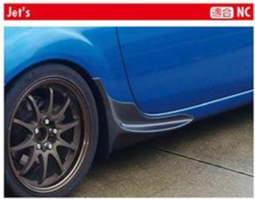
Jet's 適合 NC マスターズペックサイドディフレクター 豊田インテグラル神戸 ☎078-935-2661 ●カーボン: 4万9350円/FRP 3万3600円 ●カーボン/FRP フロントから入ってボディ下を流れる空気を、リアタイヤで乱れないようにするアイテム。空気の流れがスムーズになるため、走行中の車両の姿勢が安定する。長距離ドライブにもオススメしたいパーツだ。
