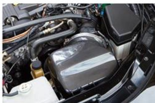
吸気チューンのみでは劇的にフィールアップしないが、トータルで手がけていけば外せない。フレッシュエアを吸わせるボックスタイプが◎。
