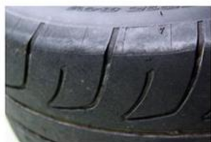
タイヤは溝があるものの、すっかり硬化してしまっている。1515号のタイヤを新調したので、次の機会だな、4040号。
