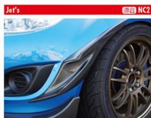
Jet's 適合 NC2 マスターズペックフロントカナード 豊田インテグラル神戸 ☎078-935-2661 ●カーボン: 5万4000円/FRP: 3万3600円 ●カーボン/FRP FRP製とカーボン製をそろえる。保安基準となる前30度、後50度のタイヤはみ出し対策にも考慮した形状だ。前後ボディの絞り込みが大きいNC2だけに、装着するさまざまなメリットを感じる。
