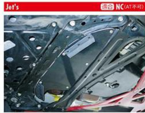
Jet's 適合 NC(AT不可) マスターズペック ダウンフォースシステム(MSDS) アンダーエフェクトパネル 豊田インテグラル神戸 ☎078-935-2661 ●FRP: 8400円/カーボン: 1万2600円 ●FRP/カーボン ノーマルでも車体下のフラット化が進んでいるNC。しかしラダーフレーム付近に大きな空間が開いているため、そこをふさぐことで不要な揚力を抑える。走行風を整流することでダウンフォースを発生させる。
