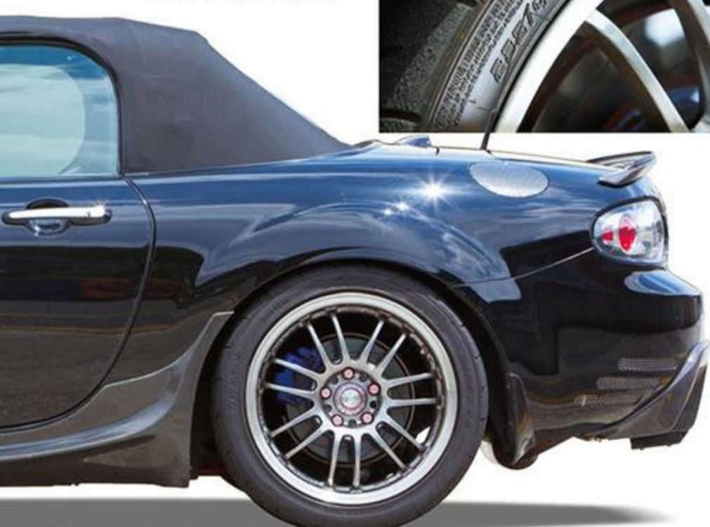
NCユーザーに大人気なのが215サイズ。だが、外径は235サイズでノーマルに近くなる。8Jをチョイスしておけば両サイズが装着可能だ。
