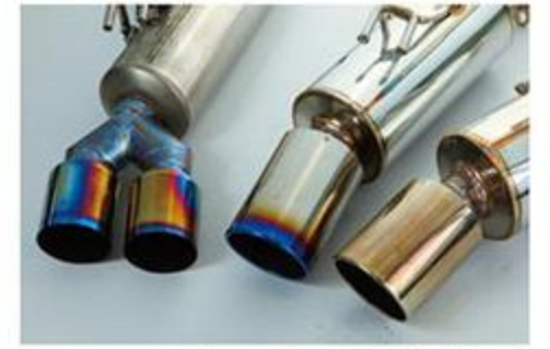
テールエンドも好みに合わせて選択可能。左右2本出しを選択しても、チタンなので重量増は最小限で抑えられる。
