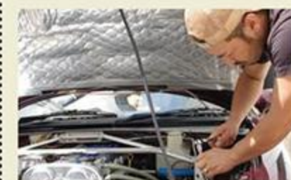
タワーバーの脱着はよくやる作業なので、ここでラチェットを試してみる。これまで12角のほう作業性はいいと思っていたが、目からウロコが。
