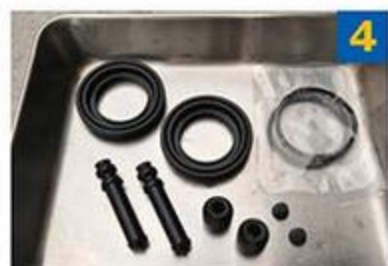
4 純正のキャリパーシールキットを用意。キットにはダストブーツのほか、シールリングやブーツなどのゴムパーツがひとつと付属されている。
