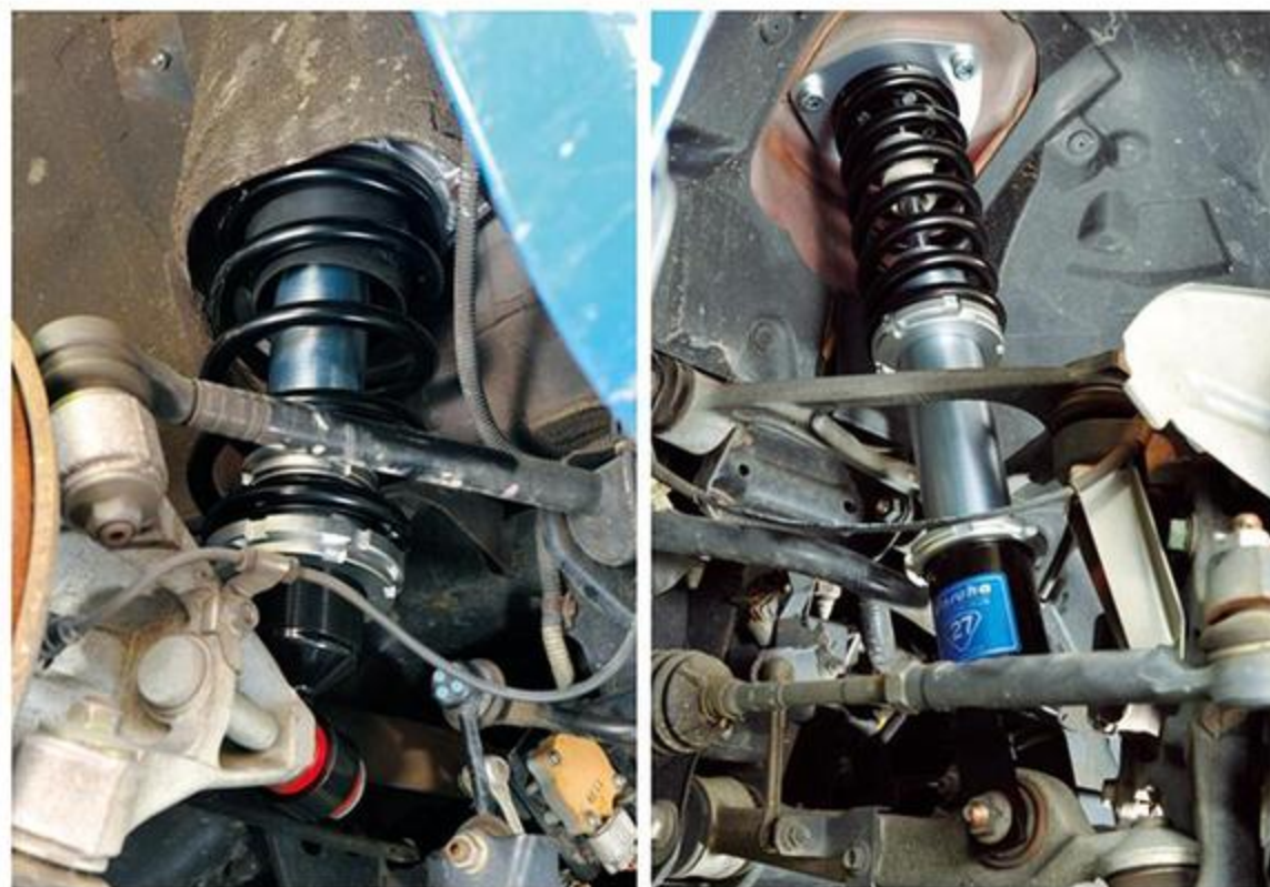
サスペンション交換やアームブッシュの打ち替えなど、足まわりの脱着作業を行った場合、アライメントが大幅にずれてしまうため調整しておく必要がある。
