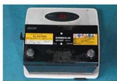
NCに装着されていたものと比較すると、こんなにサイズが異なる。サイズは10Pは縦82mm、横120mm、高さ180mmだ。
