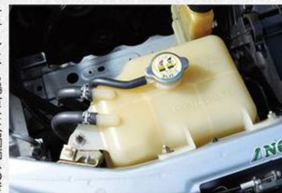
チューニングをする場合には冷却面への考慮が必要。純正タンクのヒビ割れに注意するのはもちろん、レベルによってはラジエーター交換も考えておきたい。
