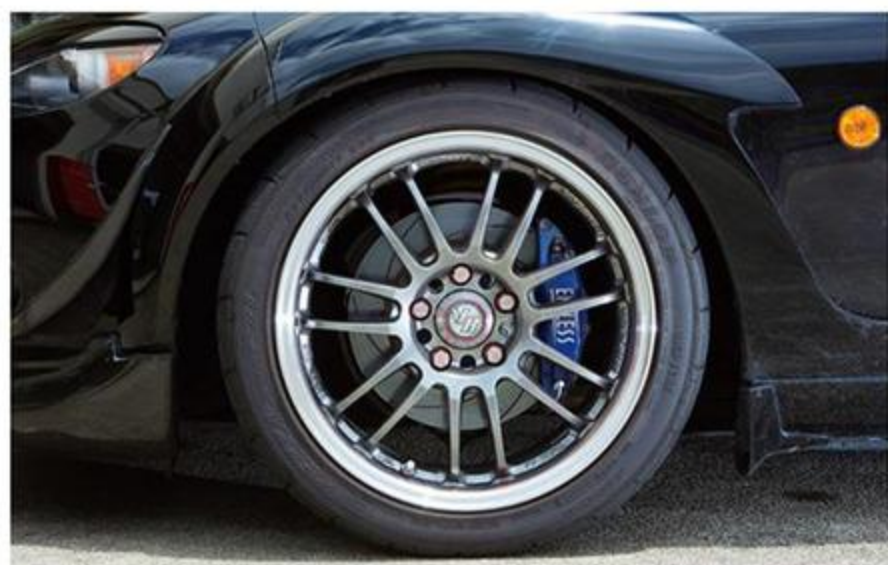
NCユーザーに大人気なのが215サイズ。だが、外径は235サイズでノーマルに近くなる。8Jをチョイスしておけば両サイズが装着可能だ。
