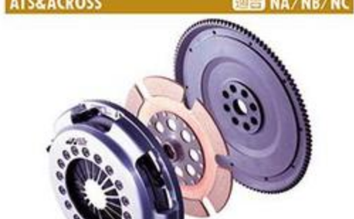
ATS&ACROSS NA/NB/NC メタルシングルクラッチ 巻 エイティーエス ☎086-286-9331 ⑤ 1300kg f/1600kg f 各11万5500円 ④ メタル ④ カバー ディスク・フライホイール ④ シングル ⑤ 1300kg f/1600kg f
