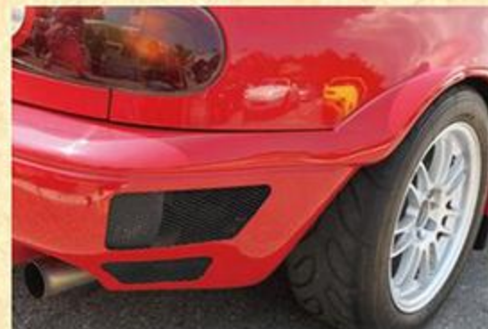
タイヤ部の乱流を外側に排出するため、ダクトとフェンダー形状にこだわった。
