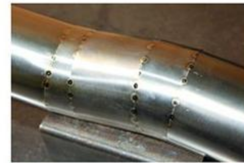
溶接部のクオリティや耐久性にもこだわりあり。バックシールド処理を行い、右側のように溶接面は美しい。左は未処理のサンプルだ。
