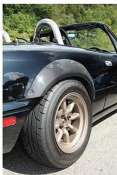
オーバーフェンダーの装着により、リアはマグホイール7Jに185/60R14のタイヤの装着が可能に。
