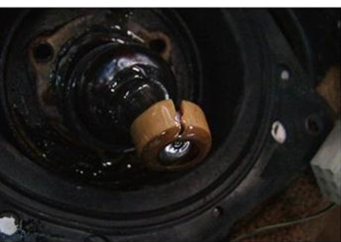
シフトの付け根にあるブッシュが割れてしまうと、シフトがカチッと入らずに抜ける現象が出てくることもある。クスコの真鍮製が◎。
