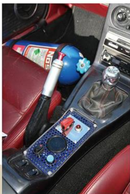
オークションで手に入れたNOS(ノス)ボトルの容量は10ℓ。オリジナルのスイッチシステムも見逃せないポイントだ。
