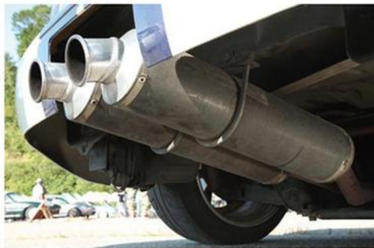
センター2本出しマフラーは、ヨシムラのバイク用サイクロンを加工して取り付けたもの。バイク用品が使われることは多い。
