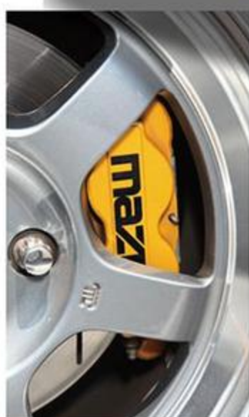
マルハのキャリパーはただ装着するだけでなく、ボディカラーに合わせて耐熱塗料でペイント。こういうところがうまい。
