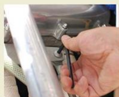
ヘキサゴンレンチもすごい剛性。ボルト&ナットに吸いつく感覚で、ガタがないから回転方向に力が集中できる。
