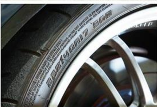
NCユーザーに大人気なのが215サイズ。だが、外径は235サイズでノーマルに近くなる。8Jをチョイスしておけば両サイズが装着可能だ。
