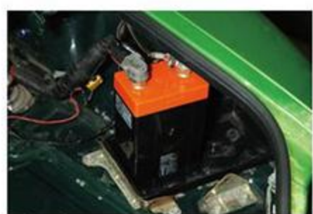
NCに装着されていたものと比較すると、こんなにサイズが異なる。サイズは10Pは縦82mm、横120mm、高さ180mmだ。
