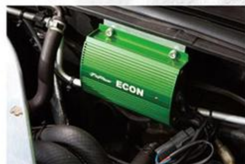
アクセルを踏み返した際のパンチ力を引き出すなら、点火強化パーツの装着が効果的。市街地走行でもしっかり体感できる。
