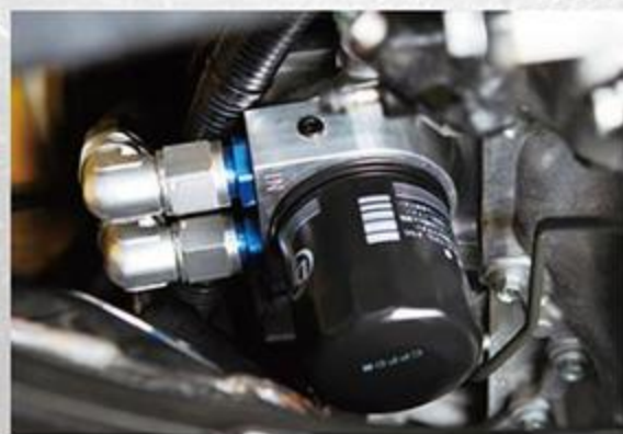
NOPROのオイルクーラーはプロックもキット化されている。油温計などを装備することもできるので、より確実なオイルの管理ができる。
