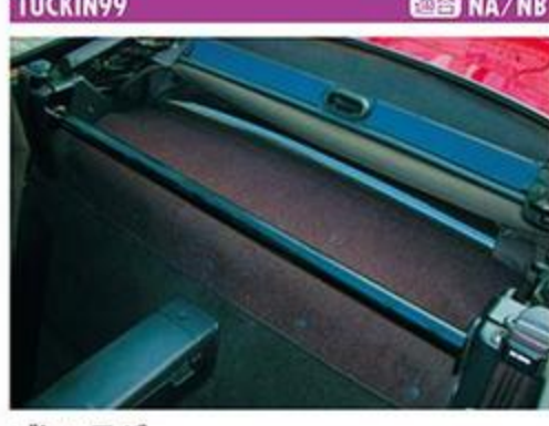
TUCKIN99 適合 NA/NB ブレースバー ◎タックイン99 ☎0798-36-1299 ◎ 1万2600円/アイボルト付き: 1万4490円 ◎ スチール
