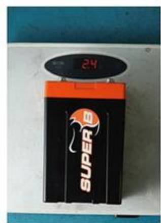
これが15Pというサイズで、電力消費の激しい車両はこのほうが安心できるだろう。これでも3kgないのだ。
