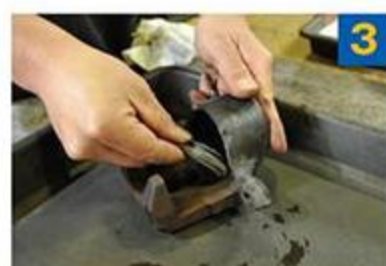
3 キャリパー内部にキズがないかをチェックしつつ、クリーナーでいっしょに洗浄。同時に、ピストン内部の汚れもキレイに落とす。
