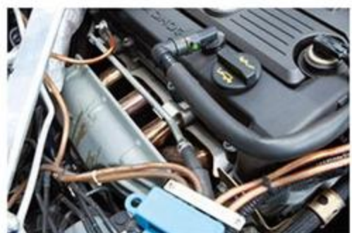
大きくフィールアップするのがEXマニ。ただしエンジンルームへの熱害は想像以上に大きくなるため、各部への遮熱が必要となる。
