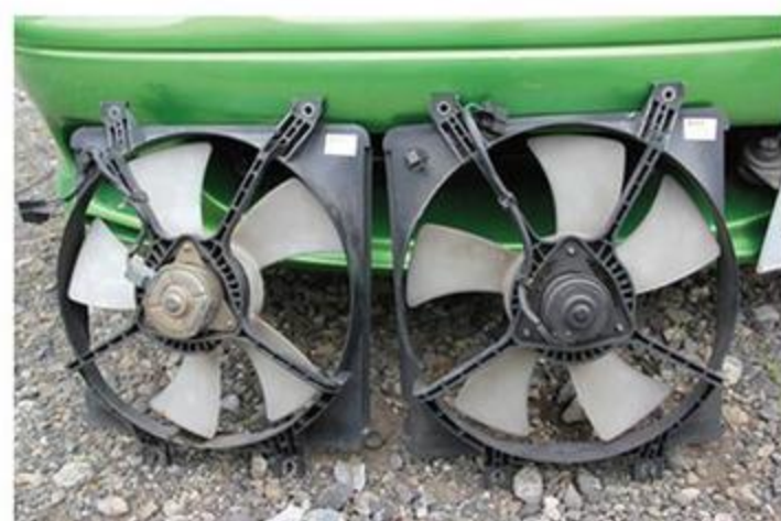
電動ファンの不具合を疑い交換。前オーナーが交換したものか、カプラーを無理やりくっつけた。見慣れないファンが取り付けられていた。
