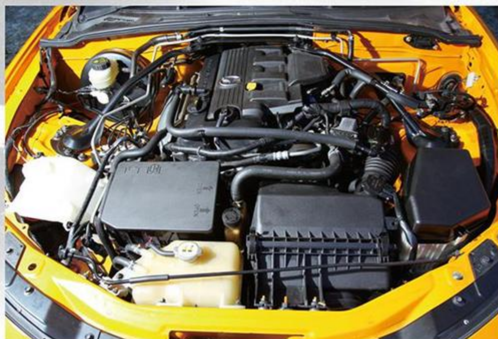
チューニングをする場合には冷却面への考慮が必要。純正タンクのヒビ割れに注意するのはもちろん、レベルによってはラジエーター交換も考えておきたい。
