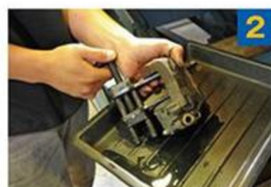
2 キャリパーを完全に取り外したら、ブレーキホース取り付け口からエアガンでエアを注入し、その力を利用してピストンを押し出す。
