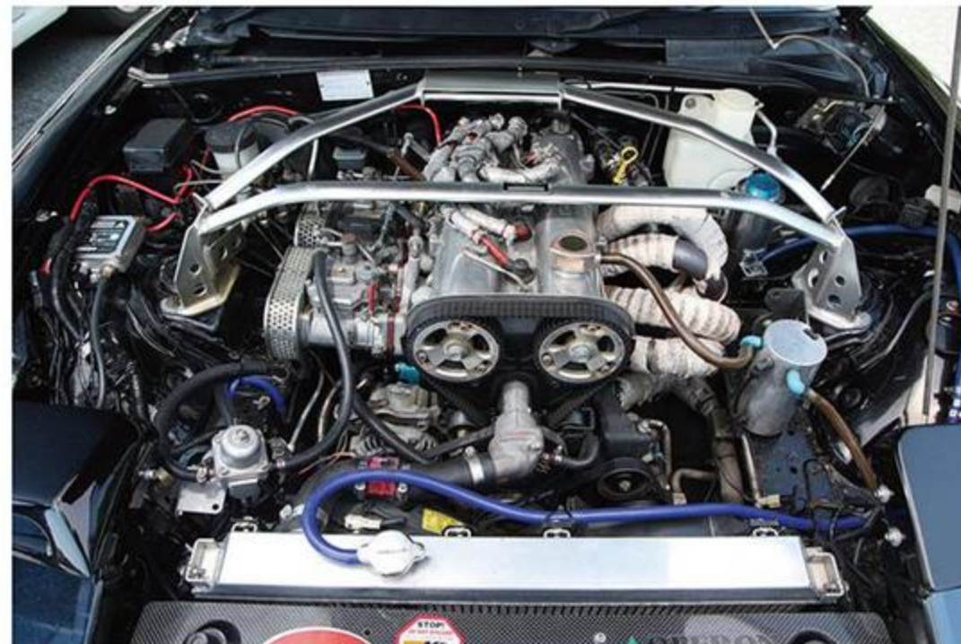
圧縮比アップとキャブ化によって、回したときのフィーリングが気持ちよく、サウンドもスポーティ。サーキット走行をするクルマなので冷却系の仕上げもバッチリだ。
