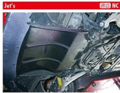
Jet's 適合 NC マスターズペックダウンフォースシステム(MSDS) ベンチュリーアンダーパネル 豊田インテグラル神戸 ☎078-935-2661 ●FRP: 2万5200円/カーボン: 3万7800円 ●FRP/カーボン 車体下を流れる走行風を利用し、ベンチュリー効果でダウンフォースを発生させる。高速走行時の安定性の向上に。また、バンパー開口部から取り入れた冷却風をラジエーターにまんべんなく当てる役割も果たす。
