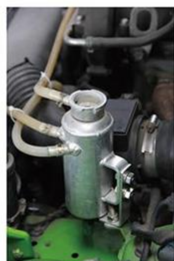
L字スターを使って、取り付け位置も若干変更してセットした。本体もこの後ピカールで磨いた。
