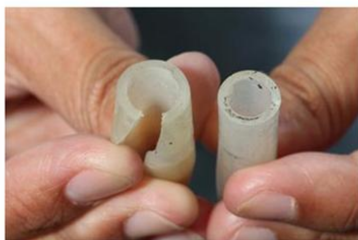
ホースに穴が開いていたため、急ぎよパイプで処置しておいたもの。ホース自体がもう熱で劣化しており、手を簡単にちぎれた。
