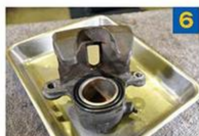
6 キャリパー内部に異物が混入しないようにピストンを挿入。斜めに入らないように注意。装着後はブーツの組み込みを再度確認する。
