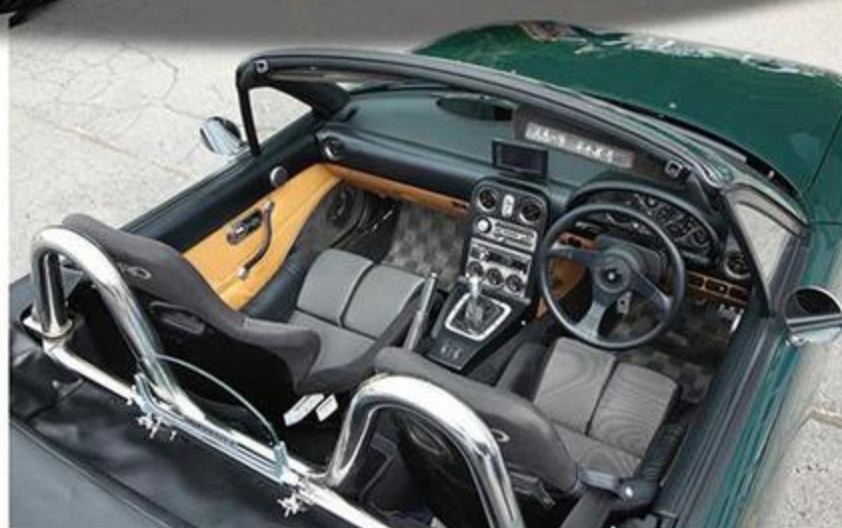
内装のドア内張りには「染めQ」で塗装したもので、ムラなくきれいに仕上げられて いる。こうした作業もすべてDIY、自分でやっているのだ。
