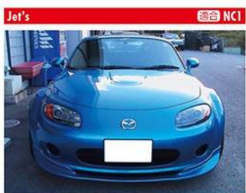
Jet's 適合 NC1 マスターズペックフロントアンダースポイラー 豊田インテグラル神戸 ☎078-935-2661 ●カーボン: 4万9300円/FRP: 3万7800円 ●カーボン/FRP 純正リップとほぼ変わらないロードクリアランスを確保。機能面では水温の安定化を図るため、開口部を大きくとり、大量の空気を導入する。サイド部分でのダウンフォース発生効果も大きく、整流効果も高い。
