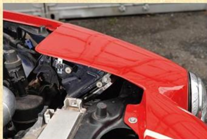
固定式ライトへ変更しつつも、ノーマルのリトラユニットは外さずに装着したまま。こうすることで、イザという時すぐにノーマルに戻せるのだ。
