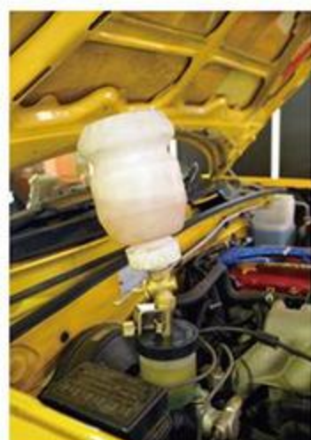
キャリパー装着後はブレーキフルードを注ぎ、エア抜き作業を行う。エア抜きが不完全だと無意味かつ危険なので、作業は慎重に。
