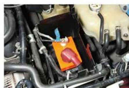
ボックスを見るとこれほどサイズが違ってくる。高さを確保しないと接続できないので、取り付けの際は必ず一考を要する。
