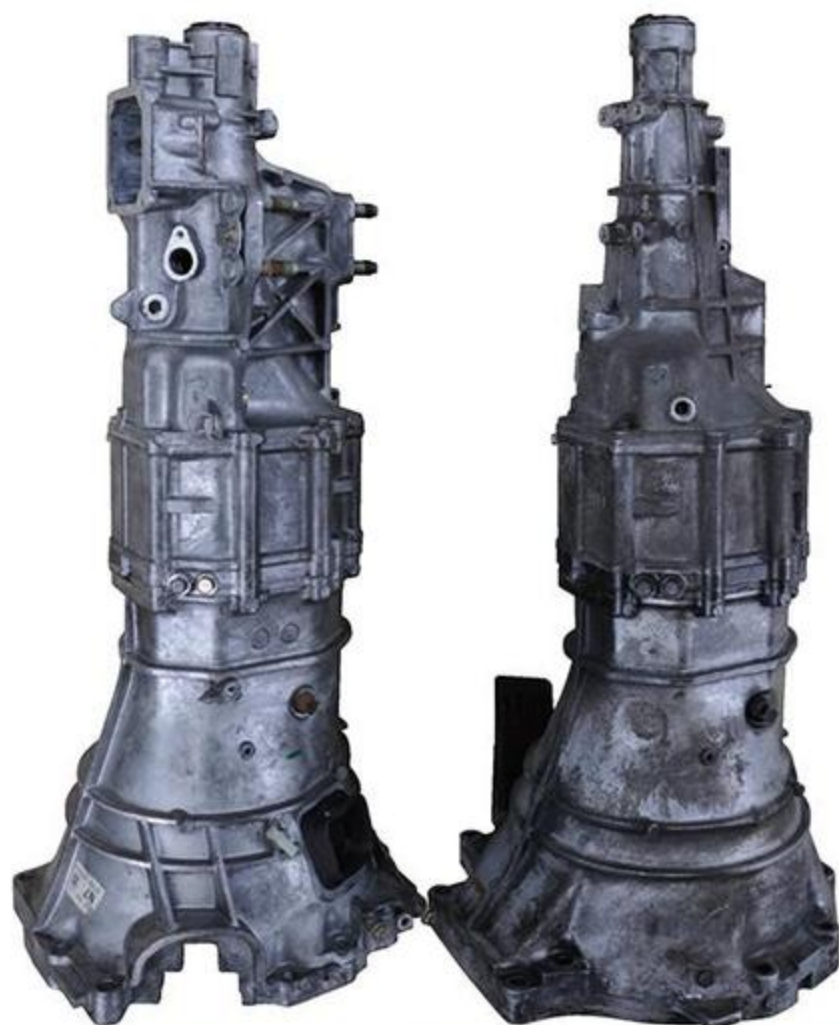
右がNBのミッション。サイズは変わらないのだがミッションの取り付け部が異なるためケースは使えない。
