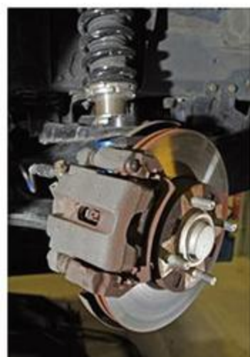
今回はNAロードスターのフロントブレーキキャリパーのオーバーホールを紹介。重要保安部品だけに、細心の注意を払って作業する。
