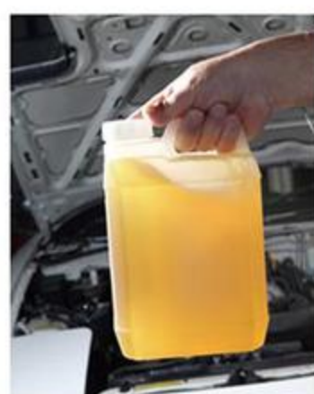
ボトルを振ってみるとシャバシャバなのがわかる。これが油膜切れを防ぐポイント。粘りが強すぎるとかえって油膜が切れやすい。
