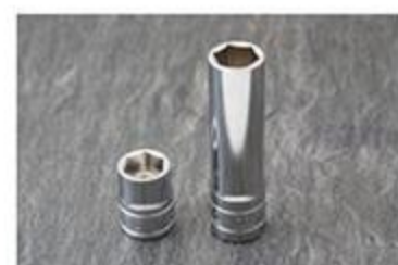
ソケットは飛び出したボルト部分のナットにアクセスすることを考えるとディープが欲しいところ。
