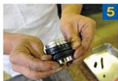
5 付属のグリスをダストブーツに塗布し、ピストンに装着。ダストブーツは、ピストンに組んでからいっしょに装着すると作業がしやすいという。
