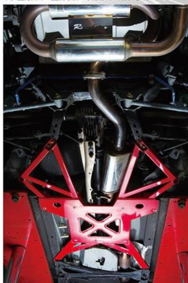
ボディ剛性自体はノーマルでも不満のないNCだが、フロア下補強はステアリングフィールに好影響をもたらしてくれる。空力面での整流も細かな部分だが効果的だ。
