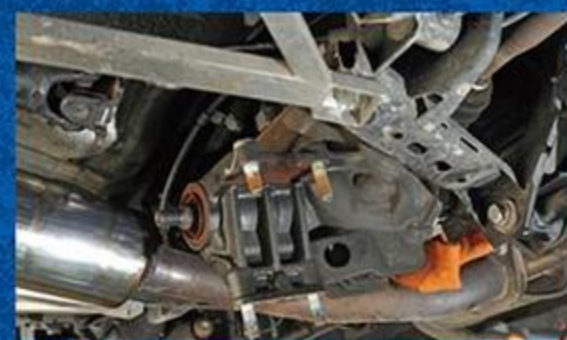
デフのシールがへたっていたせいかオイルが漏れて周囲がオイルまみれになっていた。まだ4万kmなのに。
