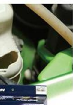
ホースに穴が開いていたため、急ぎよパイプで処置しておいたもの。ホース自体がもう熱で劣化しており、手を簡単にちぎれた。
