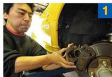
1 ブレーキキャリパーを外す際、ブレーキホースやフィッティングに負担がかからないよう、ホースは先に取り外しておくことがポイント。
