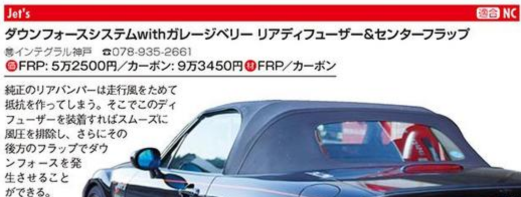
Jet's 適合 NC ダウンフォースシステムwithガレージベリリー リアディフューザー&センターフラップ 豊田インテグラル神戸 ☎078-935-2661 ●FRP: 5万2500円/カーボン: 9万3450円●FRP/カーボン 純正のリアバンパーは走行風をためて抵抗を作ってしまう。そこでこのディフューザーを装着すればスムーズに風圧を排除し、さらにその後方のフラップでダウンフォースを発生させることができる。
