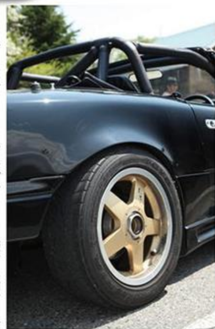
片側50mmワイドのフェンダーはFRPを使った自作。サイドステップやバンパーもこれに合わせて加工されているのでまとまりがいい。
