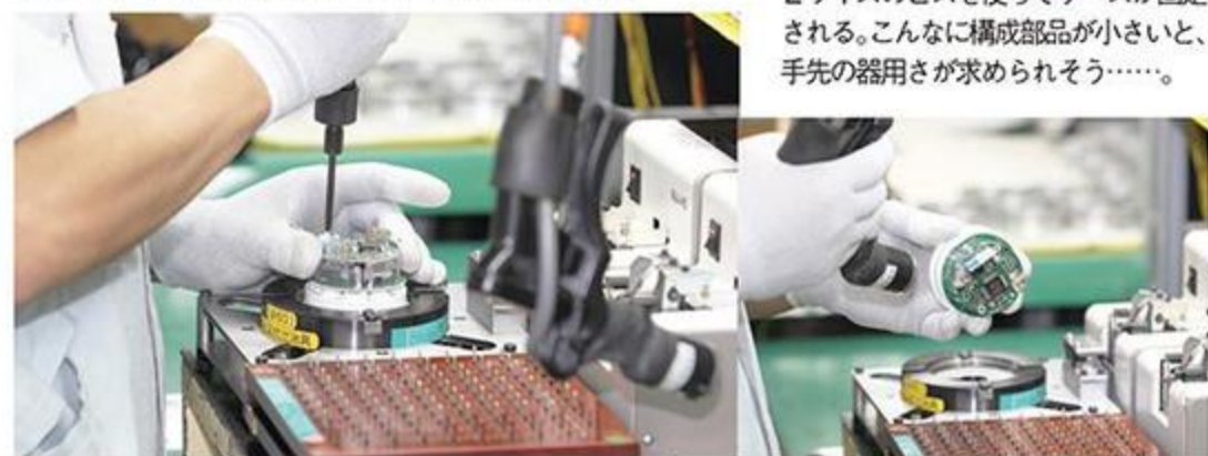
除電作業を行っているところ。作業の途中段階においても、こうした静電気対策が講じられている。静電気が生じる車内で問題なく作動しているのはすごいことだ。
