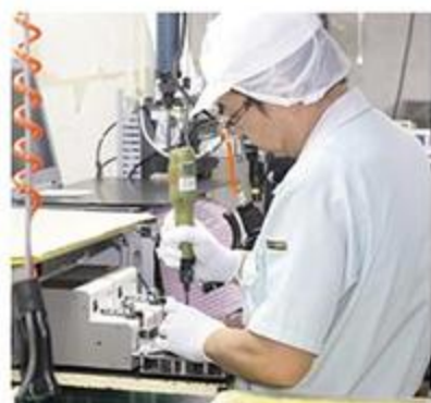
2サイズのビスを使ってケースが固定される。こんなに構成部品が小さいと、手先の器用さが求められる……。
