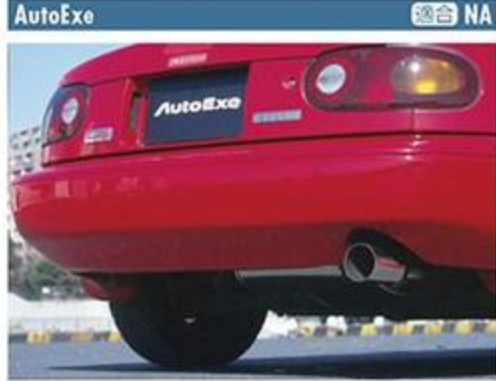
AutoExe 適合 NA ステンレスマフラー ※オートエクゼ ☎03-3531-8151 ⑤ 10万1850円 ⑥ ステンレス ⑦ メイン:65φ-テール:90φ×2 ⑧ 左右2本出し
