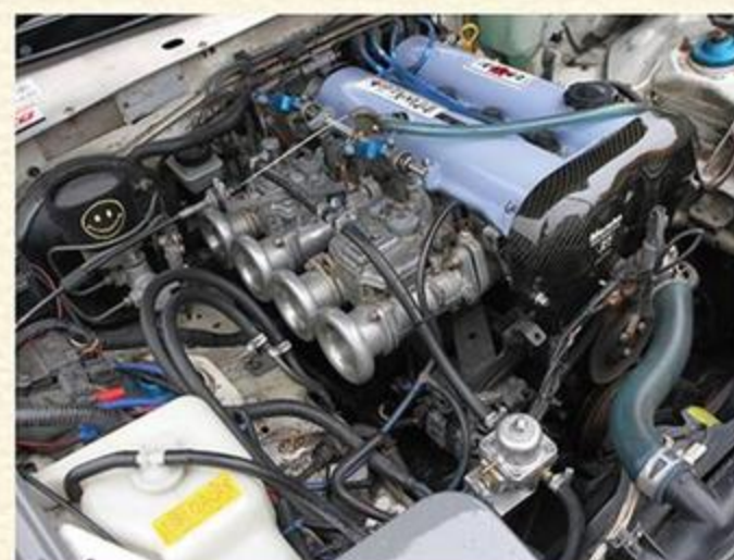
キャブ仕様で自らセッティングしている。インマニに異物が入った経験があり、このときはヘッドがブローするという大惨事に。
