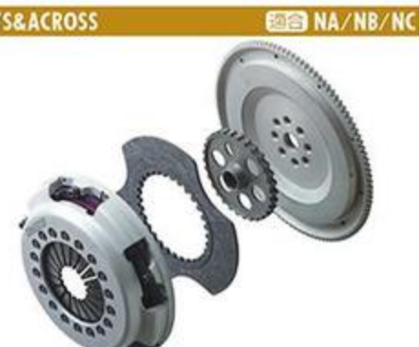
カーボンシングルクラッチ 専 エイティース ☎086-286-9331 ● 1000 kg f: 17万6400円/1300 kg f: 17万9550円 ● カarbon ● カバー・ディスク・フライホイール ● シングル ● 1000kg f/1300kg f
