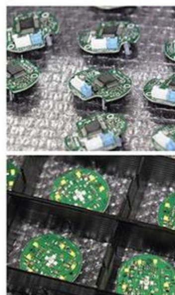
基盤を組み込んだらケースを取り付ける。固定する治具もデフォルト専用、専用でなければうまくいきません。
