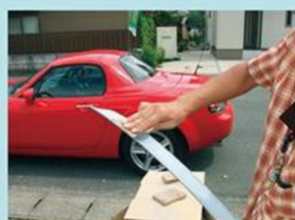
脱脂作業の完了後、サフェーサーを塗り、父に手伝ってもらって(やってもらって?)ペーパーでツルツルに。
