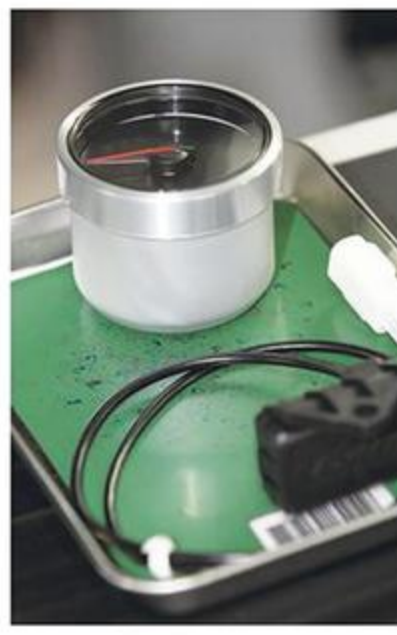
文字盤のパートと本体がロールカシメによって合体したら、セットとなるセンサー類が合わせられトレイに載せられていく。
