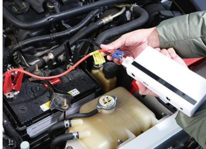
バッテリーにプラス、マイナスのブースターケーブルをつないでから、本体にコードを接続してエンジンを始動させる。
