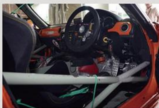
ロールバーはワンオフの特注品でボディには強度を確保するため溶接留めが義務付けられている。
