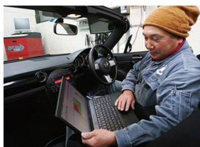
エンジンは車上で作業ができるカムシャフトのみを交換しただけで吸排気系はノーマル。コンピュータはそれに合わせてセッティング。
