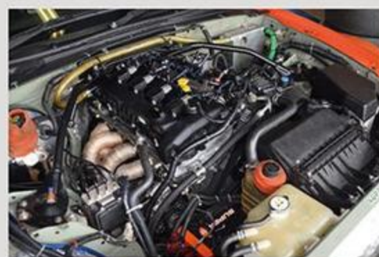
NC2用のピストン、鍛造クランクを組み込んでいますが、エンジンルームは市販車とさほど変わらない。
