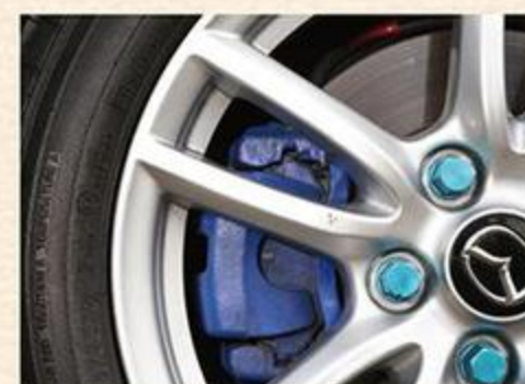
エンドレスのキャリパーを塗装したいところだが、なかなか予算が組めないため耐熱塗料でカラーリング。気分はエンドレスだ。
