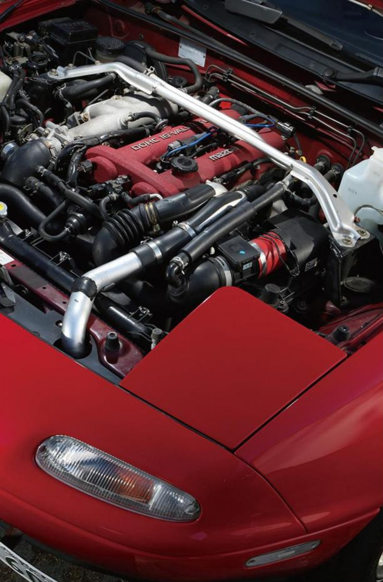
ターボの換装は思っていたよりもラクだったが、苦労したのはパイピングの取りまわし。試行錯誤の末セット。
