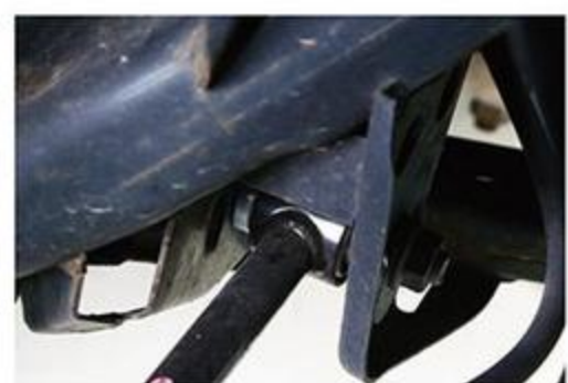
腰砕け感を払拭するため、コントロールアームのブッシュだけはピロに打ち替えるが、基本的には「車高調でのハンドリング改善」にこだわる。
