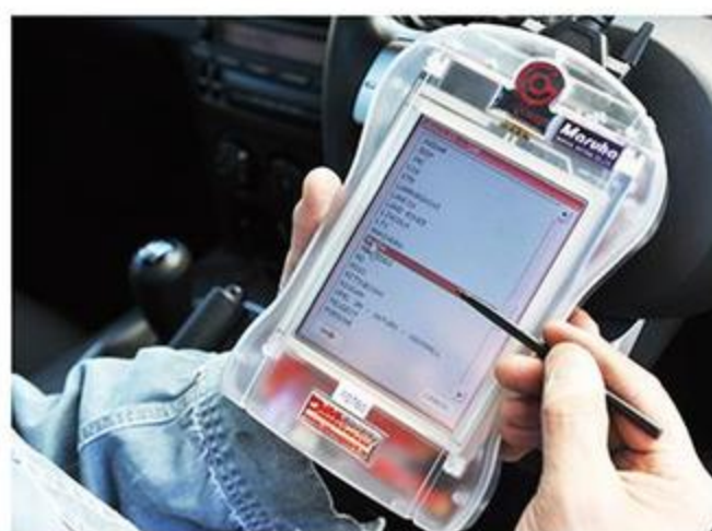
ディムスポルトはジーニアスを使ってデータを抜き取ってオンラインで送り、返ってきた新データを書き込むことができるシステムだ。
