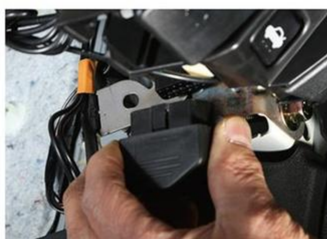
これが車両側でデータを読み込んだり書き込んだりする端末、ジーニアス。ロードスターだけではなくほぼ全車種に対応している。
