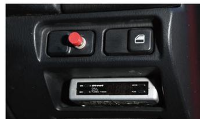
赤いボタンは、リトラクタブルライトの開閉ボタン。NBにはないスイッチとなるので、ガレージIの駒場代表がセットしてくれた。
