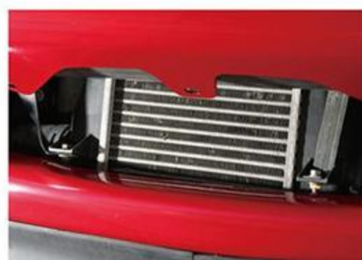
純正のインタークーラーもしっかり流用。ブースト値もノーマルとなっており、コンピュータも配線からすべて引き直してある。
