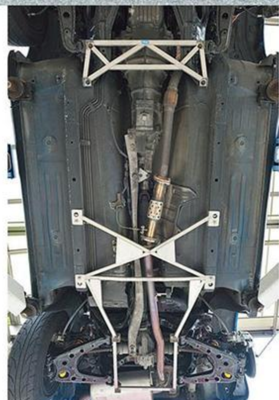
下まわりにはマジカルクロスを入れている。シートの後ろにあるリアバルクヘッド・トラスバーが入っている。
