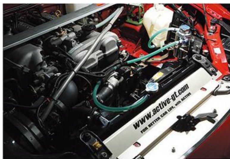
エンジンルーム内の熱気を逃がすように追加されたダクト。フロントバンパーから入った走行風がここから抜けるようになるのだ。空気の流れを考慮したコーディネートが必要になってくる。
