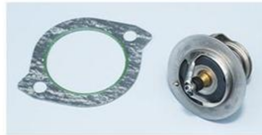
ローテンサーモは冬場にオーバークールとなるといった理由から敬遠されがち。しかし、夏場には効果を発揮するのでサーキットを走るなら季節に応じて替えるくらいの配慮が欲しいところ。
