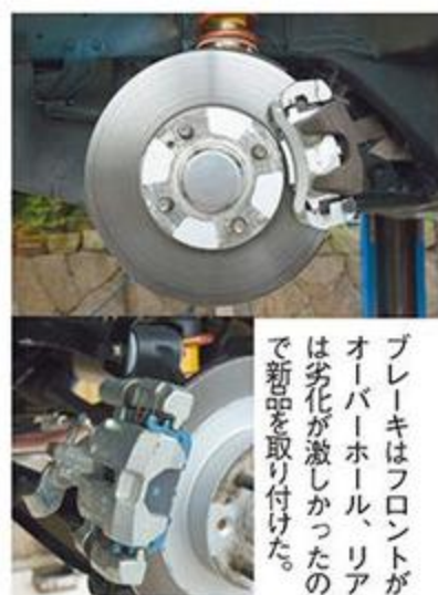
ブレーキはフロントが オーバーホール、リア は劣化が激しかったの で新品を取り付けた。 足まわりはショートストロークタイ プのニーレックス・プロスベックライ ダーを選択。街乗りから楽しい。
