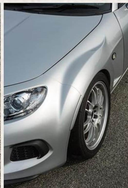
フロントフェンダーは片側10mmワイドのインテグラル神戸製。NC3顔は精悍さとファニーなテイストが共存しているいいかも。
