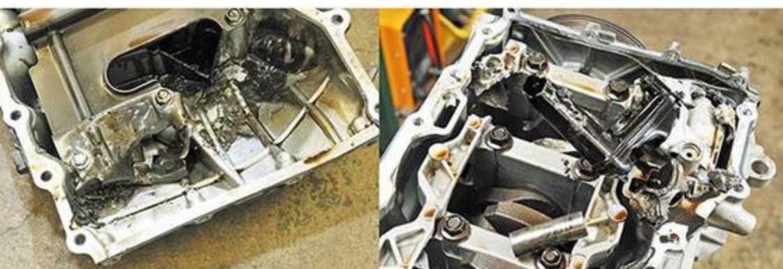
エンジンプローをコンロッドが突き破りかけている、そんなエンジンを開けてみたら悲惨なことになっていた。これはメタルではなくピストンの油膜切れが原因のレアケース。
