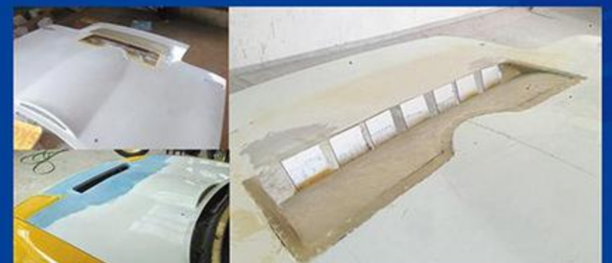
バルクヘッド側にダクトのあるボンネット、懐かしい感じがする。取り付けてみると違和感なくフィットする。冷却効果も高そう。
