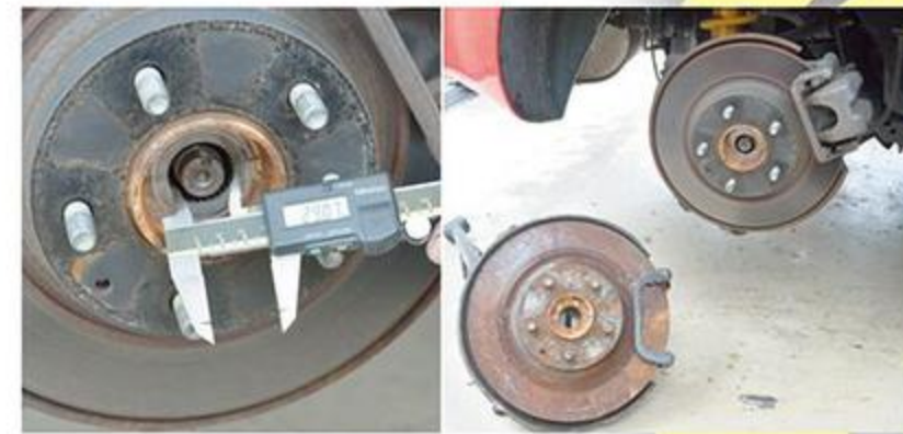
ローターおよびピストンサイズの違いは、見ればすぐにわかるレベルだ。リアがベンチレーテッド化できるのも大きなメリットである。
