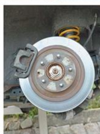
リアもブレーキはポン付け流用が可能。ベンチレーテッドタイプとなることで冷却効率もアップ。
