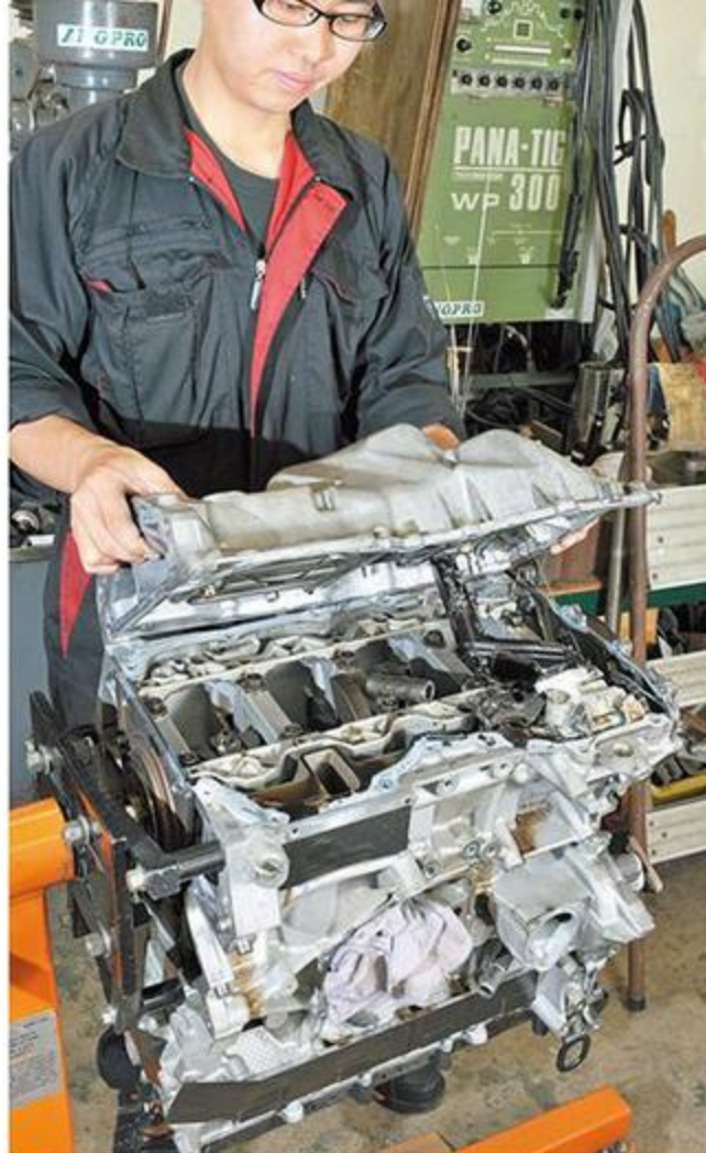
エンジンプローをコンロッドが突き破りかけている、そんなエンジンを開けてみたら悲惨なことになっていた。これはメタルではなくピストンの油膜切れが原因のレアケース。
