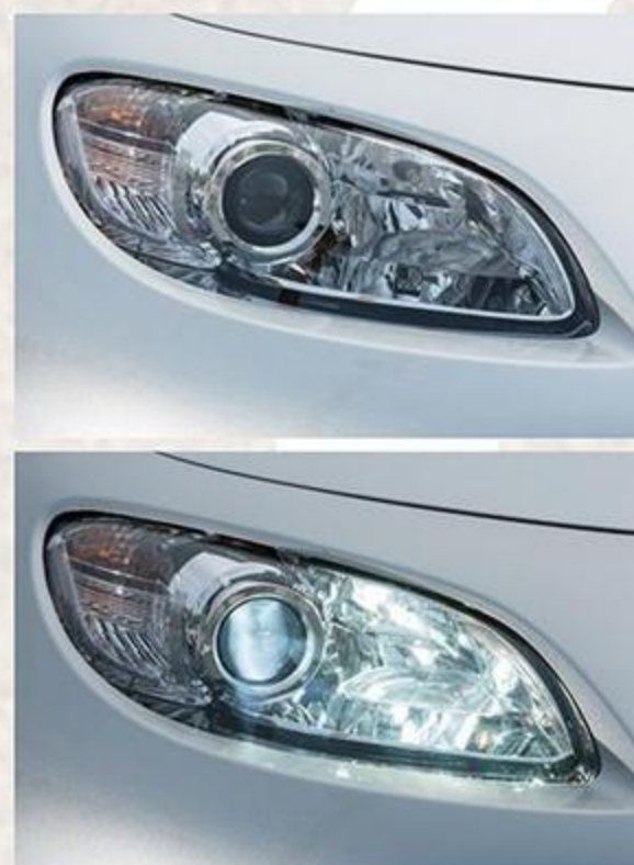
NC3ルックへのスワップに伴い、ヘッドライトは後期純正に変更。ただし、前期と後期ではハイビームのバルブ形状が異なるので、これを機に汎用キットでHID化。同時にロービームも社外の高性能モデルに交換した。
