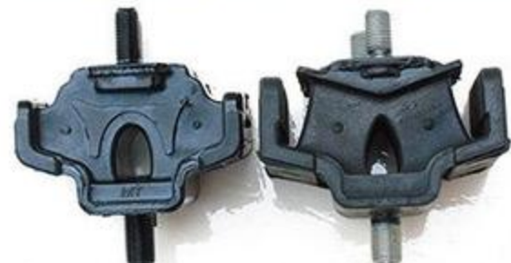
ゴムの硬度とマウントの形状をイチから見直し、純正比1.8倍の硬度を手に入れたオーバードライブの強化エンジンマウント。純正(写真右)に対して強化マウント(写真左)は隙間なども大幅に減っていて、見た目からも「しっかり固定できそう」と期待できる。
