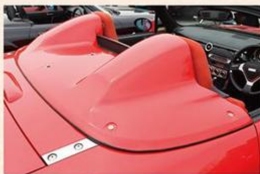
トノカバーはダムド製で、それがすっきりとしたシルエットをアピールする。排気系はエキマニから後ろがすべてオートエクゼ。
