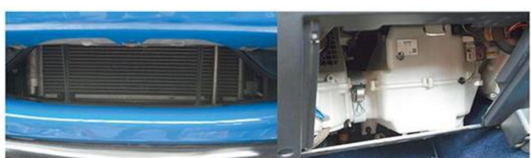
エアコンはNB用を取り付けることでできが別物に。コンデンサー、ヒーターコアなどごっそり新品になった。これでもう10年以上快適に乗り続けられるのだ。
