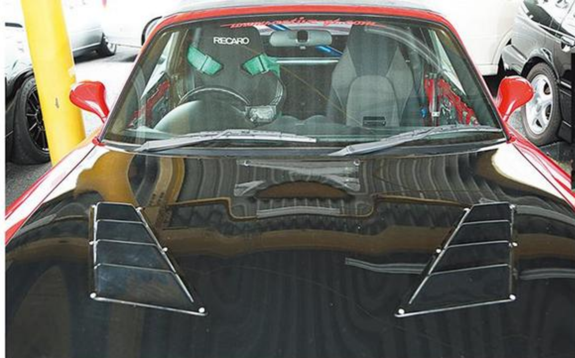
エンジンルーム内の熱気を逃がすように追加されたダクト。フロントバンパーから入った走行風がここから抜けるようになるのだ。空気の流れを考慮したコーディネートが必要になってくる。
