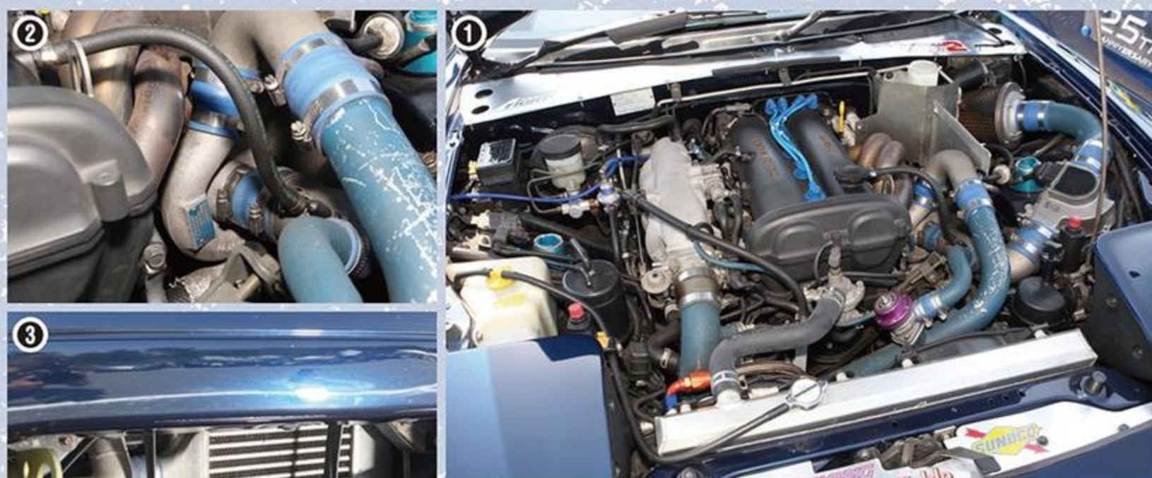
①オーバーホール時にファミリアのピストンを入れたエンジン。過去にエキマニが割れたこともあったが、長く乗っているとこうしたこともある。②今となれば貴重品!?トラストのターボキットを組み込んで走っているが、デフはノーマルのままでも問題なくスポーツ走行している。③インタークーラーはキットに含まれている。フロントバンパーから見えるコアが、やる気を感じさせる。
