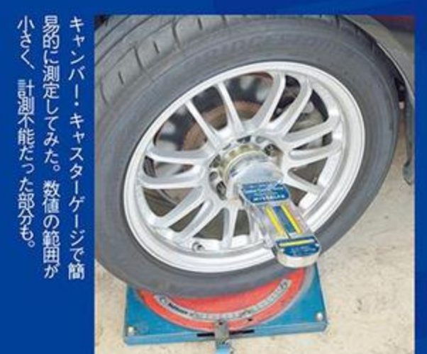
ステアリングのセンターを決めてから、90度、180度と正確にステアリングをきり込んでいく。
