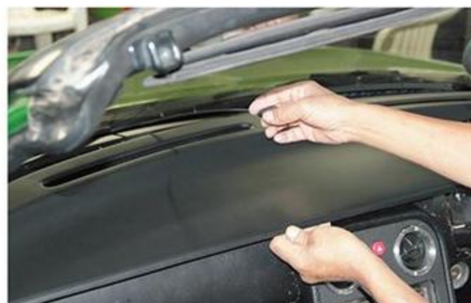
位置合わせをしてから、ぴったりくっつけるように。両面テープ (付属)を細かく配置することで、より密着度が高くなる。音が出 たりしないよう配慮して取り付ける。
