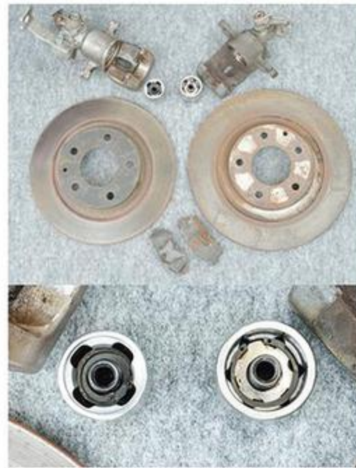
ローターおよびピストンサイズの違いは、見ればすぐにわかるレベルだ。リアがベンチレーテッド化できるのも大きなメリットである。
