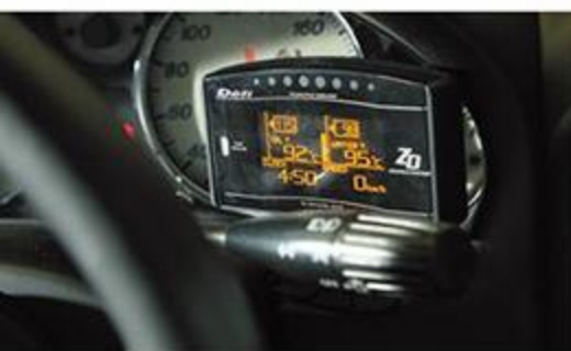
ノーマルの電動ファンは98℃になると作動するが、ここで動いたところで実際には100℃に達してしまう。ノーマルの水温計では細かい部分がわからないので、アフターメーターは必須アイテムと考えておきたい。
