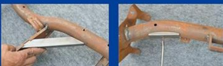
新品ではもうパーツが出ないため ノーマル下取りとなる。価格は3 万6000円(税別)。 曲がっている部分は力が分散して しまう。そのためガセットをあて がい直線になるよう形作る。
