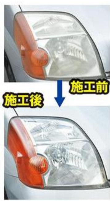
程度の差によってどこまでクリアになるか異なるが、光量にも差が出てきそうな仕上がり具合だ。早めに対処しておけばその後の負担にも差が出てくる。
