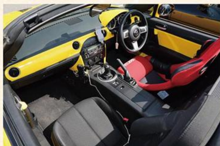
車内はS2000純正のニューラインディエローでアクセントを与える。これも各パーツを取り外し、缶スプレーで自家塗装を行った。
