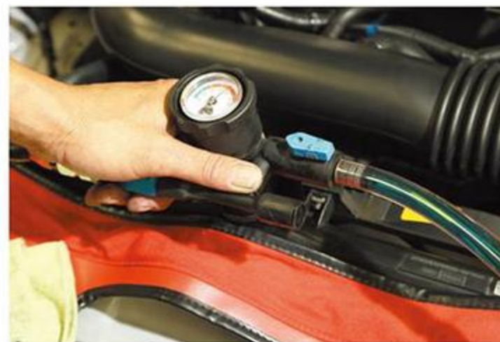
アクティブではラジエター内のクーラントをバキュームして、少しでも新品を注入できるようにした設備を整える。こうした配慮ひとつとっても、クーリングに対する姿勢がうかがえるのだ。
