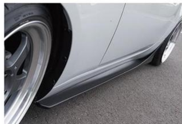
フラットなボトムはボディ下面の空気をスムーズに流し、後端のデザインで後輪が巻き起こす乱流を制御。さらにこの後部デザインはドア後端のアールとマッチ。FRP製5万円。
