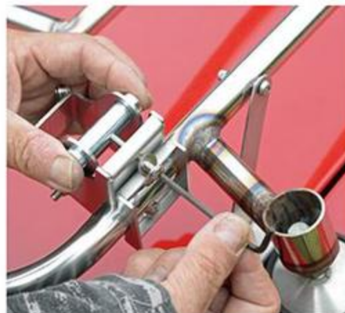
ナットは付属のレンチで締め付けるようになっている。いきなり締め込むのではなく、調整しながら取り付けていくのがいいだろう。
