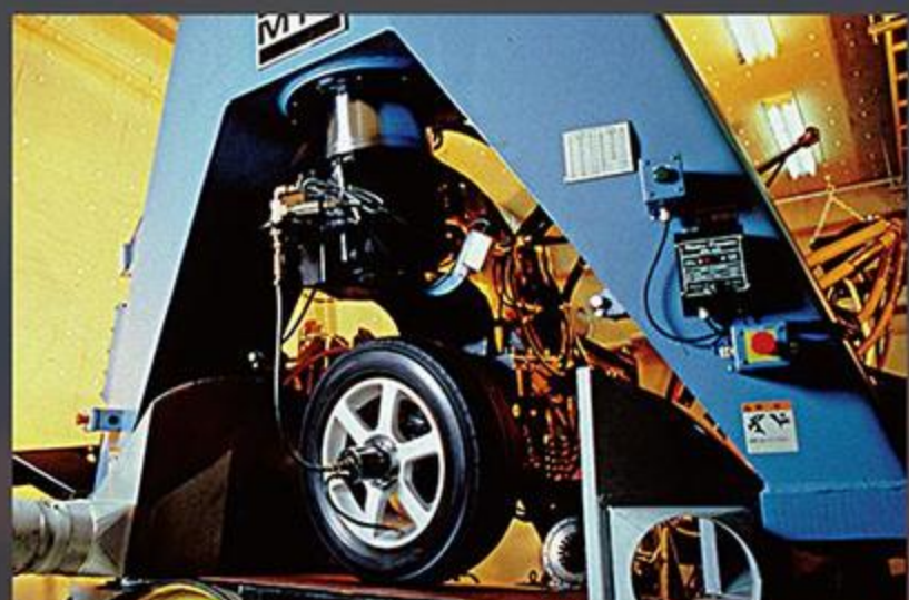
タイヤ開発には実際に試作したモデルを使った各種試験が欠かせない。シミュレーション機にかけデータを収集している。
