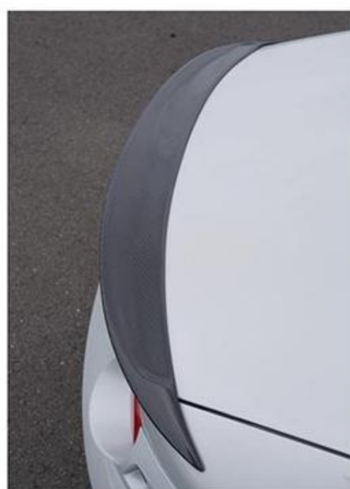
オープンにしているときもそうだが、クローズ状態でもダウンフォースを発生させる。カーボン製7万円、FRP製4万円。特注で繊維カーボンも可。
