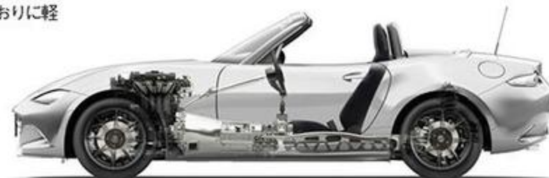
スカイアクティブシャシとして、サスペンションシステムの随所でも徹底した軽量化を実施。従来よりも12kgの軽量化に成功している。
