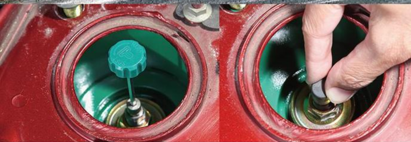
減衰調整は付属のドライバーを使うか、カバーをしたまま回転させる。右に回すと減衰を強めていくようになる。半分の8段階からスタートさせた。
