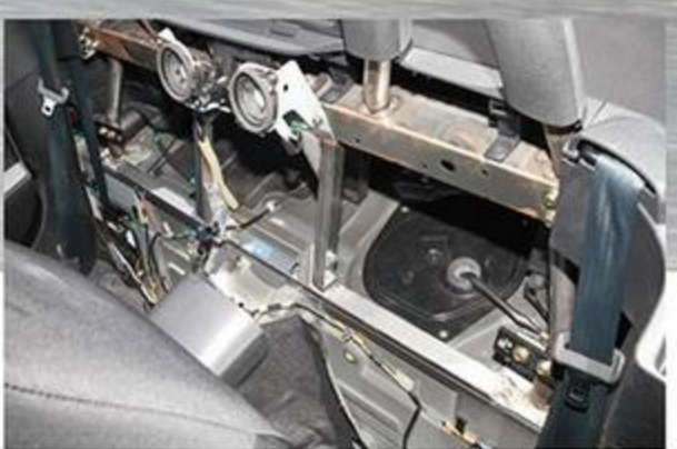
シートバックバーとリアバルクヘッドの間に設置し、強固な隔壁を形成するリアバルクヘッドブレース。フロア面の補強が済んだクルマや、ボディのヤレが気になる人に。
