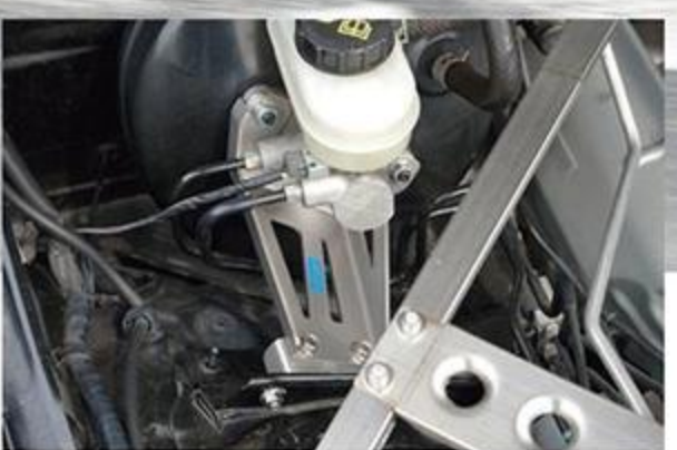
マスターシリンダーガゼットは、サーキット走行などハードブレーキを行う人向け。マスターシリンダーの付け根と車体を、ガゼット構造で連結させている。
