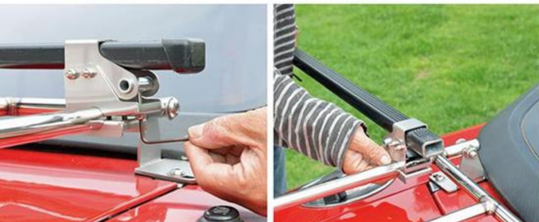
これはフラットベースを装着するためのブラケット。寸法23mm×32mm、長さ115mmのバーに対応している。タイヤも積載可。
