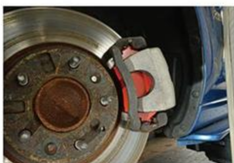
ブレーキはパッド交換で強化している。サーキットを走るからといって特別なチューニングはいらない。
