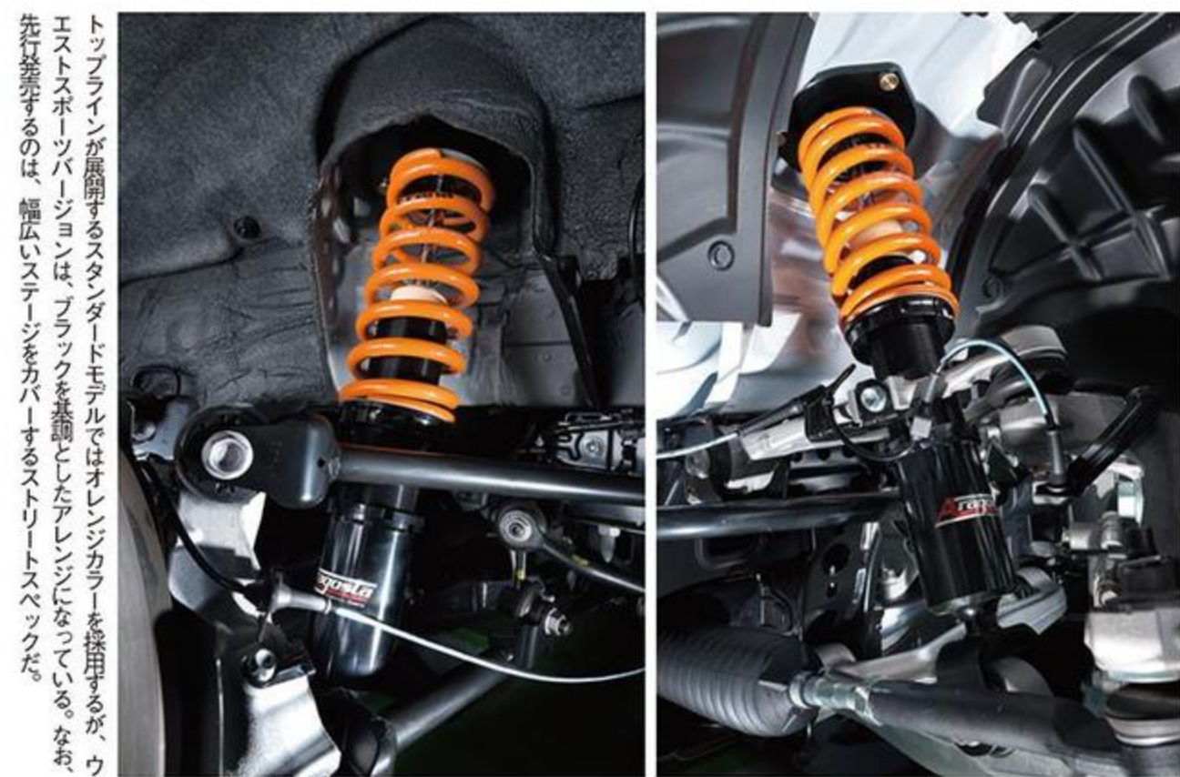
スムーズな動きを演出するため、アッパーマウントは前後にピロボールタイプを採用する。減衰力はダイヤルによって20段階の調整が可能だ。
