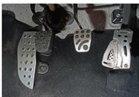
ヒール&トゥしやすいようペダルカバーをセットする。アクセルペダルは調整ができるタイプ。
