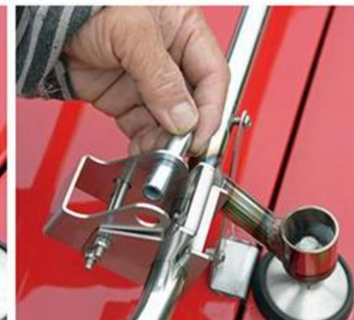
ナットは付属のレンチで締め付けるようになっている。いきなり締め込むのではなく、調整しながら取り付けていくのがいいだろう。
