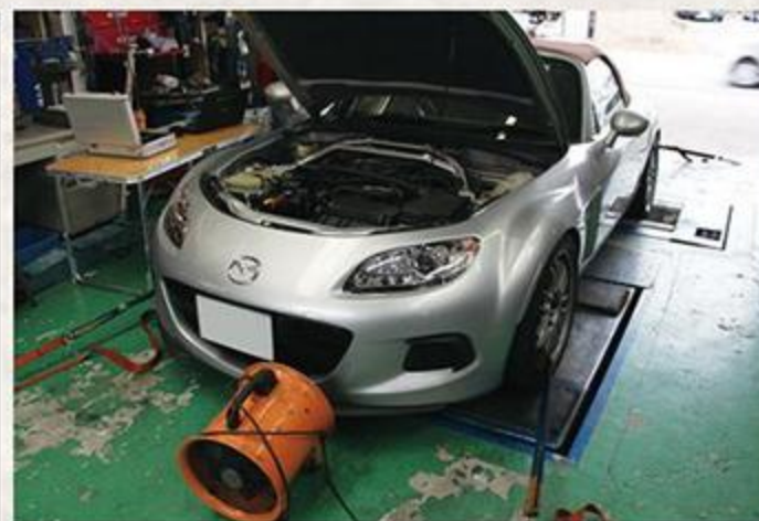
計測結果は、最高出力が198.7ps、最大トルクが21.3kgm。わずかに200psには届かなかったけど、NCの約200ps(アラ200って呼んでます)は相当おもしろい。「これはひょっとしたら86よりも速いかも」という手応えすら出てきた!
