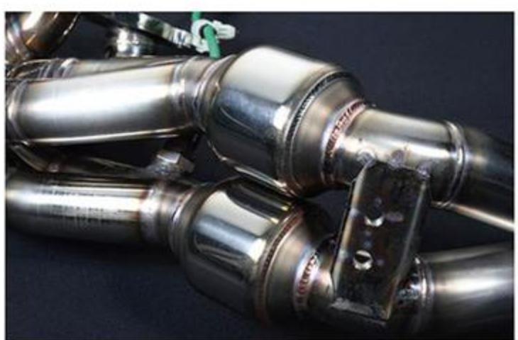
触媒ひとつで排気ガスを浄化すると密度が必要となるが、ツインとすることで浄化性能と高い排気効率が両立できる。もちろん、重量増とならないようにとことん配慮済み。
