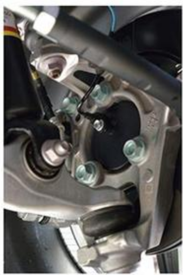
ナックルサポートはさっそく製作されていた。ストリートレベルでも効果が体感できるパーツなので、NDの挙動がどう変化するか楽しみなところ。
