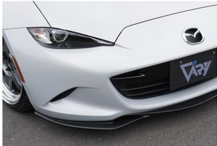
フロア下のエアガイドにつながるダクトを持つのがFRP製のポイント。価格は3万8000円(税抜)。現在エンブレム部分からエアクリにつながるバンパーダクトも開発中。
