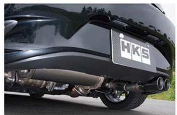
LEGAMAX Premium 未定 インパクトを与えつつもバランスのとれた最適なテールデザインを施している。パイプを切断しただけ、というノーマルとは印象がまったく違う。2010年4月以降の加速認証に対応する車検対応品。
