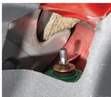
減衰調整は付属のドライバーを使うか、カバーをしたまま回転させる。右に回すと減衰を強めていくようになる。半分の8段階からスタートさせた。
