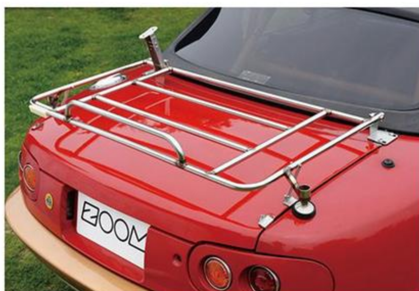
トランクキャリアはフレーム部に腐食しにくく、強度のある19φの磨きステンレスを使用している。4万5360円(税込)。
