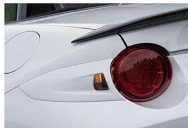
リアをスッキリとしたイメージにしてくれるため、人気となりそう。ただし、車体端からのウインカー位置が離れたようになるため車検非対応となる。FRP製2万8000円。
