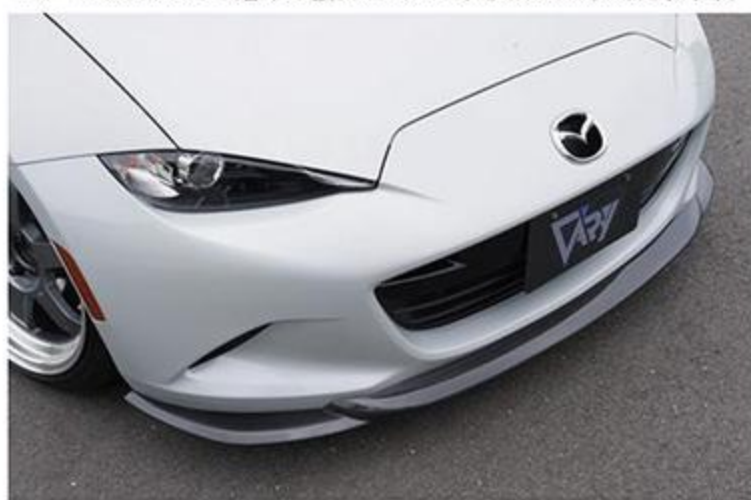
フロア下のエアガイドにつながるダクトを持つのがFRP製のポイント。価格は3万8000円(税抜)。現在エンブレム部分からエアクリにつながるバンパーダクトも開発中。
