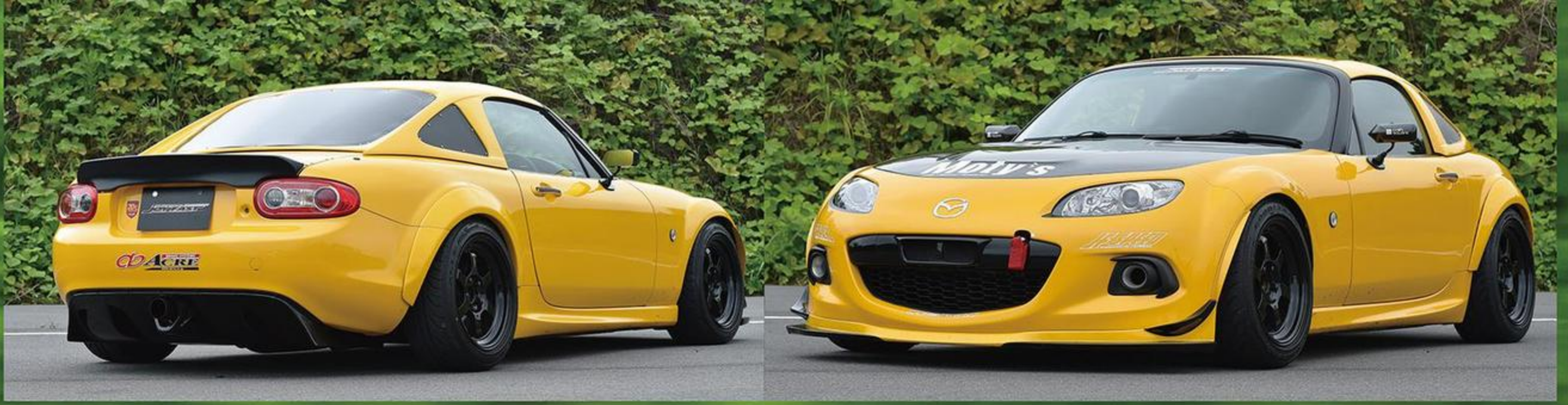
ガレージベリ製フロントグランドスポイラーに、NC純正オプションのサイドステップと、ジェットストリームのリアスポイラーをセット。車高調サスはオーリンズDFVベースのジョイファストオリジナル。
