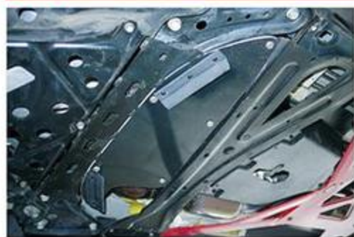
マスタースペック ダウンフォースシステム アンダーエフェクトパネル
