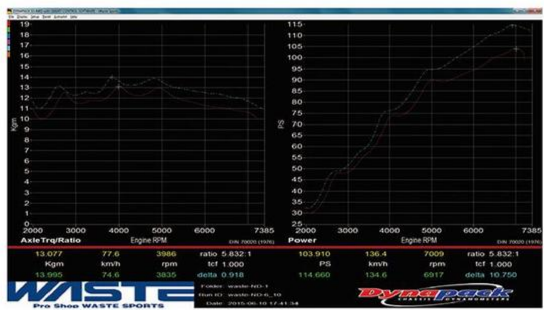
ノーマルの103.9psに対し、114.7psに向上。数値だけでなく、グラフからも低速域の立ち上がり、中間域のパンチ、トップエンドでの伸びなど、各領域で厚みと鋭さが増していることが読み取れる。
