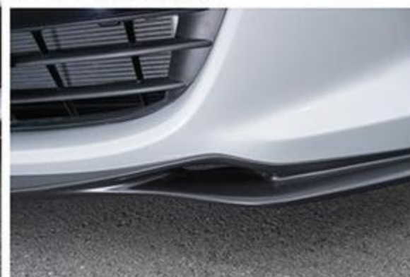
フロア下のエアガイドにつながるダクトを持つのがFRP製のポイント。価格は3万8000円(税抜)。現在エンブレム部分からエアクリにつながるバンパーダクトも開発中。
