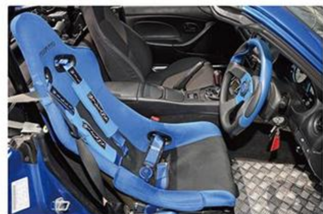
マツダスピードバージョンのブルーを基調にインテリアをまとめている。アルミマットなどスポーツカーらしいパーツを選択。シートバック部にはきちんとロールバーがセット。
