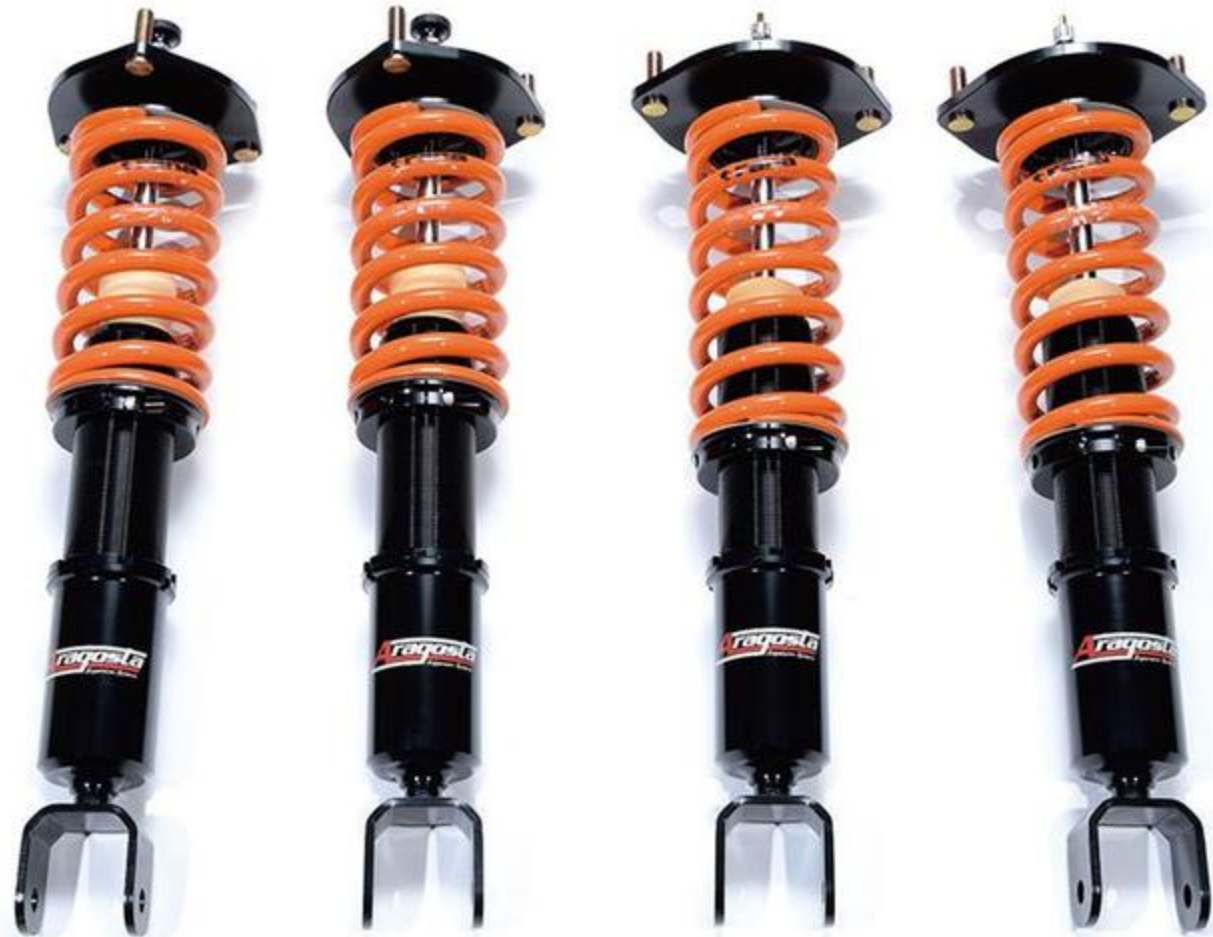
アラゴスタタイプSをベースに、シリンダー内部に特殊な表面コーティングを施してフリクションを軽減し、滑らかな乗り心地を創出するなど、トップラインが扱うスタンダードモデルでは使われていない技術も積極的に取り入れている。
