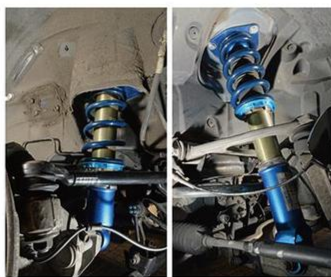
サスペンションはクスコ製で車高および減衰調整ができる。コースに応じて変更するなどして性能をフルに生かしたい。
