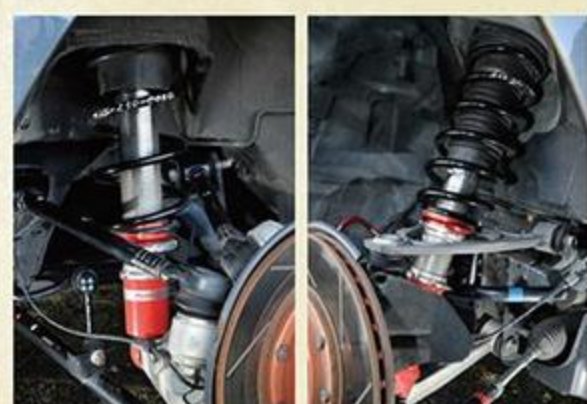
ストリートスポーツサスキット (KIJIMA-SPEC) 価格: 15万8000円 (税抜) ストロークを確保する全長調整式シェル、減衰力固定式でNC型ロードスターのために専用チューンされたモデル。他にスポーツダンパー(7万2000円)あり。
