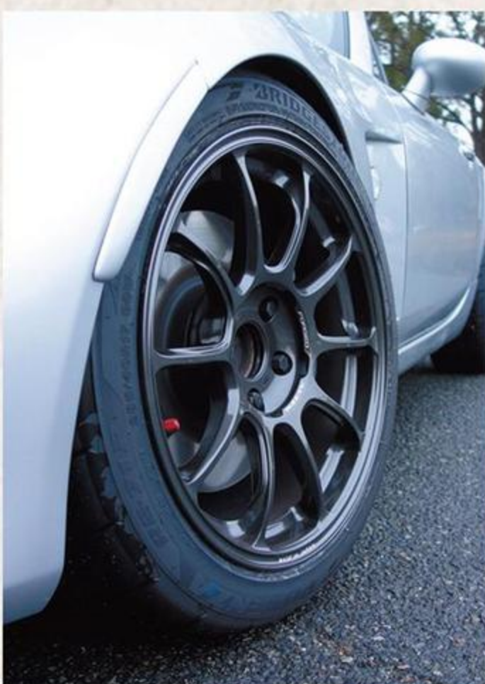
NCはリアフェンダーのツメがかなり張り出しているため、ツメ折りマシンのゴリゴリ加工。さらにリアバンパーとフェンダーの継ぎ目がストローク時に干渉しそうだったので、サンダーでカットしてもらった。
