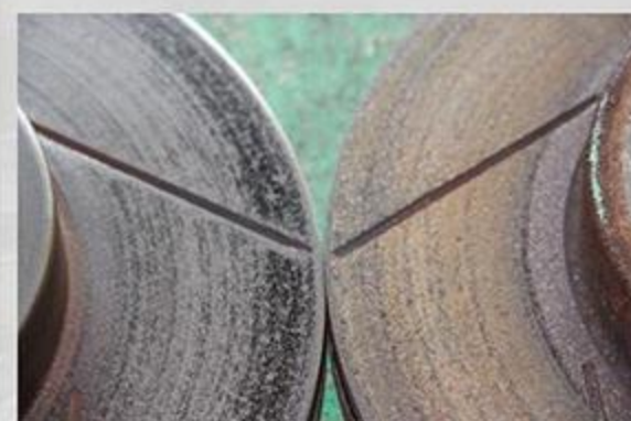
ブレーキローターはそんなに減っていないが、当たりに偏りがあるようだ。研磨すればまだ十分に使えるので、ローター、パッドともにオリジナルを使う。
