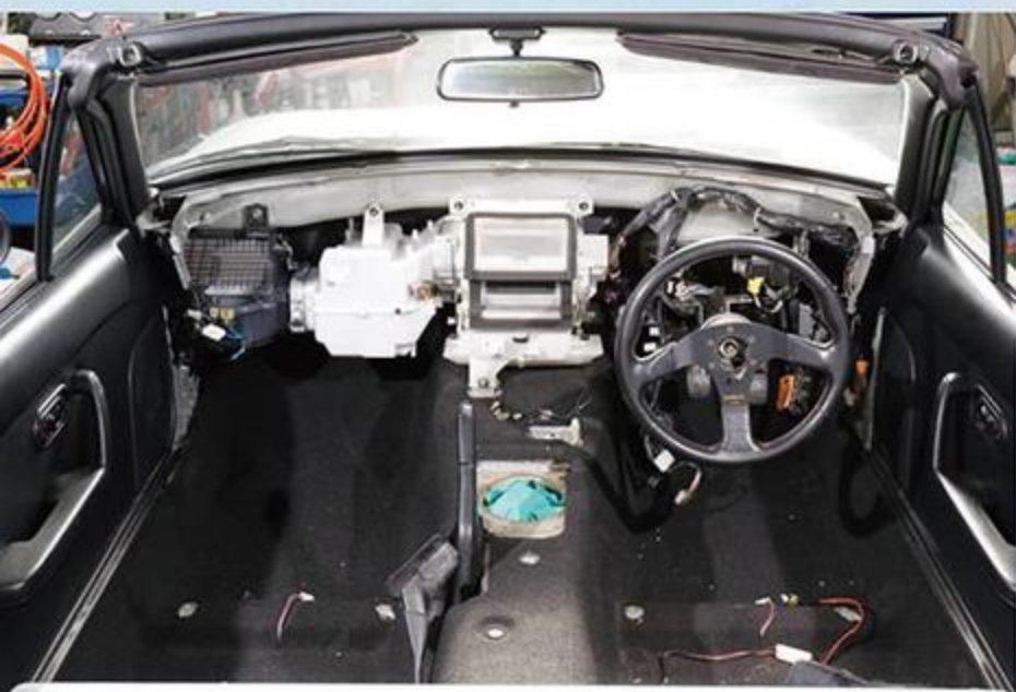
高圧パイプのレイアウトもNAとNBでは異なるため、NAに取り付けられるよう取りまわしを変更。圧のかかるパイプはテストも行う。
