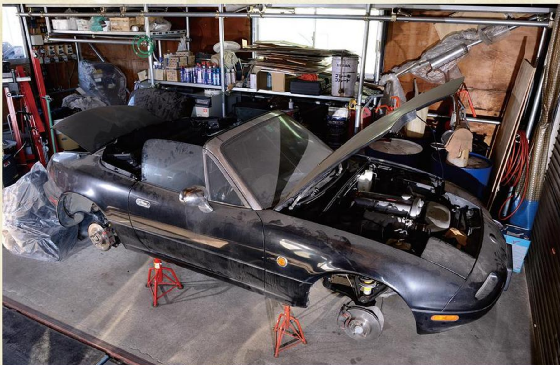
前後ともショックはビルシュタインの純正品を使用。ブレーキローターも純正品、パッドはアクレを使用する。
