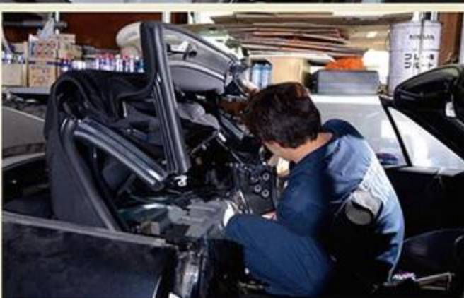
幌も純正品を使用。カラーチェンジなどの要望があれば社外品も用意すること。内装を張り替えていないと最終的に組み付けられないので、ひとまず仮留めだ。
