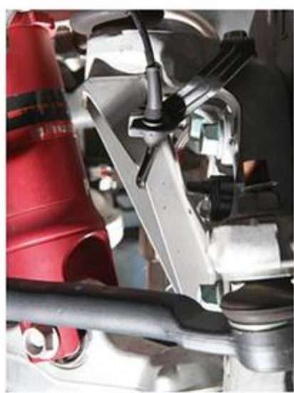
減衰調整は前後ともに20段式となっているので、サーキットを走りたい人のクルマも、十分に に対応できるキャパシティを持つ。
