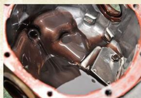
ギアがこすれて発生した、細かい金属粉がオイルに混じっている。状態によってLSDのオーバーホールはメニューが変わってくるのだ。
