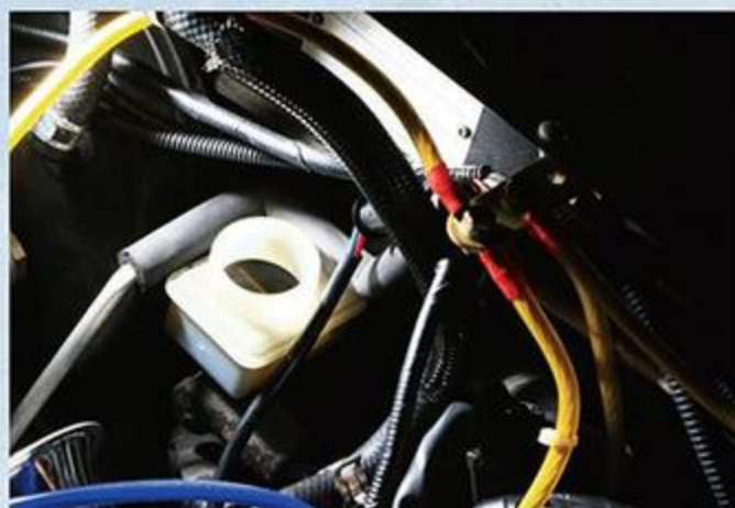
マスターシリンダーが劣化するとシールからフルードが漏れる。定期的により深く点検することがトラブル予防につながる。
