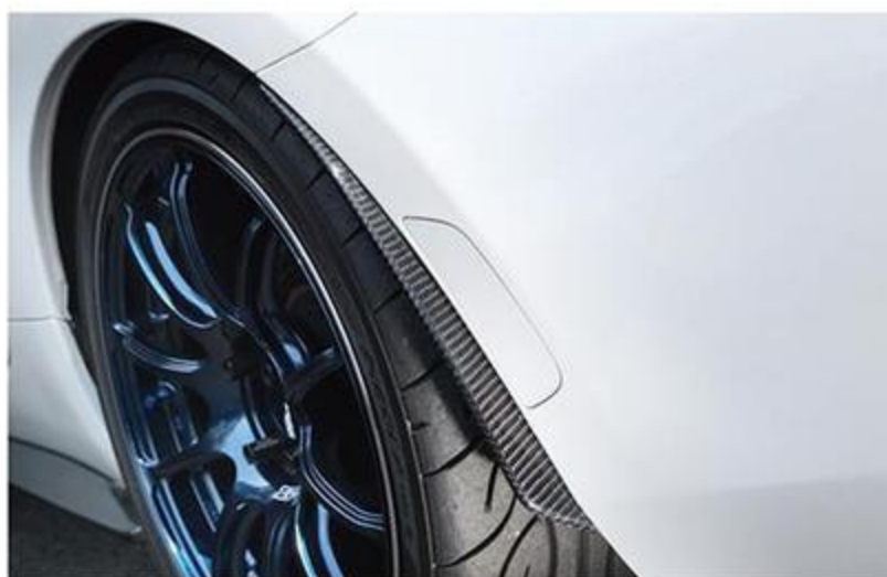
デザイン性も意識しながら、リアタイヤのハミ出しをカバーするために考案されたリアフェンダーエクステンション。小石のハネ上げなどを防ぐほか、泥よけ的な効果もある。
