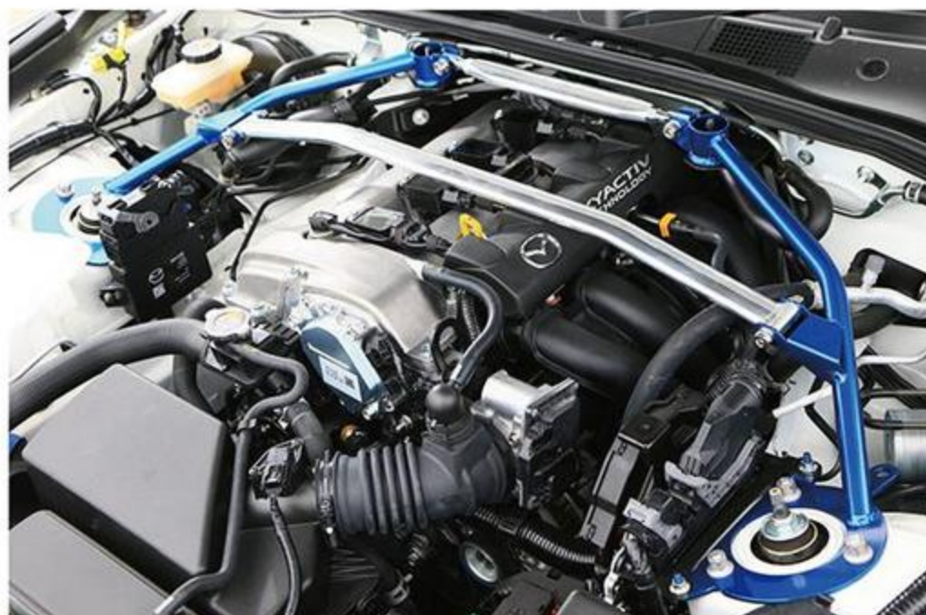
試作ラムエアインテークを組み込み、吸気効率を高めたエンジン。バルクヘッドとタワーを結ぶシャフトはスチール、左右を直結する2本のシャフトはアルミで製作するなど、タワーバーは適材適所で材質を使い分ける。
