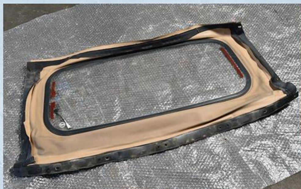
リアスクリーンはガラスなので、アクリルのように白濁する心配はない。カラーバリエーションもあるのでボディカラーに合わせたい。
