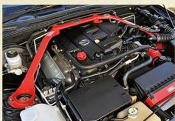
ストラットタワーバー フロント 価格: 2万8000円 (税抜) エンジンルーム内で映える鮮やかな朱色のストラットタワーバーは4点支持式。フロントサスマわりの剛性をアップしてステアリングレスポンスを向上する。
