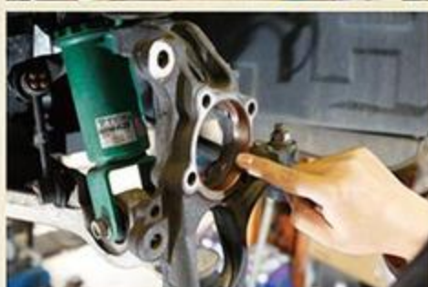
ハブを新しくして回転させると、スムーズに回転するのがわかる。オーナーの増田さんも試してみて、実感したようだった。
