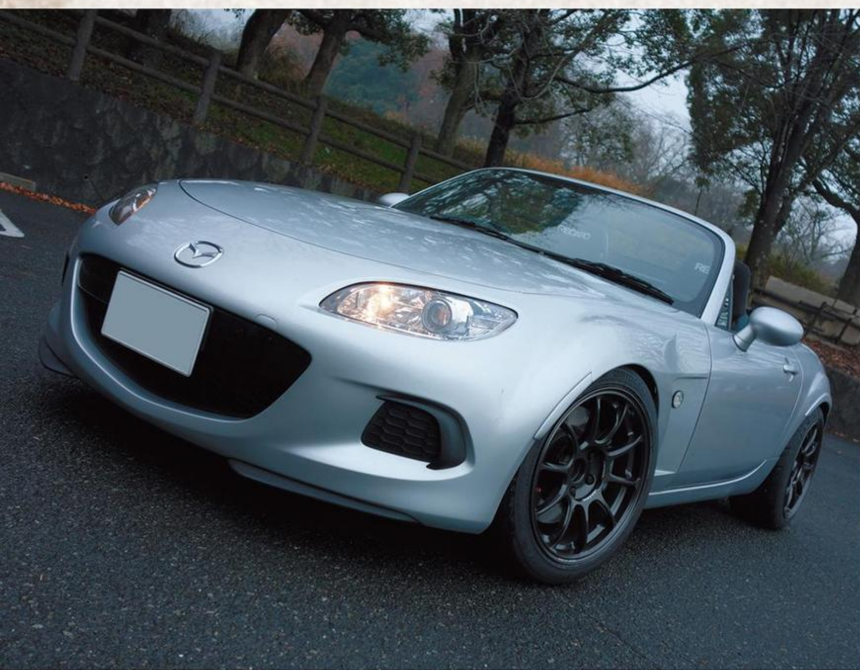
ボルクレレーシングZ E40は9J×17+40。フロントは10mmワイドのインテグラル神戸製フェンダーとのマッチングも絶妙。フェイス3のコンケイブディスクは、17インチとしてはかなり深く落ちていると思う。
