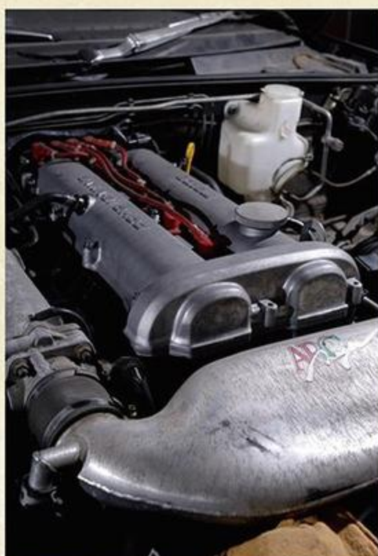
エンジン関係もノーマルを基にリフレッシュさせるために、インジェクターやプラグなどを交換。
