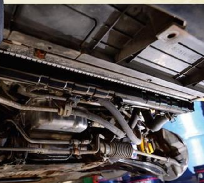
燃料ラインやブッシュ、インジェクターなどを交換。通常の経年劣化でも交換すべき部類のものだ。
