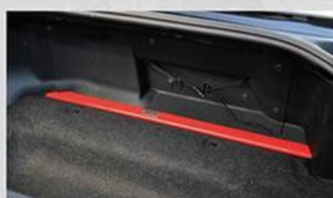
フロアクロスバー リア 価格: 2万1000円 (税抜) リアのサスペンション取り付け部のフロアを左右で橋渡しすることで剛性アップ。ストラットタワーバー装着時のように追従性を向上。
