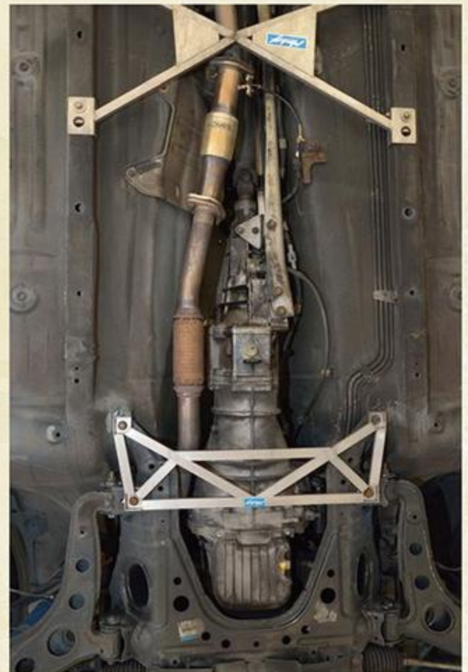
ミッションケースはそ のままでも、中身が NCになることでシフ トの入りがよくなる。 また2ℓエンジン搭載 車用とあって高回転域 にも対応する。
