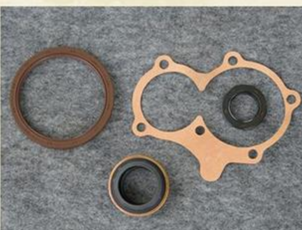
せっかくミッションを降ろすのだから、ショートパーツは最 低限でも新品に交換しておきたい。工賃を浮かせたいなら、 このときパーツ代はけちらないのが得策だ。
