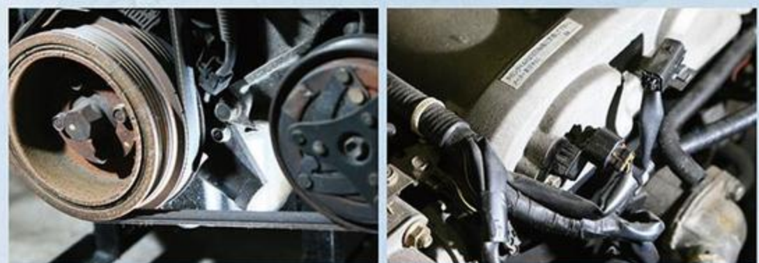
カムアングルセンサーとクランク角センサーを搭載するNBでは熱の影響を受け、これらのセンサーにトラブルが発生しやすい。
