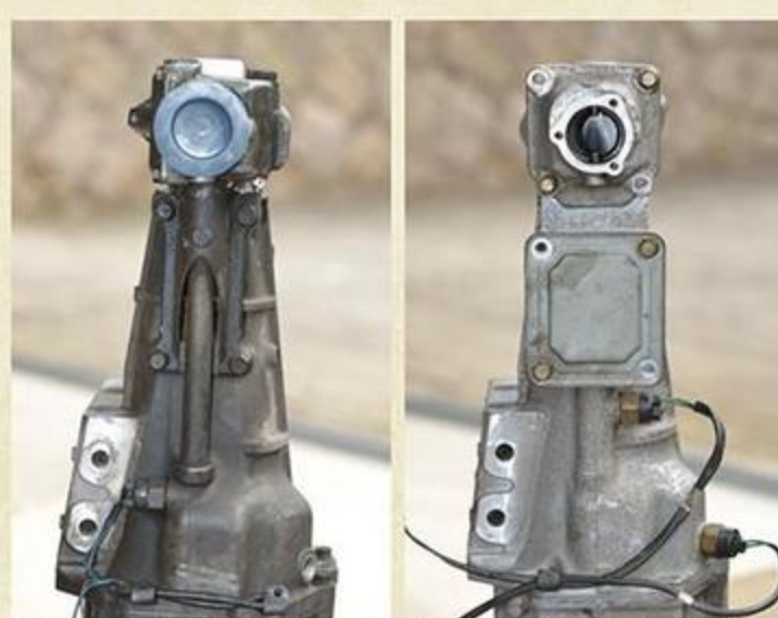
左がNAで、右がNBの6速ミッション。プレートがあったような付け 根下にはバックギアの誤作動防止装置があるため形状が異なる。
