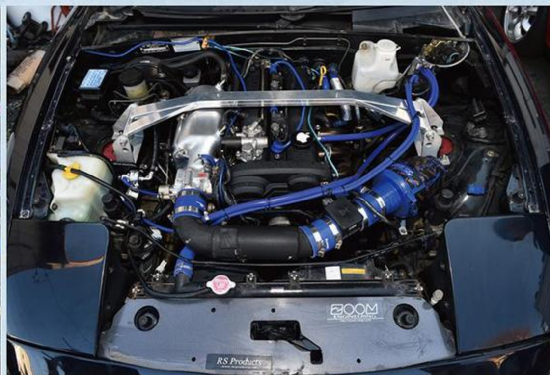
このスロットルもアメリカ製のものを取り寄せてセットしたもの。ビッグスロットル加工によりスロットル径が拡大している。見た目もいい。
