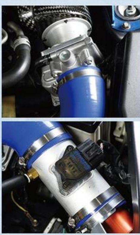
スロットルは大径70φに変更し、さらに72φまで拡大。エアフロ部も80φに拡大し、流量アップに合わせたリセッティングを施す。
