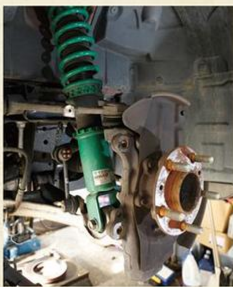
回転させるとさびなどの発生により、動きが渋いのがわかる。10万km走行していても、ガタツキのない車両もあるという。
