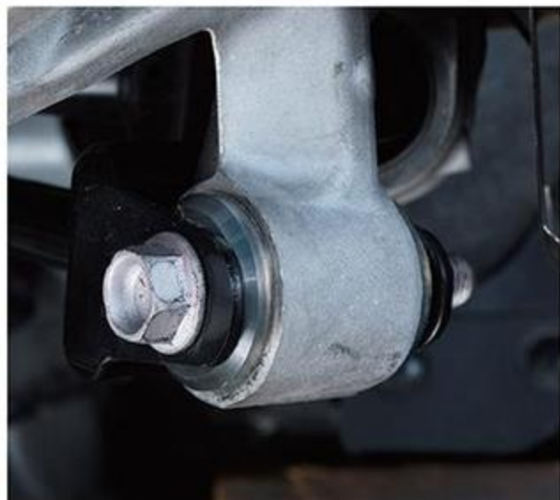
適度な柔軟性を残しながら、純正よりも硬度アップを図ったオリジナルトーコンブッシュ。スポーツ走行時の過剰なトー変化が抑えられ、リアの安定性が一気に高まる。
