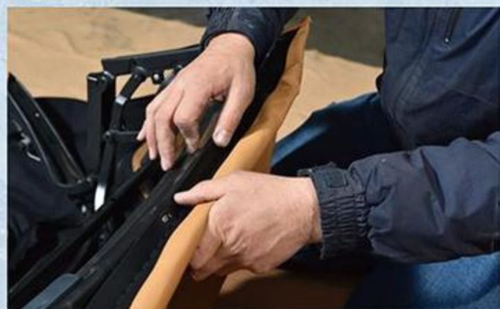
骨組みに布を巻き付けていくのだが、何台もの作業実績があるので手慣れたもの。今回の生地は初使用だが、問題なく付きそうだ。
