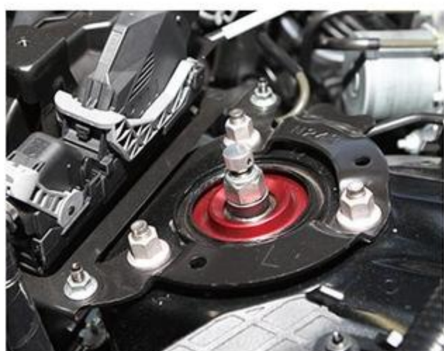
減衰調整は前後ともに20段式となっているので、サーキットを走りたい人のクルマも、十分に に対応できるキャパシティを持つ。
