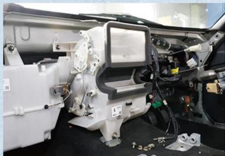
マルハでは室内ユニットのパーツも用意している。ヒーターユニットの位置関係がNAとNBで異なるので、取り付けには工夫が必要。
