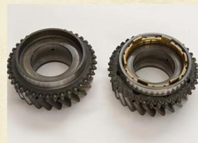
ひどい状態だと歯が欠けているようなこともある。年式によ り精度や耐久性は確実によくなっているので、高年式車の部 品が流用できるなら使わない手はない。
