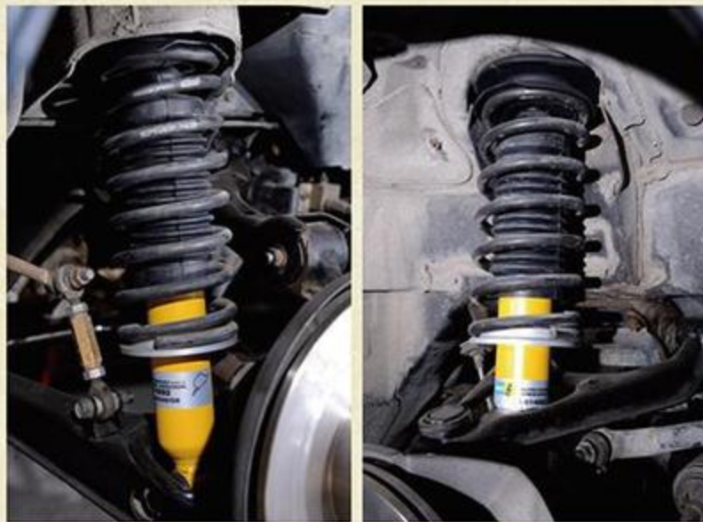
前後ともショックはビルシュタインの純正品を使用。ブレーキローターも純正品、パッドはアクレを使用する。
