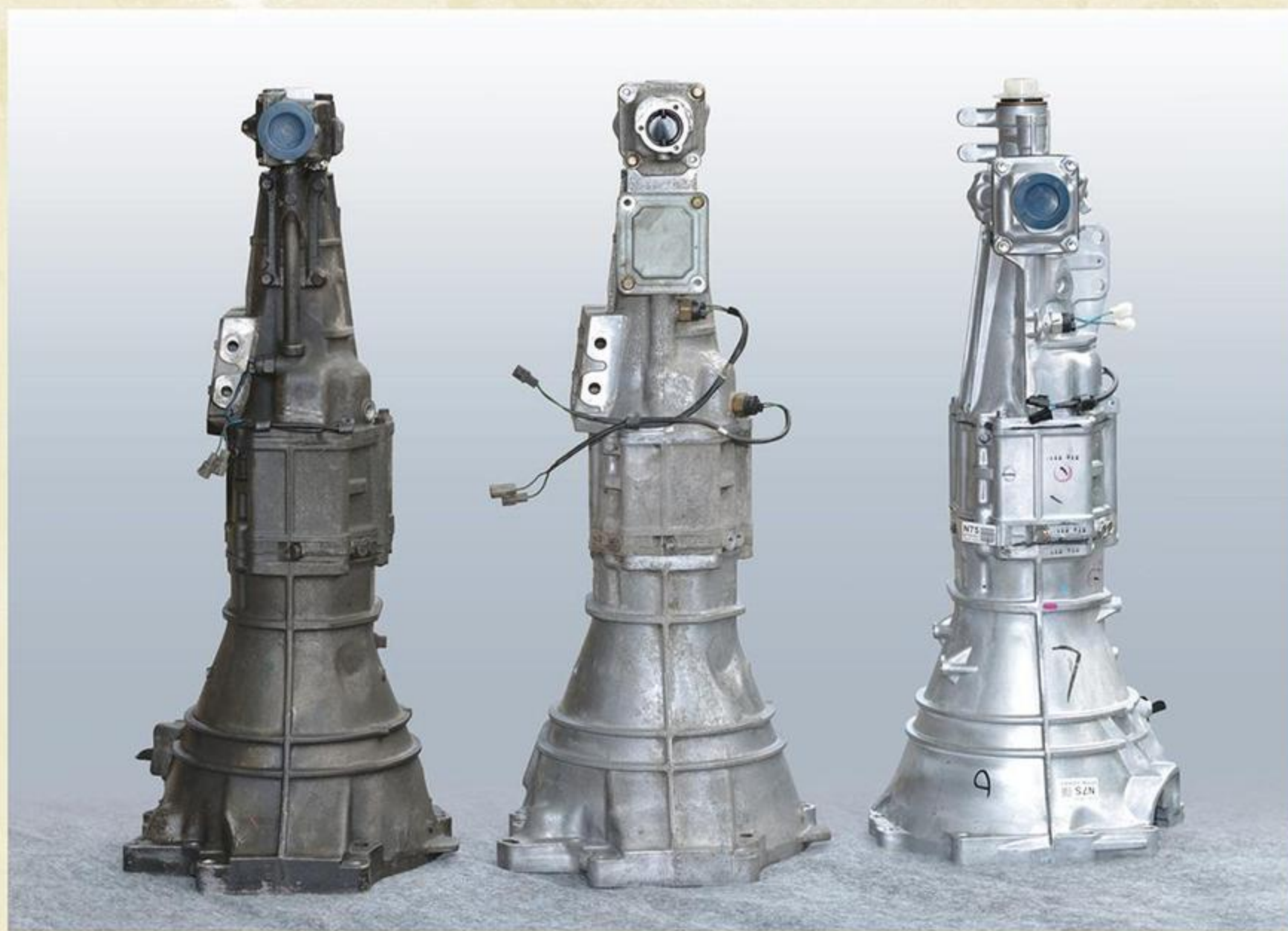
ミッションの中身だけをケース内に流用するが、6速は不可 なのでNB6速のオーナーは5速にする覚悟がいる！ 流用 すればシフトフィールは断然向上する。
