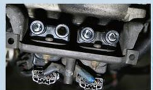
BP-ZE搭載車両の点火コイルのトラブルでは、2気筒1セットでの交換が可能。しかし、念のためにすべて替えておくのが無難だ。
