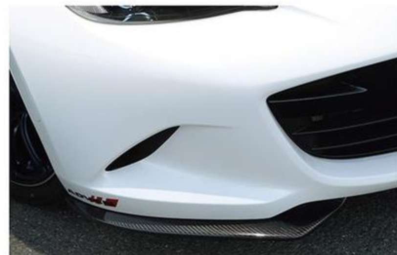
高速域でのダウンフォース獲得のために企画されたフロントショートリップ。その一方で、コンビニの段差をクリアできるだけのロードクリアランスも十分に確保している。
