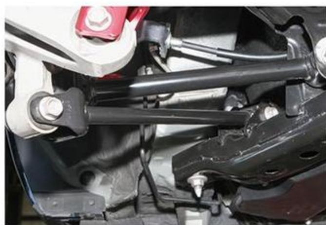
リアのトーコンキャンセルピロブッシュをセッ している。NDはサスペンションを入ると、ノ ーマルとは挙動が変わるのでこうしたアイテムで 補正をやる。
