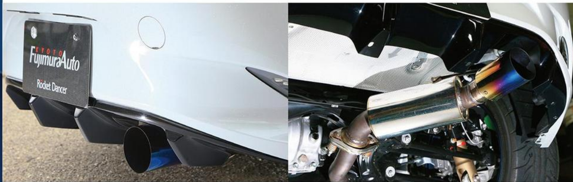
低価格でシンプルなルックスを構築し、サウンドの心地よさにもこだわったジェントルサウンドマフラー。オールステンレスとチタンテールを用意する。
