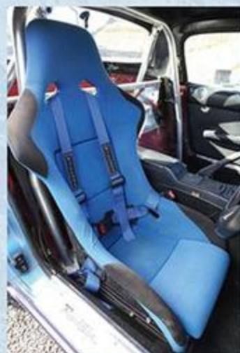
サーキット用と割り切っているので、オリジナルフルバケットシートに交換し、助手席、内装などはすべて取っ払われている。
