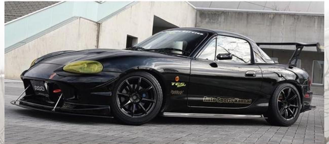
NBに装着させたのはグラムライツブランドの「57Transcend」だ。スポークの落ち込みは、製品単体で見たのと、実際に履かせたのでは違って見える。旧車スタイルによく似合う。
