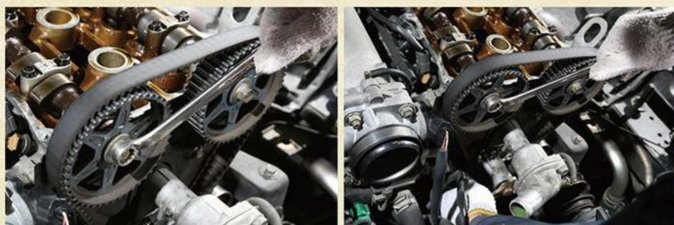
タイミングベルトの交換はここまでバラすので、ついでに行える作業がいくつかある。その都度工賃を払うよりも、一挙に作業してしまうほうがダンゼンお得。"ついで"作業で賢くリフレッシュしたい。
