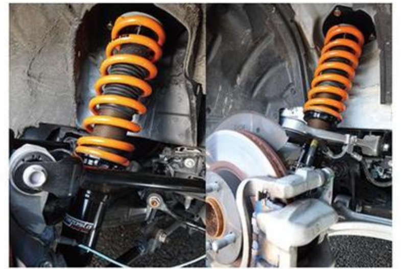
アラゴスタベースのサスペンションは、NAからラインアップしているアイテムだけに、造詣は深い。ベストなバネレート、減衰力でND5RC用も期待どおりの足まわりができてくるはずだ。
