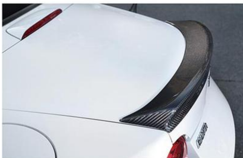
リアの安定性を高めるリアリップ。幾度もテストを繰り返し、オープンでもクローズドでも優れたダウンフォース効果を発揮することができるフラップ形状を導き出している。
