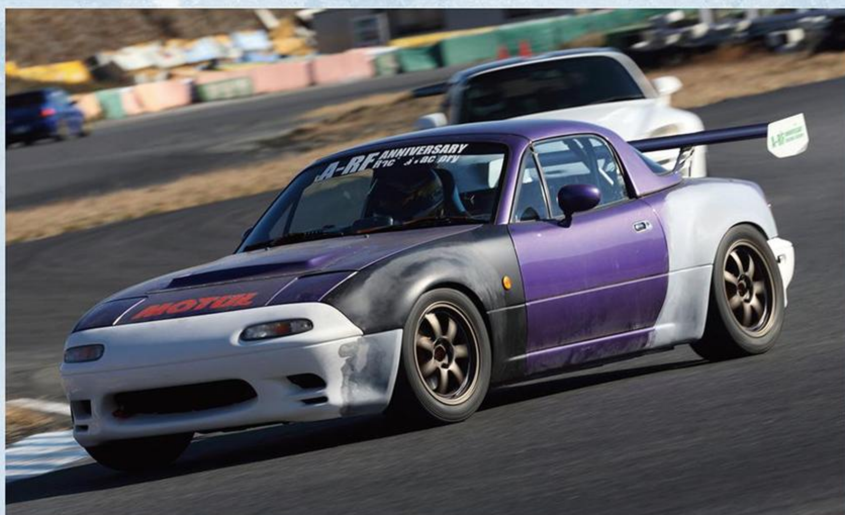
NOSを搭載しているにもかかわらず、普段乗りもできるくらいマイルドさで仕上げています。どっかんテストではなく中低速からパワーが盛り上がりいくので扱いやすいのだ。
