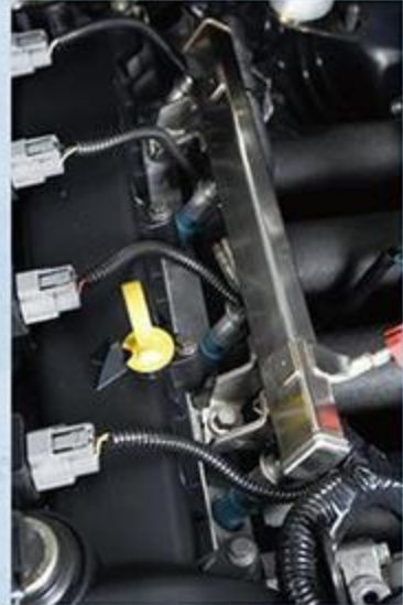
エンジンは海外製パーツを積極的に組み込んだL3改2.3ℓで、カーボン製サージタンクの存在が際立つ。インジェクターはパワーエンタープライズの380ccを使用する。
