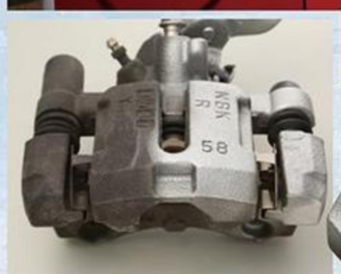
ブレーキキャリパーにサンドブラストをかければ新品同様に。
