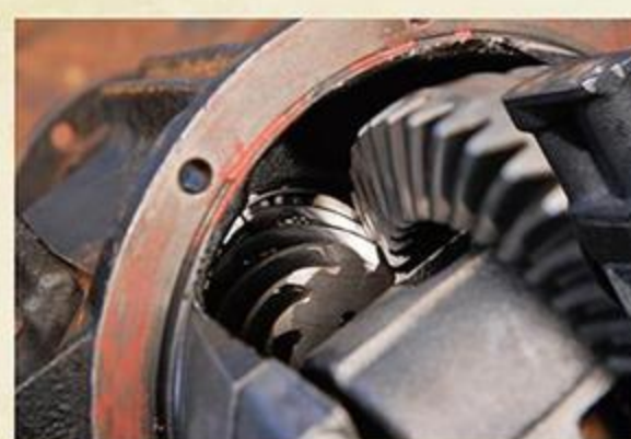
ギアの歯が欠けてしまっているのわかるだろうか？NA6CEだとデフ容量が小さいためベアリングがいつまでも壊れるので要注意。
