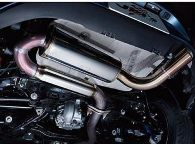
加速騒音規制に対応しながら、心地よいサウンドの創出にこだわったN・ZEROSベックマフラー。ピックアップのよさと伸び感を強調し、21kgの軽量化にも貢献している。
