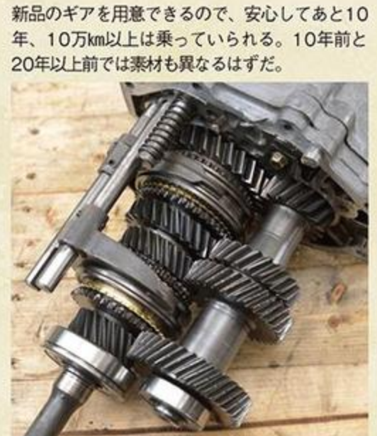
ミッションの中身だけをケース内に流用するが、6速は不可 なのでNB6速のオーナーは5速にする覚悟がいる！ 流用 すればシフトフィールは断然向上する。
