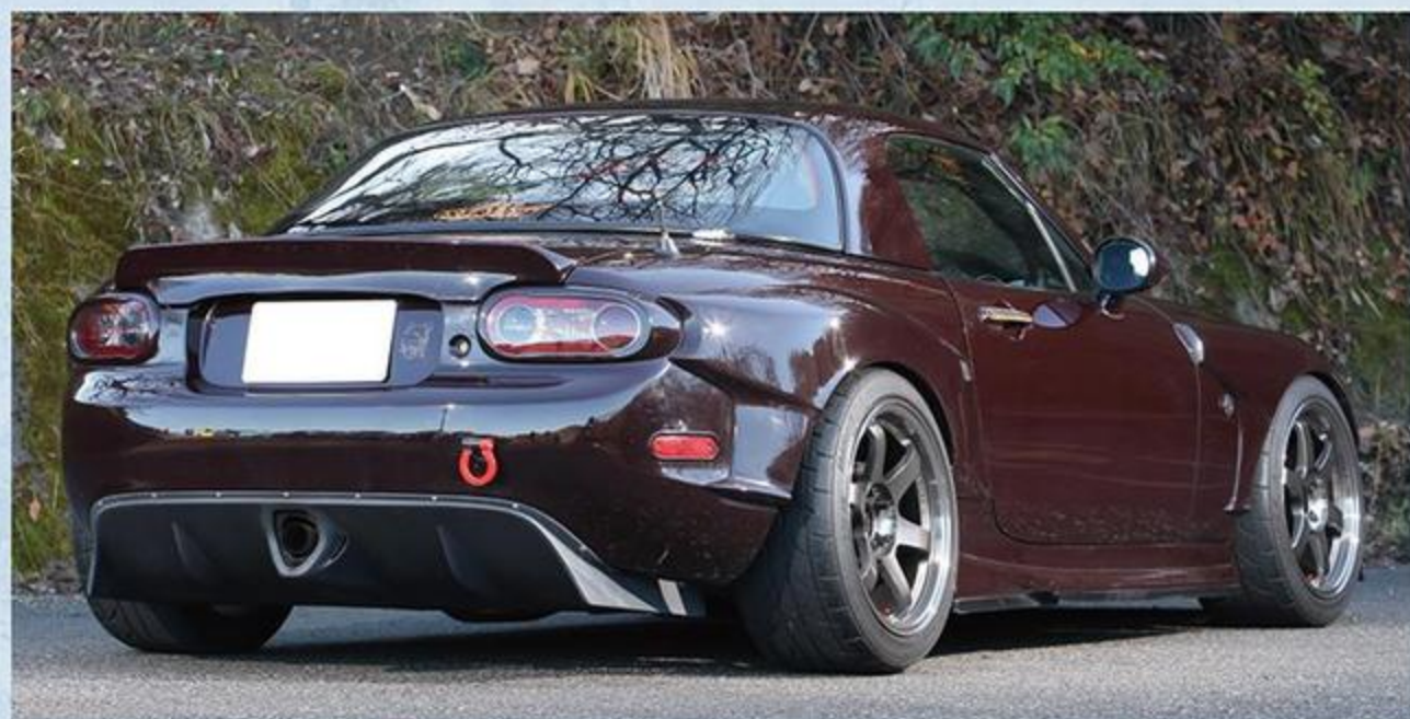
センター出しマフラーとリアディフューザーでNCのリアビューを別物に見せる。おとなしい印象だったNC型だが、ここまでアグレッシブにまとめることでこれまでにない新たな魅力を生み出す。
