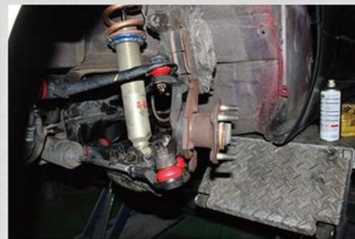
サスペンションはオーリンズベースのオリジナルで、リアは別タンク式を採用する。減衰は20段あるので、走行ステージで変化を楽しめる。組み込んだプッシュが目立つ。
