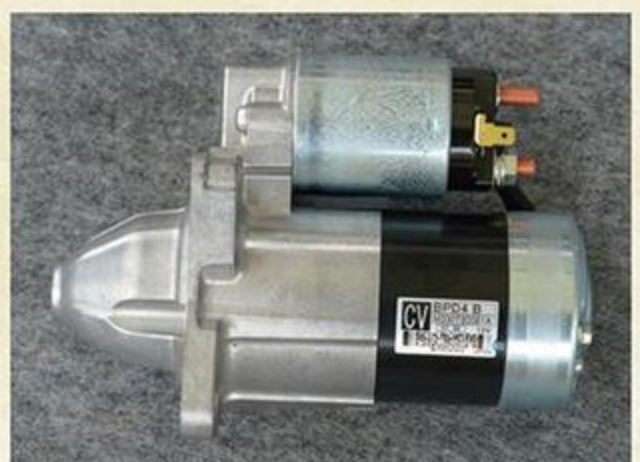
セルモーターもこの際だから交換しておけば長く乗り続けら れる。これはNB用で、NA用よりも小さくそして軽いから○ なのだ。ただしNBのミッションケースでないとは不可。
