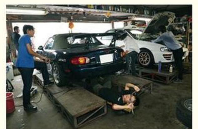
倉庫隣にあるガレージのピットは、クルマをリフトアップする方式ではなく、下に潜って作業ができるようになっている。
