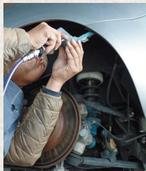
リアにはインテグラル神戸のワイドフェンダートリムをボディ同様に塗装し、装着した。タイヤのハミ出しをカバーし、ツメ折りで売れたフェンダーをこまかく目的があるのだ。
