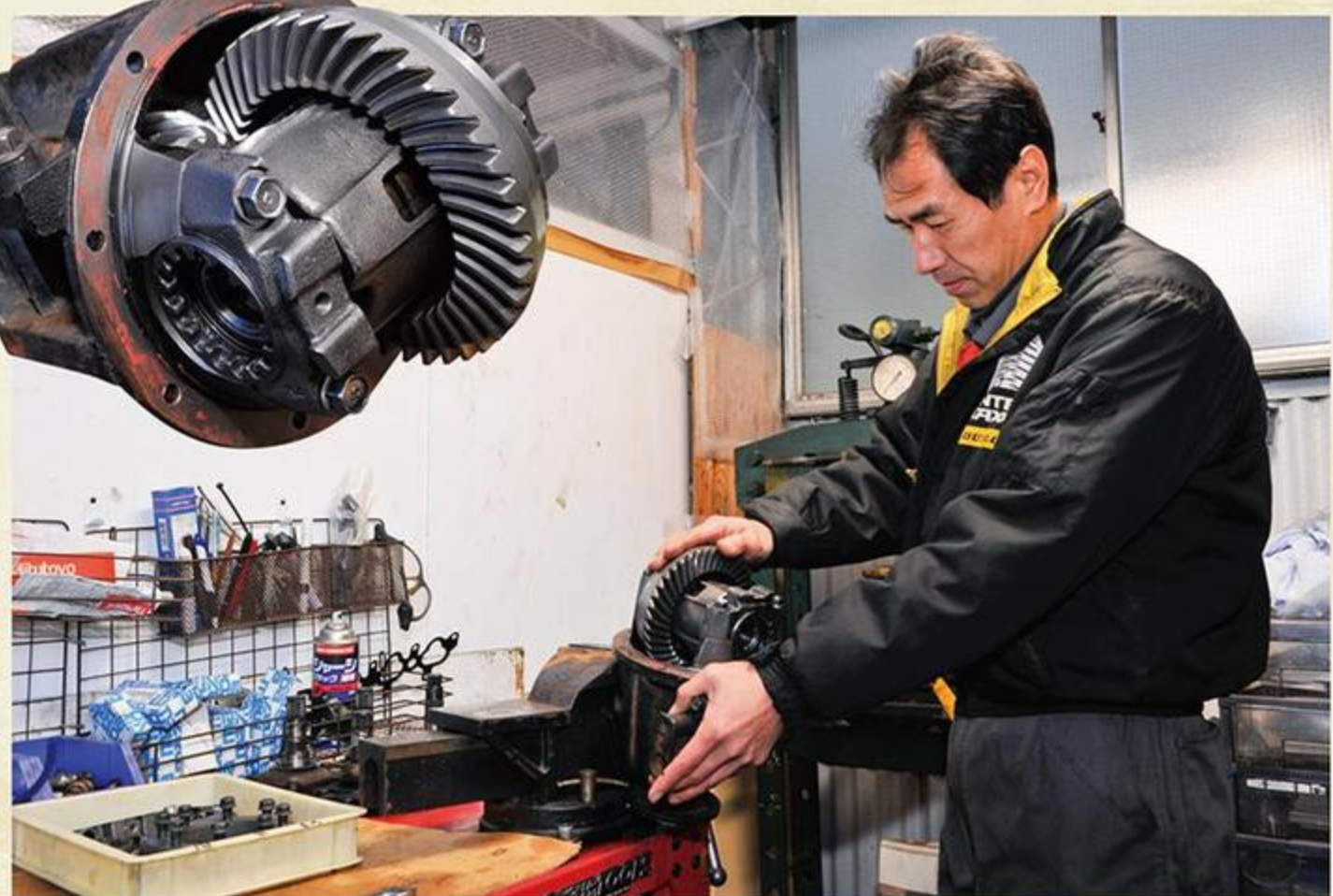
ギアの歯が欠けてしまっているのわかるだろうか？NA6CEだとデフ容量が小さいためベアリングがいつまでも壊れるので要注意。
