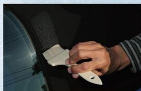
初めての加工なので、たっぷり塗る。本来は2回分はある容量だが、1回で塗りきるようにぜいたくに使った。
