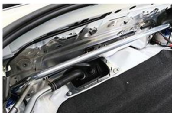
パイプの径や長さのセレクトにより、抜けとトルクを両立した試作マフラー。リアタワーバーは、軽量のアルミ中空シャフトと強固なスチールブラケットで構成。
