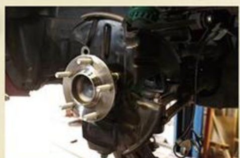
回転させるとさびなどの発生により、動きが渋いのがわかる。10万km走行していても、ガタツキのない車両もあるという。
