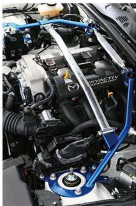
試作ラムエアインテークを組み込み、吸気効率を高めたエンジン。バルクヘッドとタワーを結ぶシャフトはスチール、左右を直結する2本のシャフトはアルミで製作するなど、タワーバーは適材適所で材質を使い分ける。
