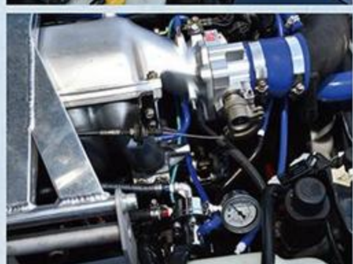
このスロットルもアメリカ製のものを取り寄せてセットしたもの。ビッグスロットル加工によりスロットル径が拡大している。見た目もいい。
