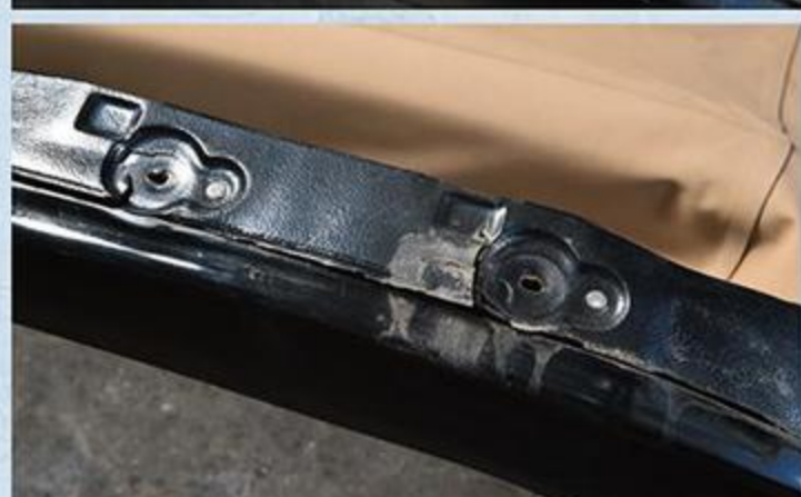
レインレールはNA初期から格段によくなっている部分。硬く割れやすいものから、軟らかい柔軟性のあるものに変更されている。
