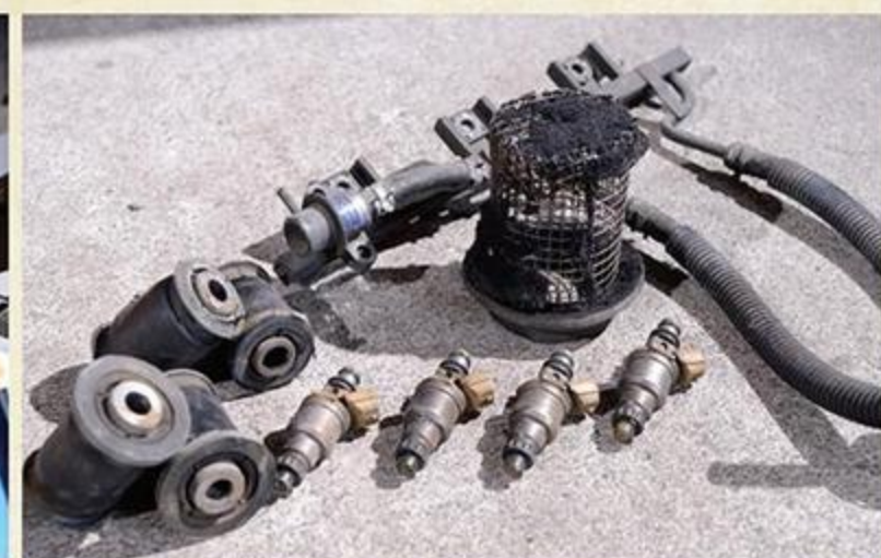
燃料ラインやブッシュ、インジェクターなどを交換。通常の経年劣化でも交換すべき部類のものだ。
