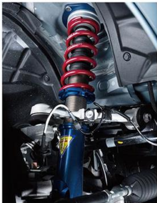
適度な柔軟性を残しながら、純正よりも硬度アップを図ったオリジナルトーコンブッシュ。スポーツ走行時の過剰なトー変化が抑えられ、リアの安定性が一気に高まる。
