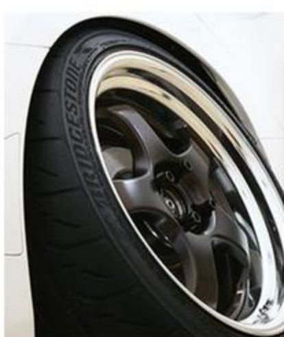
ホイールは2ピースのマイスターS1Rを選び、サイズは8J×17+30に設定。さらにスベサーを追加し、ツメ折りとキャンバー調整で、絶妙なツライチ感を演出する。
