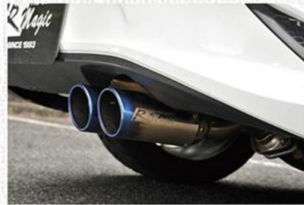
タイコ部は職人による手作業で作られているこだわりの品。テール部分は76.3φでチタン仕上げ。バンパーのアルミに沿ったフィット感が魅力だ。
