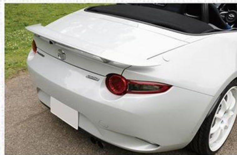
ハーフタイプながらもフロントフェイスに動きを与えるデザインが光る。そしてリアには控えめなウイングをセット。ハイマウントストップランプも内蔵している。リアカメラ内蔵タイプを現在開発中という。
