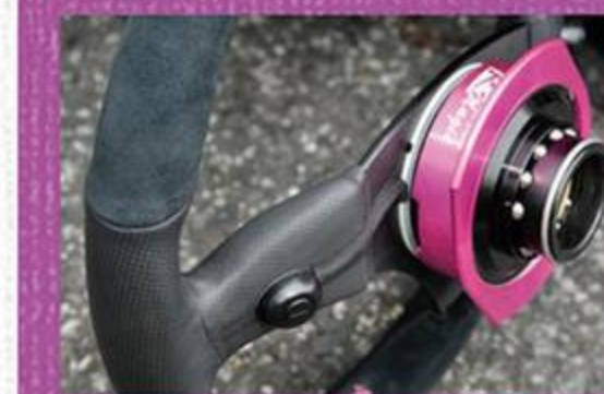
このボタンをプッシュすると、ウインカーが3回点滅するようになっている。コーンタイプのステアリングに取り入れた技だ。
