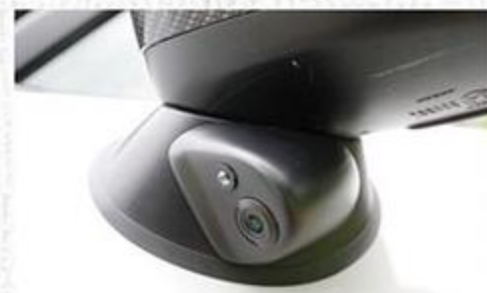
サイドカメラキットをセットすると、モニターに死角が表示される。背の低いボールに付かず……なんてミスを未然に防ぐことができる安心装備。
