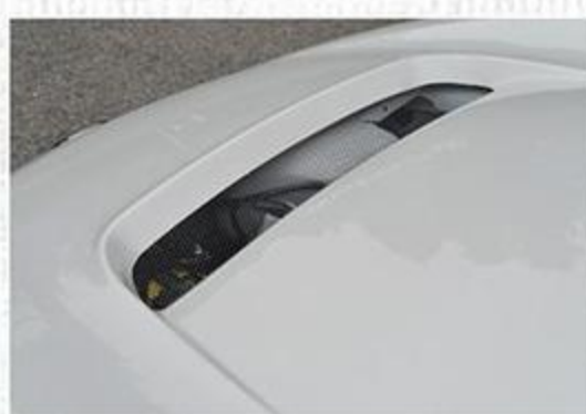
エアロボンネット(8万円税別)は雨天走行用にレイナガードも付属。外すと冷却効率が向上し、外さなくても軽量化という面での装着効果が高い。
