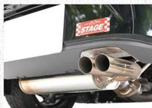
ステンレス製のオリジナルマフラー。レーシングセンターパイプも用意されており、本格的なサーキット仕様に対応している。
