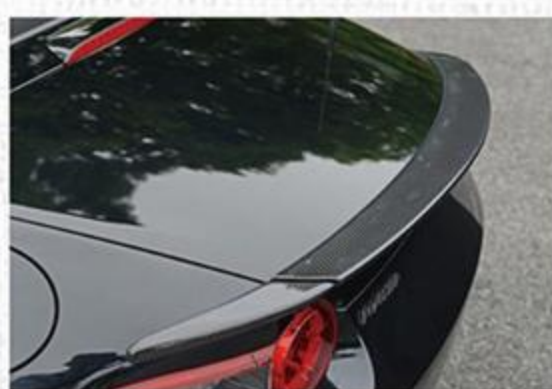
3ピースで構成された、伸びやかなシルエットをつくり上げるトランクスポイラー。写真はカーボン製で、このほかFRP製も選べる。
