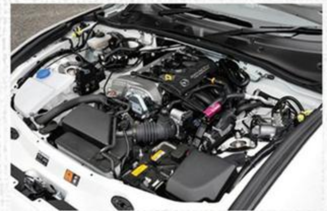
ノーマル然とするエンジンルームには、クランク室の内圧を下げる「T-REV」(別件で説明)を装着するのみ。コンピュータチューンで十分楽しめる。
