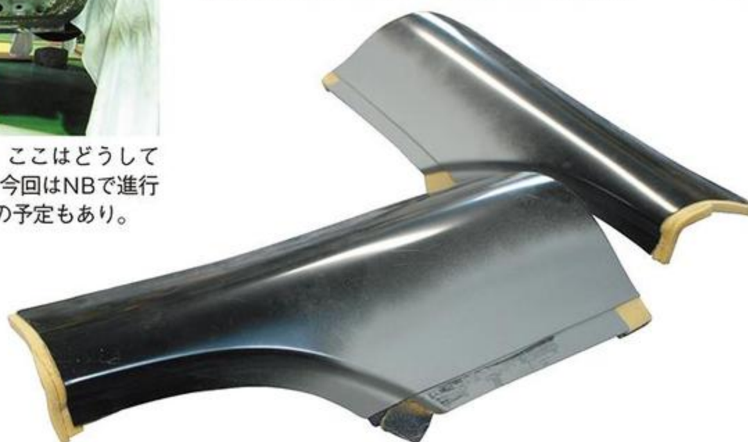
溶接で取り付けるのではなく、差し込んで取り付けられるように「耳」を付けるなど、試行錯誤しているところ。
