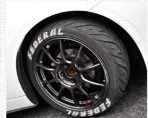
「ボクはフェデラーだから」というようにタイヤはフェデラー製を採用。595RSはスポーツ走行向けで、サイズは215/40・17としている。
