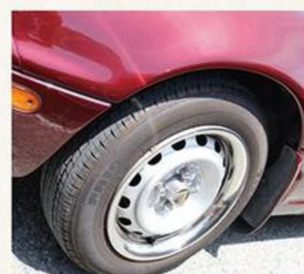
ロードスター純正ではなくデミオ用の純正鉄ホイールを履く。ユーノスのセンターキャップはプリンのカップで自作して装着。
