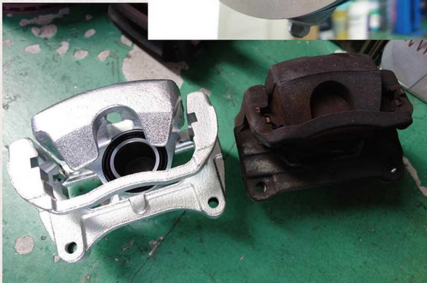
NC純正(右)とRX-8純正のキャリパーを比較してみると、明らかにRX-8純正が大きい。若干重くはなるが、それ以上に容量アップのメリットは見逃せない。
