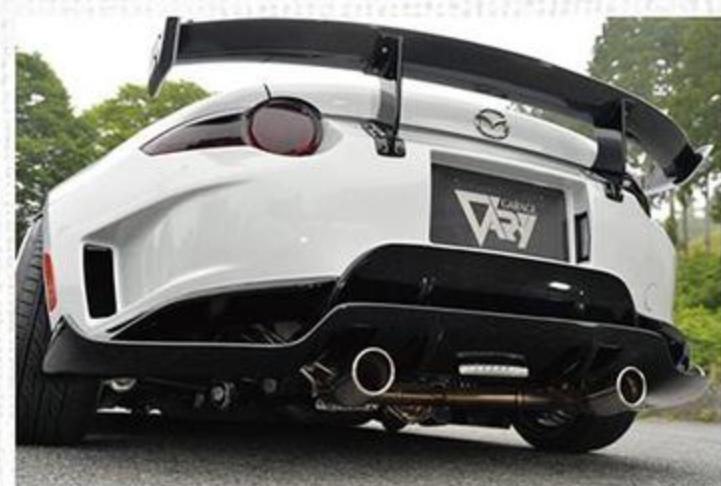
はつきりとしたダクトを持ち、デフューザー構造のリアバンパー(8万円税別)にスリットスポイラー(6万円税別)をセットすることで2重構造となり、ダウンフォースも向上。
