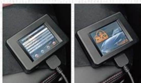
ターボキットに付属のAVOパワープラス。OBD IIからECUへとアクセスすることで、純正データと5マップを記憶させることができる。
