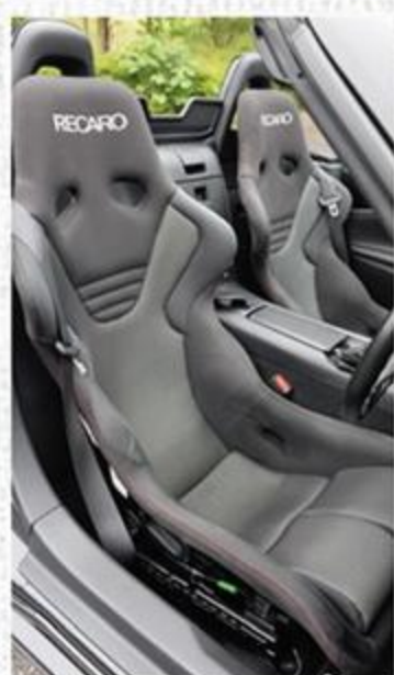
レカロ製のTS-Gを2脚セット。デモカーはドラボジ作りを最初に行なった。高い目線もこれで解消。クルマとの一体感も増す仕様だ。
