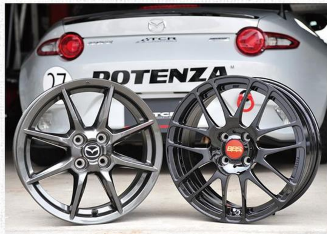
純正とはいえ、軽量化に特化したモデルだけあって重量ではBBSにも負けていない。しかしサーキットを視野に入れた剛性面は他を圧倒する。
