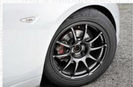
アドバンRS IIは8J×16インチ、インセットは+38を、タイヤはRE71Rでフロント205、リア225/45-16を選択した。
