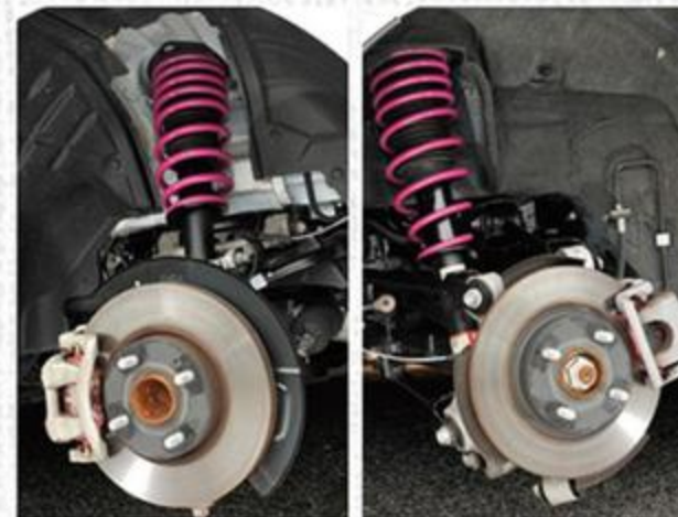
足まわりはノーマルダンパーにオリジナルスプリングを組み合わせている。ノーマルの良さを生かしながら、ローダウンフォルムを実現する。
