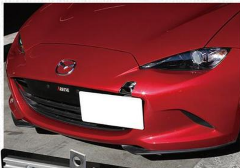
フロントバンパー開口部の中央にセットされたナンバープレートを好みの位置に移設できるNDオフセットナンプラスター。
