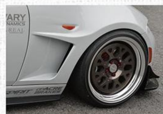
フロントフェンダー(10万円税別)はFRP製。3mmワイドになるだけでステアリングはフルに切れる。ホイールはワーク・シーカー(17×8J O/8.5J)。
