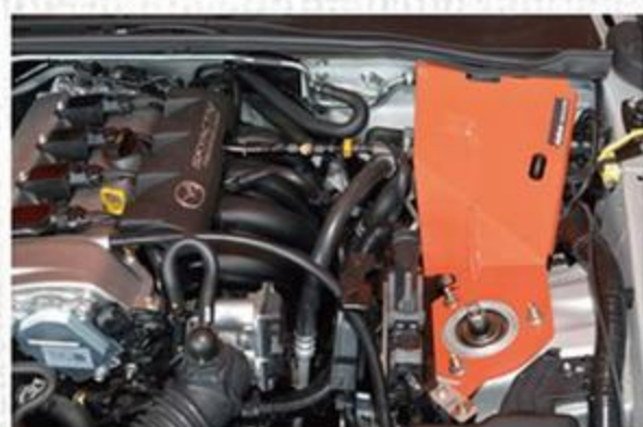
フロントショック取付部(アッパーマウント)からバルクヘッドを一体化するシャキットプレートは税込3万2400円となっている。
