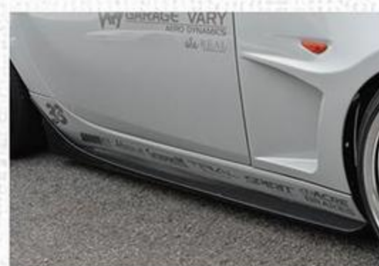
サイドステップ(5万円税別)もグライドリップと同様、デモカー用は一部縫織りカーボン製だが市販品はFRP製。底面とボディを流れる空気を整流する。
