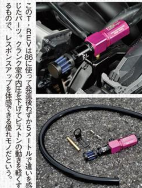
この「T-REV」は86に比べて空気を吸い込むからメトルで違いを感じたパーツ。クランク室の内圧を下げてピストンの動きを軽くするもので、レスポンスアップを体感できる優れたモノだ。
