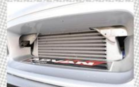
インタークーラーはARC製。ガレージベリーのバンパーの開閉口に合わせて取り付けられる。オイルクーラーも装備する。
