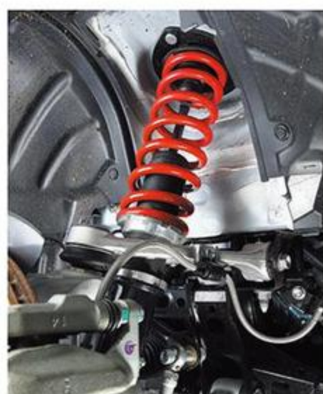
12段の減衰力調整が可能で、好みの乗り味を実現するヒルクライムダンパーRS (21万6000円)。デモカーはピロボール式トーコントロールアームも装着する。
