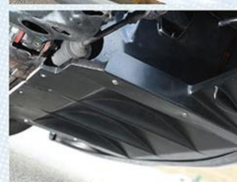
フロントの下面に装着されたアンダーパネルは、エアの整流とダウンフォースの向上に有効。ブレーキダクトも装着されている。
