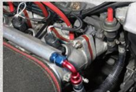
装着されている燃料インジェクターは、BP-VE純正ではなくデミオ用。8針が新しく燃料の霧化にすぐれているのだ。
