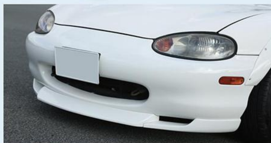
新型のフロントリップスポイラー「クラウル」は、フラットな下面とダクト形状がアクセントで、シャープなマスクを演出する。
