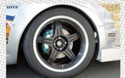
タイヤはアドバンA050(255/40R17)。ホイールはヘセルの9J。ブレーキは前:4POT、後:NB2用を流用する。
