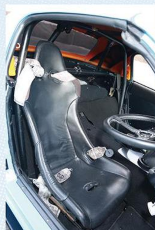
コニのフルバケット1脚のみで完全にレース仕様のインテリア。ナルディステアリングは跳ね上げ式ボスで装着している。
