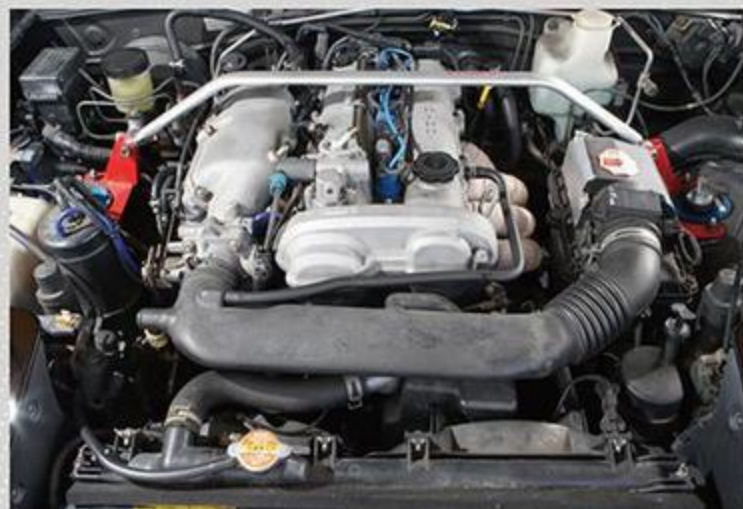
いい出物があったので、エンジンはNBのBPIに換装している。ラジエターや油圧装置はきちんと交換されている。
