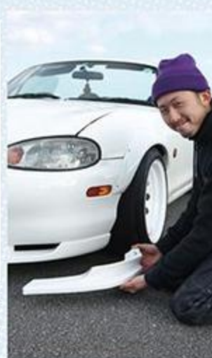
新型リップスポイラーの最大の特徴が、センターと左右の3ピース構造を採用している点。センターピースだけでもカッコよさそう。
