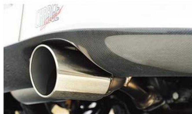
メインパイプ径60φ、テールエンド103φのHITMAN NDマフラー (6万1560円)。気持ち良く走るためにサウンドにもこだわった。
