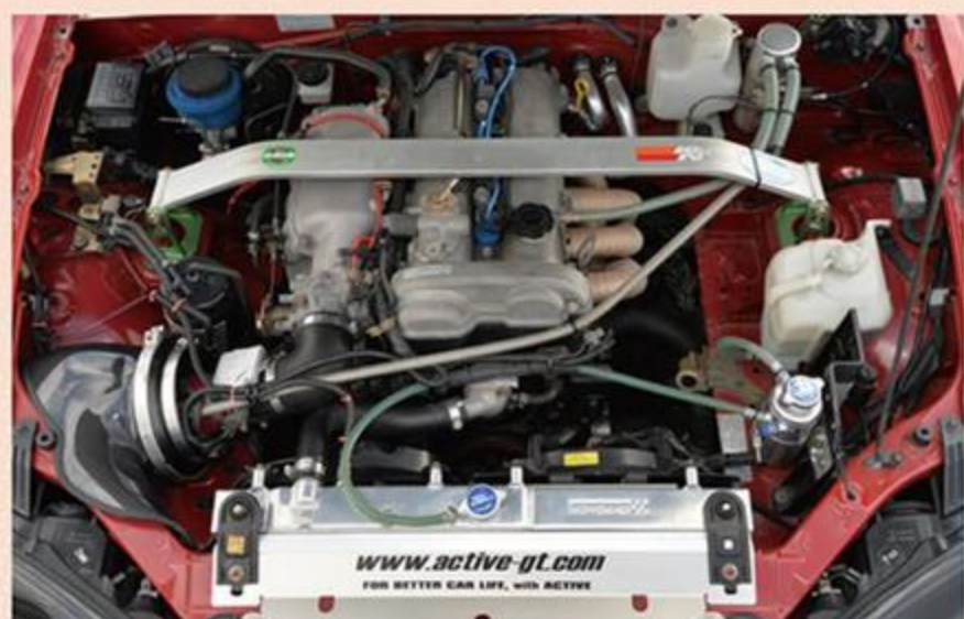
ボンネットはエンジンルーム内の熱を逃がすガレージベリ製アウトレットダクトを備えている。熱によるトラブルを未然に防ぎ、エンジンの能力を引き出す。
