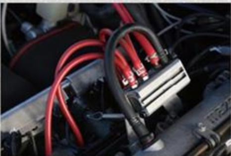
4連スロットルにはバキュームタンクを装備して、コールドスタート時やエアコン作動時のアイドリングアップなどを制御している。
