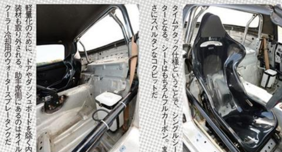
メーター類以外、不要なものは取り外されている。ただし、ダッシュボードはロードスターを象徴するものなのでそのまま残す。
