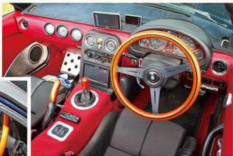
補強のアルミパネルは自分で型紙を作り、アルミをカットして取り付け。小さなポイントでも十分な補強となっているようだ。
