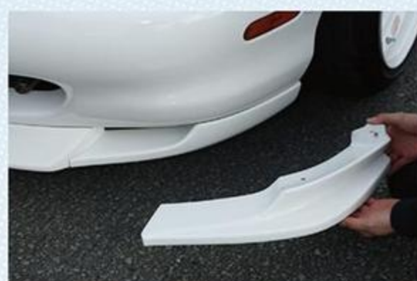
新型リップスポイラーの最大の特徴が、センターと左右の3ピース構造を採用している点。センターピースだけでもカッコよさそう。
