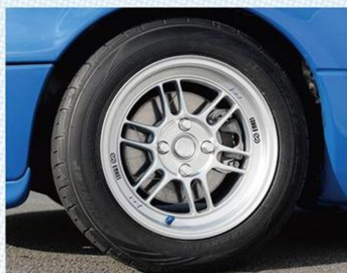
オリジナルのエンケイ・RPF1(7J×14+28mm)に、ダンロップ・DZ102の185/60R14を履かせる。ブレーキはNA8用に換装。
