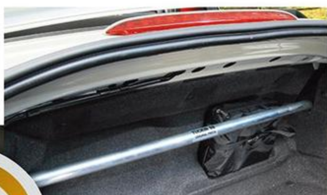
スチール製ブラケットとアルミ製シャフトを採用したリアタワーバー (1万5120円)。サスペンションの性能を引き出しリアの追従性を高めて一体感ある走りを実現。
