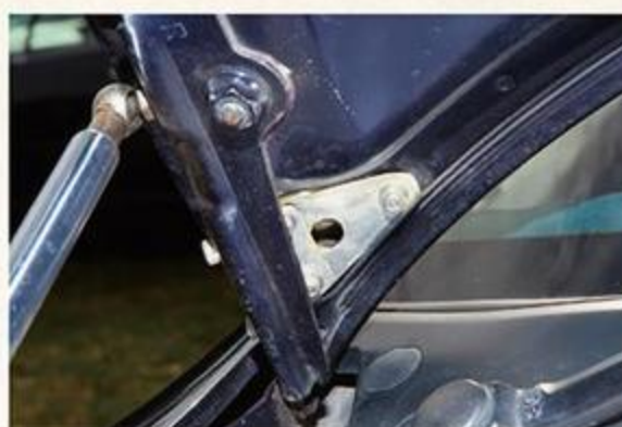
補強のアルミパネルは自分で型紙を作り、アルミをカットして取り付け。小さなポイントでも十分な補強となっているようだ。
