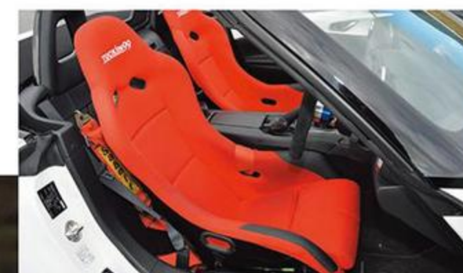
オリジナルのフルバケットシートRS (ND用6万1020円)はローポジションを徹底追及した仕様(ノーマル比約35mmダウン)。
