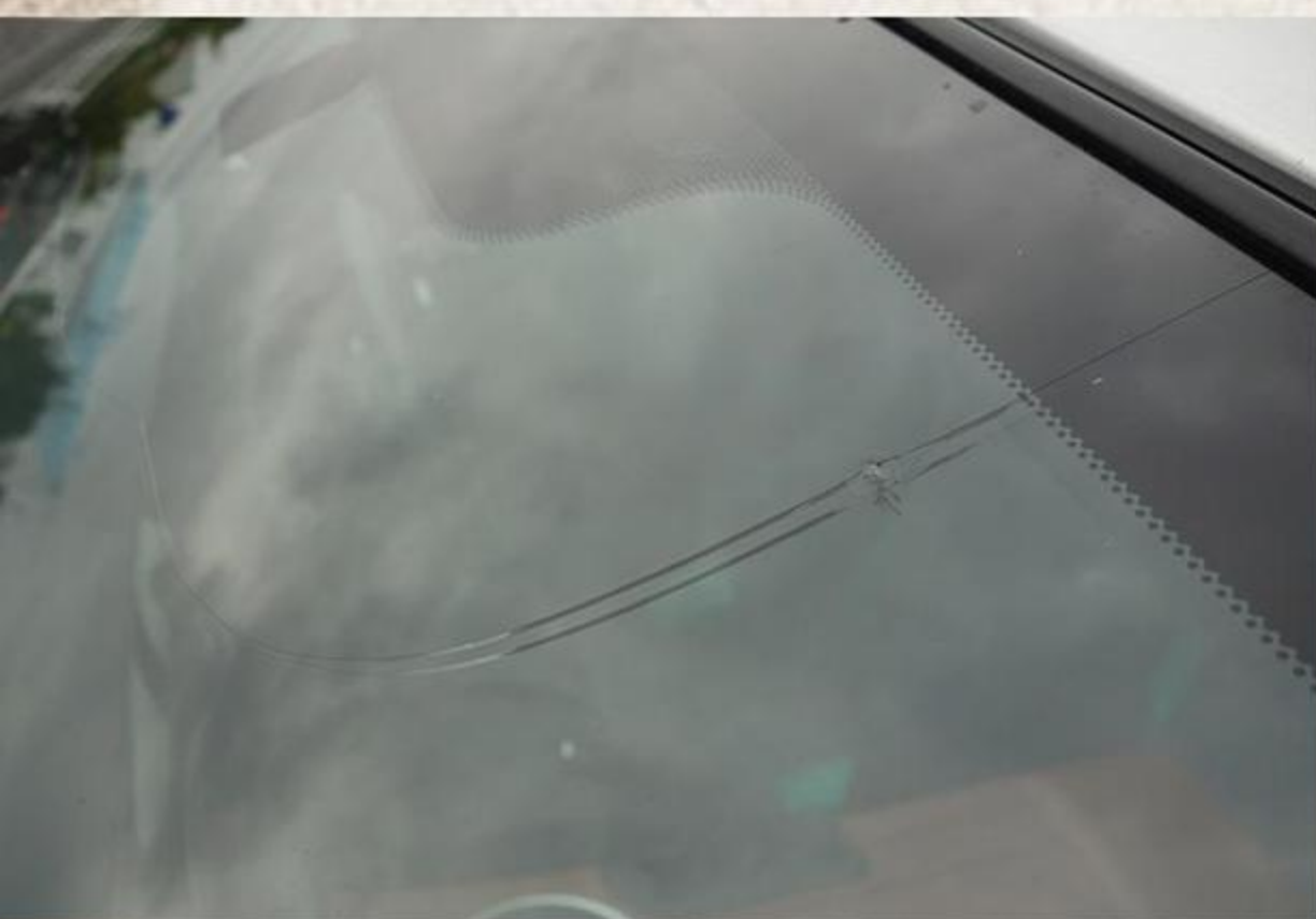
写真ではわかってもらえるが微妙だけど、実際はかなり衝撃的なヒビ割れです。これまでも小キス程度なら、見て見ぬふりをしていたけど、さすがに今回はそういうレベルではなく、ガラスを入れ換えることにした。
