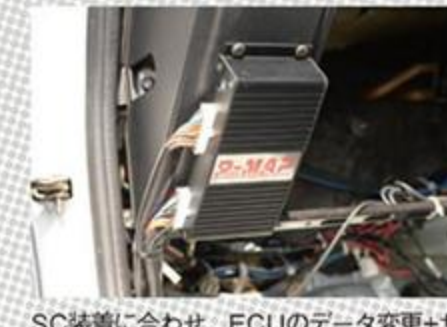
SC装着に合わせ、ECUのデータ変更+サブコン(P-MAP ST)を装着。インジェクターは540ccに容量を増やしている。
