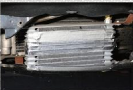
パワーアップしたエンジンは発熱量も増大。トラブルを防止してパワーのタレを防ぐためにオリジナルの8段オイルクーラーを装着。
