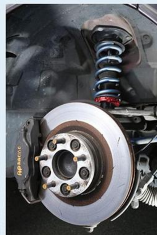
ネジ式車高調整のコニASAダンパーにフロントMAQS、リア戸田スプリングの組みあわせ。アップバーマウントはクスコ製だ。
