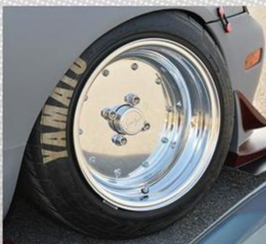
ホイールはスピードスター・マーク。14インチで前後とも9J(インセット10)のディープリム。185の引っ張りタイヤのツライチ仕様で圧巻だ。
