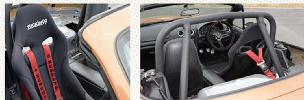
ロードスターでサーキットを走る際、ノーマル車両であってもロールケージの装着は必須。安全性だけでなく剛性アップの効果もある
