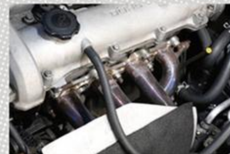
オートエクゼのタコ足を装着。4-2-1レイアウトで低中速トルクもしっかりと確保されているので扱いやすい。
