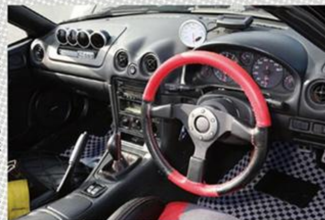
ステアリングとシートの赤がアクセントのインテリア。80℃タコのほか、水温、水温、排気温、油圧計がずらりと装着されている。
