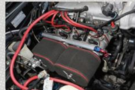
「いつかは！」と憧れているオーナーも多いのが4連スロットル方式のインジェクション。クォーンという吸気音も大きな魅力だ。
