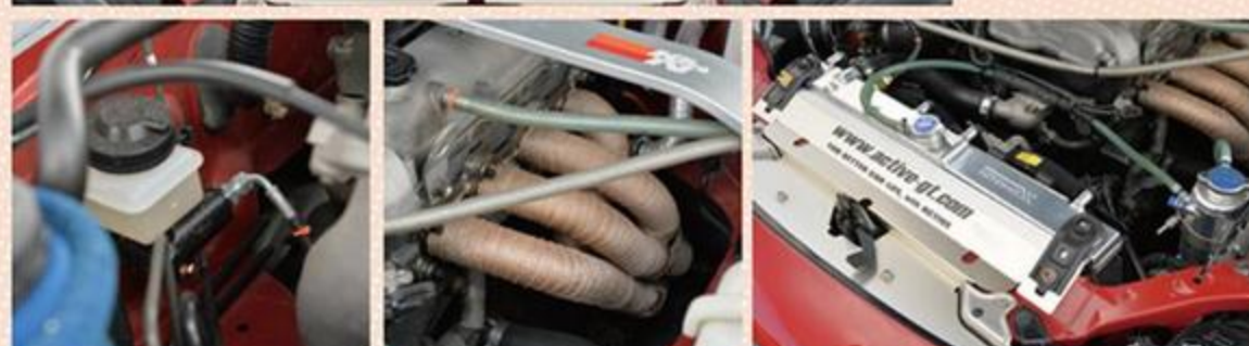
サーキットで酷使されるも10万kmノーマルメンテナンスのBP-VEエンジン。ラジエターのエア抜きブリーダーも備わっている。また、クラッチラインのダイレクト化も行われている。
