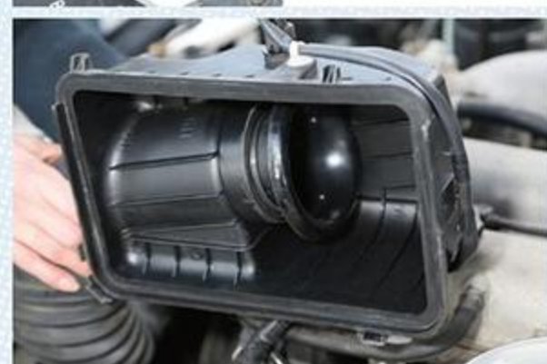
純正クリーナーボックスに装着するファンネルは、Nゼロレース用に開発したもので、低中速のレスポンスアップ効果を発揮する。
