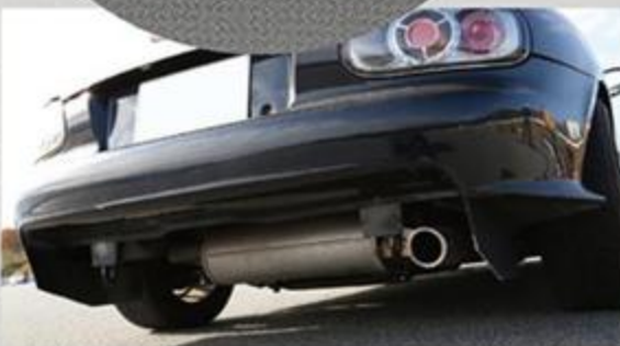
マフラーはNBターボの純正品を装着。172psに対応させるためにNAエンジン用よりも容量に余裕があるので、チューンドエンジンにベストマッチ。
