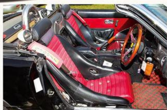
ナカマエ製作のシート+染めQで仕上げた内装。オープン時でもサウンドを楽しめるよう、スピーカーを別体で取り付けている。
