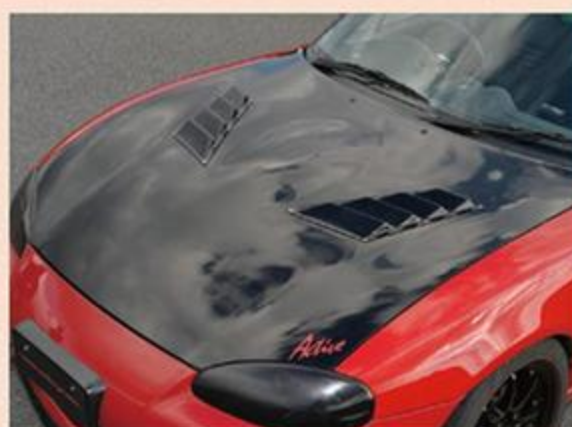
ボンネットはエンジンルーム内の熱を逃がすガレージベリ製アウトレットダクトを備えている。熱によるトラブルを未然に防ぎ、エンジンの能力を引き出す。
