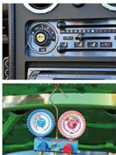
エアコンはガスの補充で一時的に治ることもあるが、思いきってキットで交換してやるのが後々安心だ。
