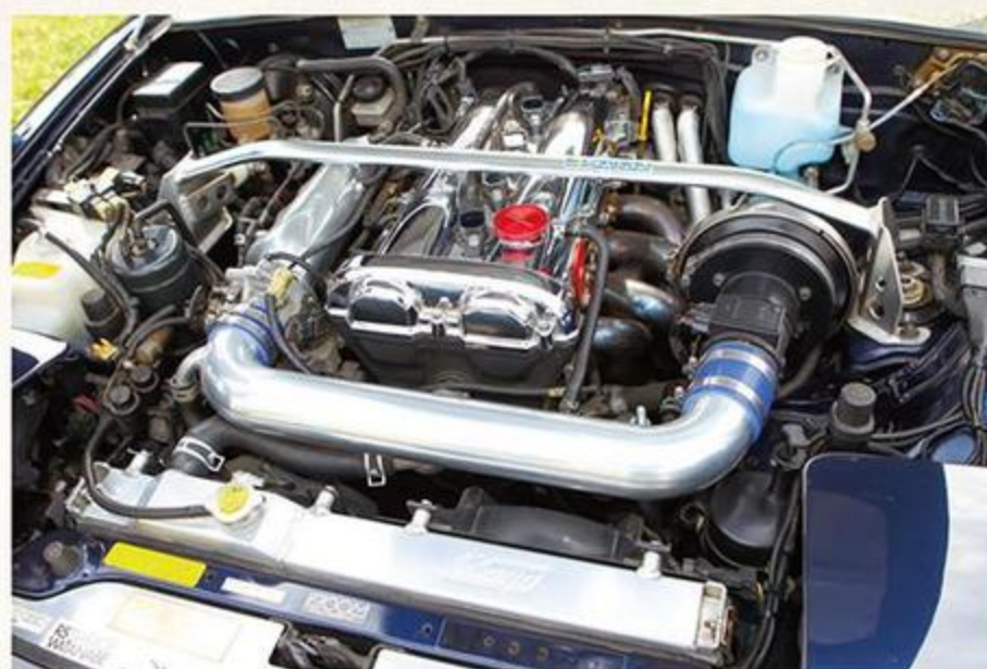
さすがにヘッドは業者に依頼したというが、タワーまでピッカピカ。イグニッションコイルは20プリウスのもので、ダイレクトイグニッションの配線は自分で行った。
