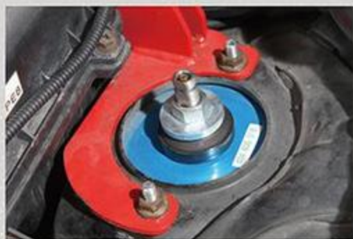
サスペンションはティンからクスコに交換した。サーキット、ストリートで減衰を調整する。タワーバーもクスコ。
