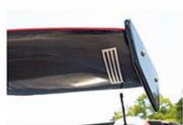
ウイング下部にはうわさの静 電気除去ステッカーが貼られ ていた。
