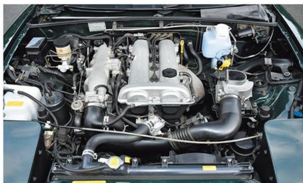
1.6ℓ直4DOHC(120)psを搭載。93年に1.8ℓの直4DOHC(130ps)に換装された。
