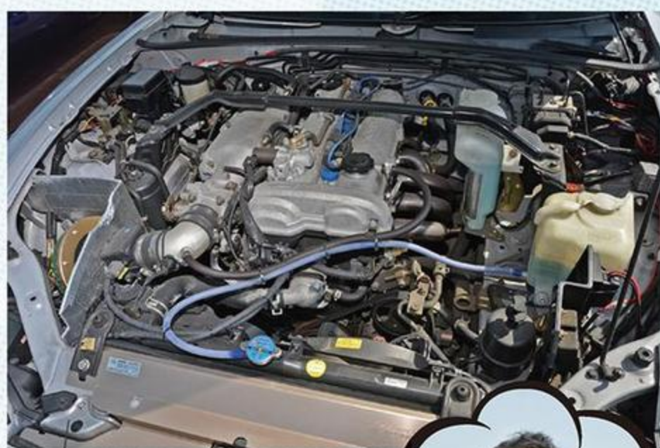
HKSのエアクリナーとマキシムワークスのエキマニを装着した以外は、基本的にノーマルのエンジンルーム。ボンネットは左右のワイヤーを外してから開ける。
