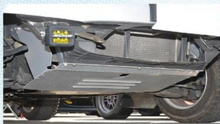
オフローダーっぽく仕上げるには小物にも工夫が見られる。アンダーカバーはレイル製ディフューザーにサイド部分を新設して取り付けられている。
