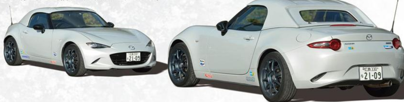
スパーククラフト製のハードトップは、重量12kgと超軽量なので走行フィールを損なわない点もうれしいところ。
