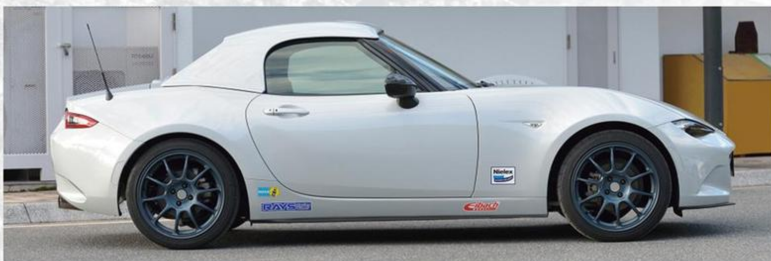
スパーククラフト製のハードトップは、重量12kgと超軽量なので走行フィールを損なわない点もうれしいところ。
