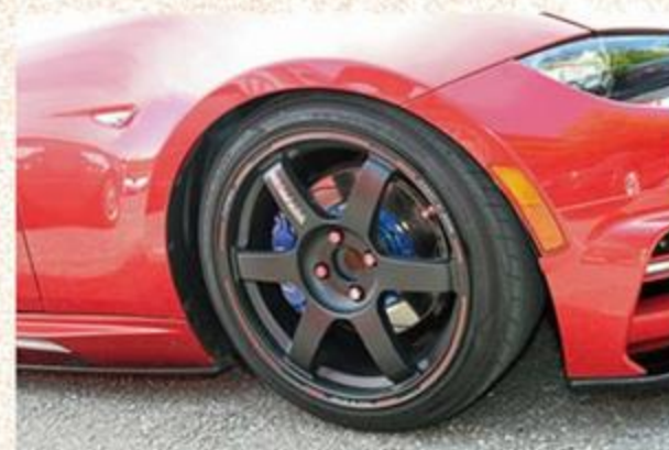
8.5JのレイズTE-37 SAGAから覗くキャリパー、ローター、パッドはエンドレスを装着。
