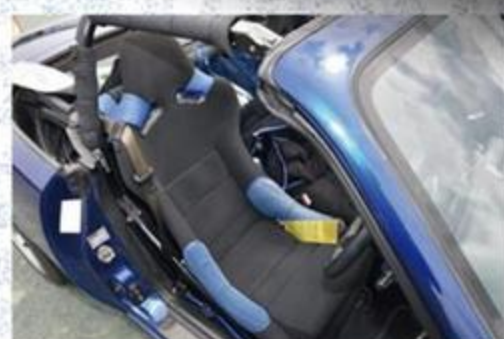
シートはもちろんフルバケット。競技では4点式だが、公道走行には3点式が必要だ。
