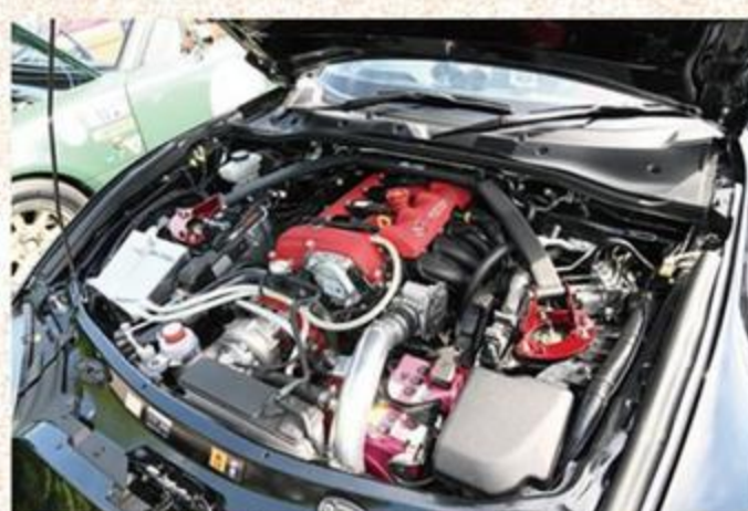
スーパーチャージャーはHKSキット 7040を装着し、ワンオフセッティ ングECUで制御。エンジン本体は 最後に手を入れる予定。
