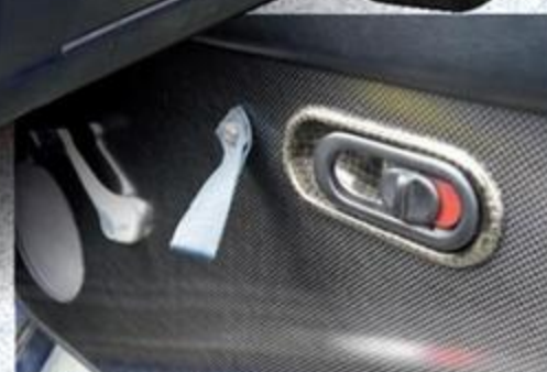
ご覧のようにドアパネルはWETカーボン。開閉は布製ストラップと徹底している。
