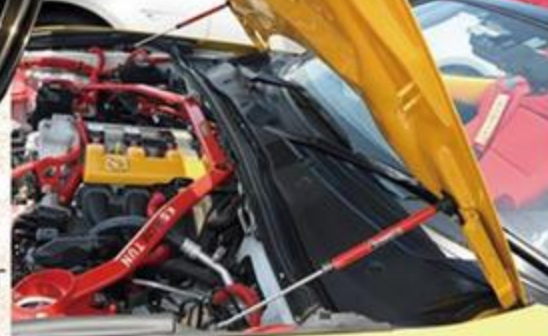
作業効率をアップさせるMAZPART のボンネットダンパー。
