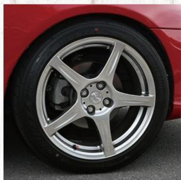
レーシングハート製の純正17インチホイールに装着するのは、205/45R17サイズのダンロップのディレッツァZⅢだ。
