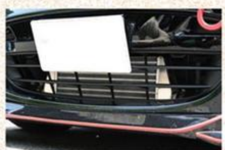
スーパーチャージャーはHKSキット 7040を装着し、ワンオフセッティ ングECUで制御。エンジン本体は 最後に手を入れる予定。
