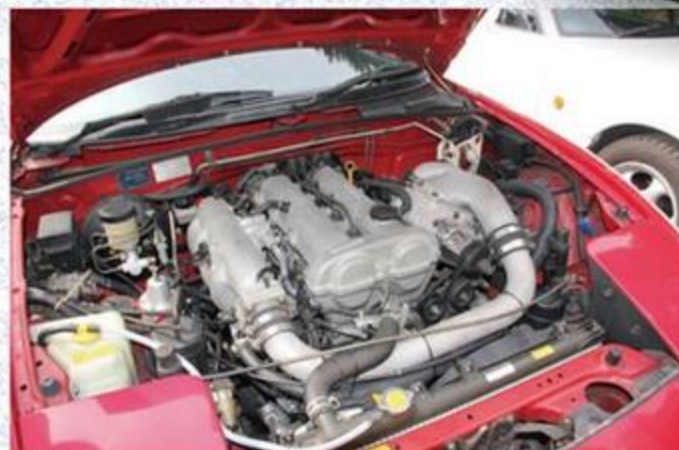
エンジンはマツダスピードのスーパーチャージャーがプラスされたBspecだ。ノーマルより50馬力アップをうたっていたキットだ。
