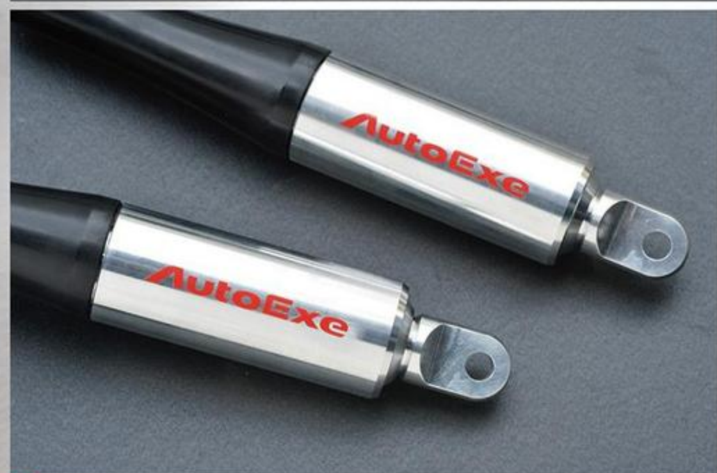
フロント(写真右)、リア(同左)ともに、バンパー内のフレーム部分に装着する。専用のブラケットにより、車両側を加工することなく装着できるボルトオン設計だ。現在NC用を開発中。
