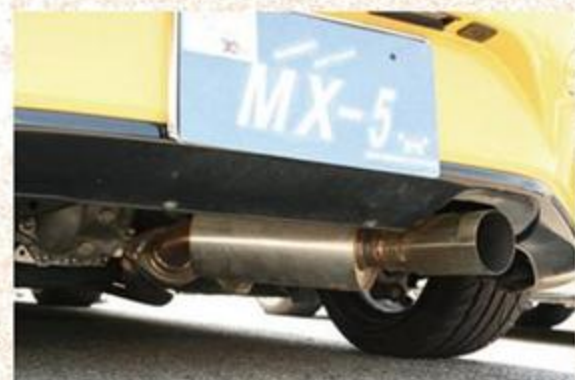
センターパイプ追加で 4000rpmからの伸び の良さと高音を強調。
