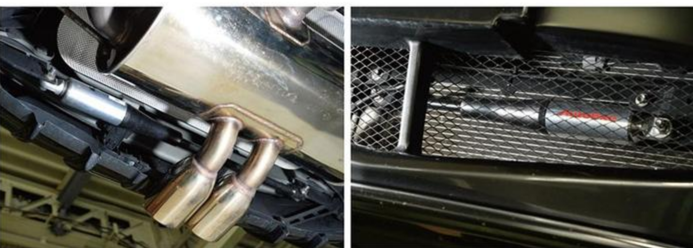
フロント(写真右)、リア(同左)ともに、バンパー内のフレーム部分に装着する。専用のブラケットにより、車両側を加工することなく装着できるボルトオン設計だ。現在NC用を開発中。
