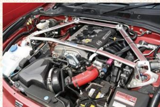
エンジンはノーマル、ジョイファーストECUでライトチューン。ブローバイガス対策にT-REVを装着した。
