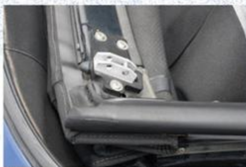
ハードトップが標準の1028をソフトトップに変更するキットのヒンジ部。
