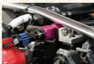
エンジンはノーマル、ジョイファーストECUでライトチューン。ブローバイガス対策にT-REVを装着した。
