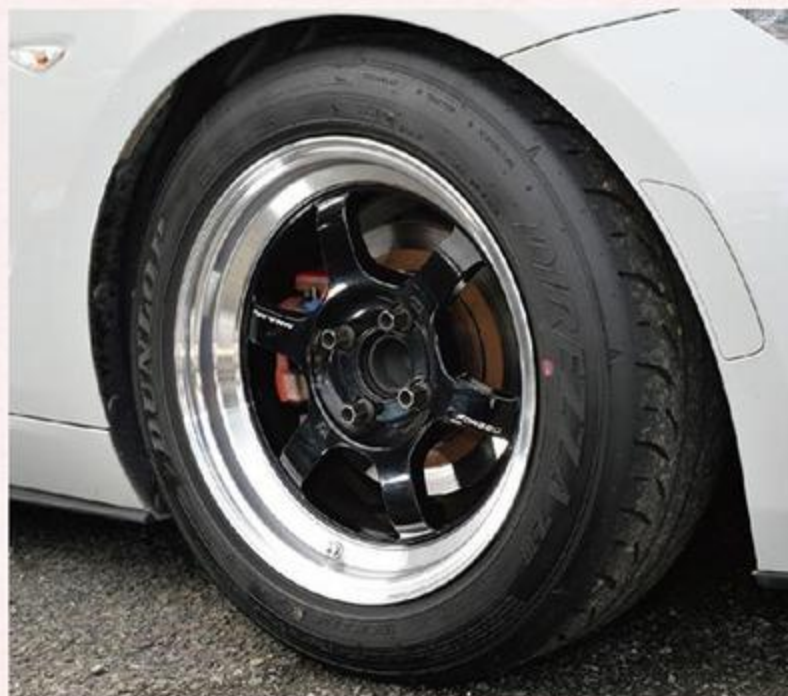
レイズのTE37V(7.5J×15)で足元をキメる。クスコの車高調を組み込みスポーツ走行を楽しんでいる。
